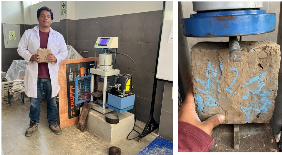
Figura 32: Ensayo a la tracción del mortero
