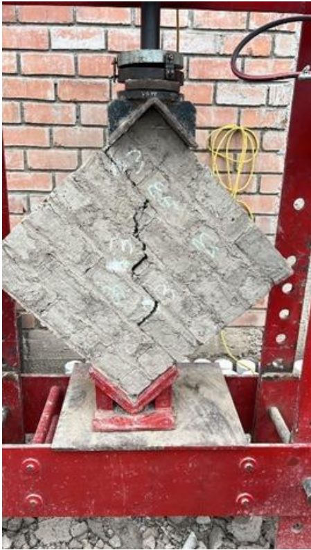
Anexo 68: Tipo de falla de murete
