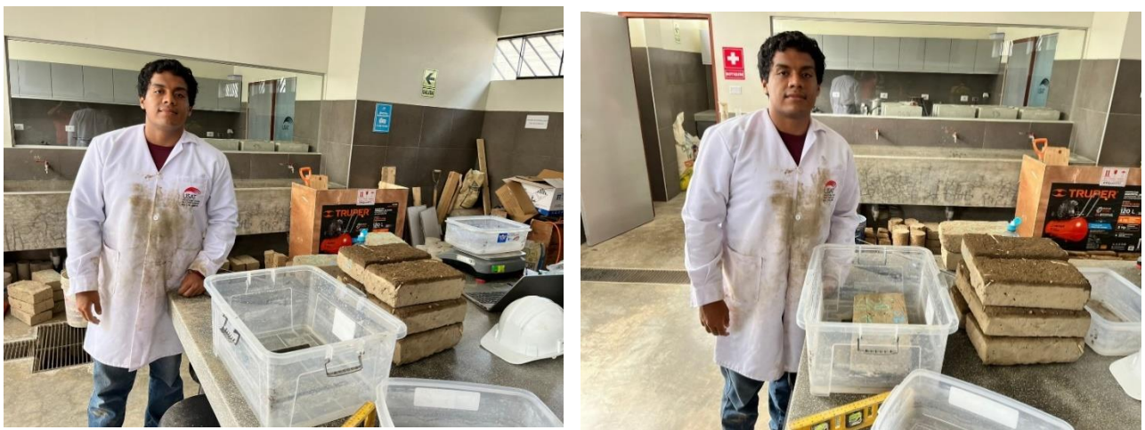
Figura 31: Ensayo de succión del adobe
