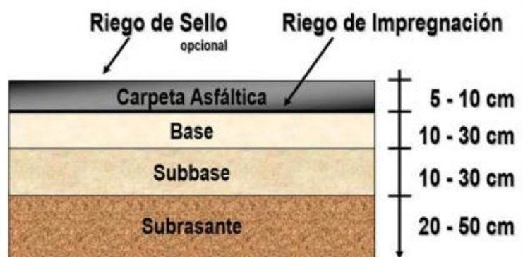
Ilustración 1: Estructura de un pavimento
