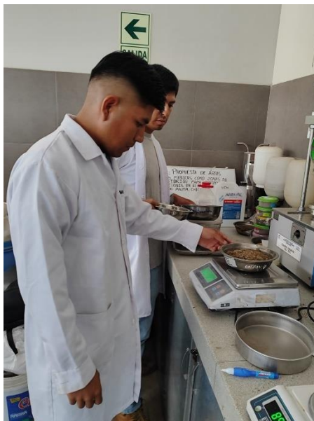
Figura 47: Ensayo de contenido de humedad
