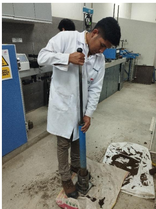
Figura 50: Ensayo de Proctor modificado de muestra patrón
