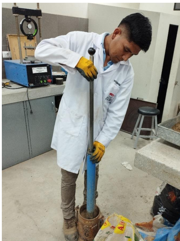
Figura 52: Ensayo de CBR – Muestra patrón
