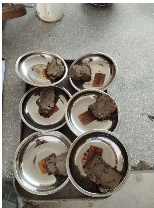
Figura 60: Ensayo de Límite de atterberg – Muestra patrón + HDPE
