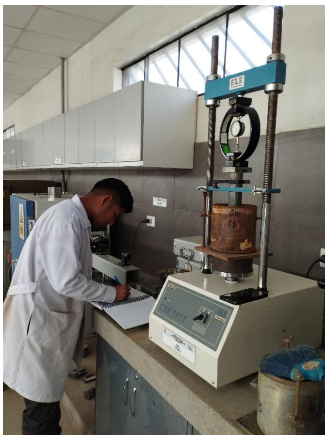
Figura 54: Ensayo de CBR – Muestra patrón
