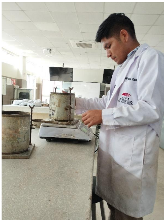
Figura 56: Ensayo de CBR – Muestra patrón
