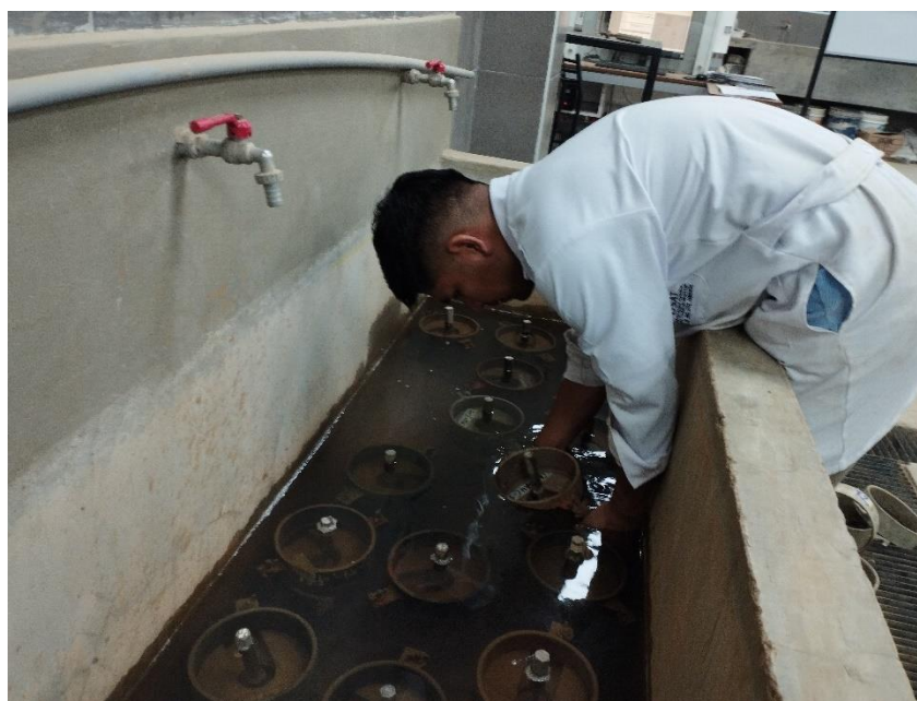
Figura 53: Ensayo de CBR – Muestra patrón
