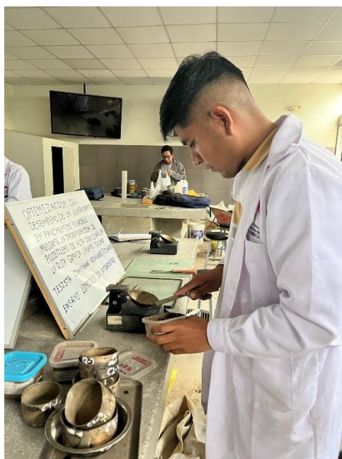
Figura 48: Ensayo de Limite de Atterberg de muestra patrón
