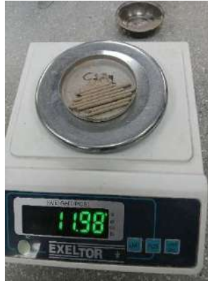
Figura 49. Realización de bastones para hallar el límite de plasticidad
