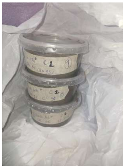
Figura 43. Muestras de la calicata 1 humedecidas por 24 hr
