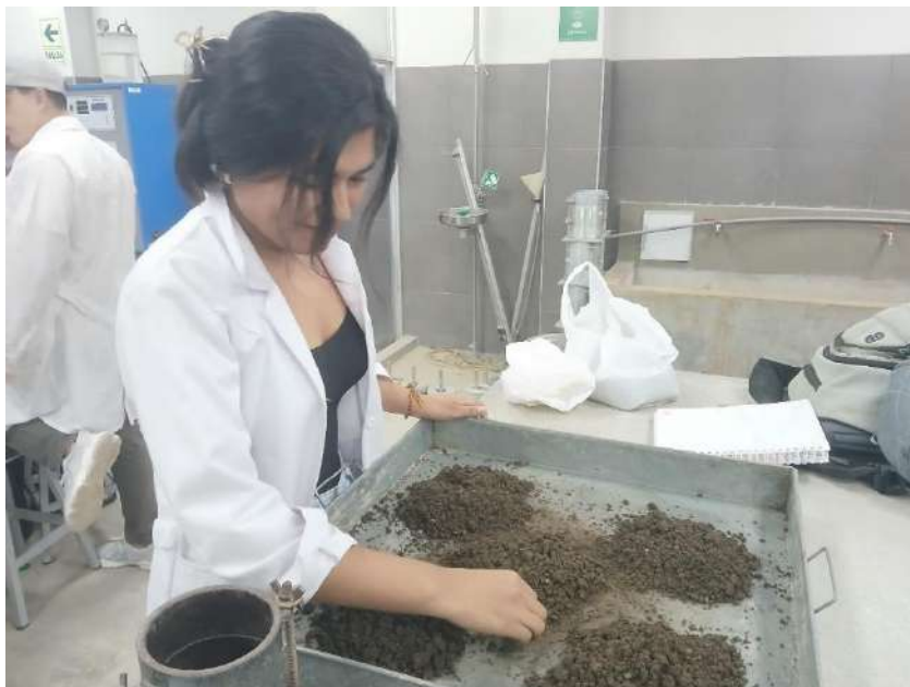
Figura 22. Autora separando la muestra en 5 partes de la calicata 2, porque se realizarán 25 golpes en 5 capas y estas capas deben ser homogéneas
