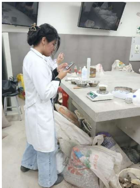
Figura 52. Pesado de las muestras antes y después de estar en el horno
