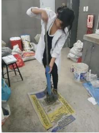
Figura 24. Compactando proctor de la calicata 1
