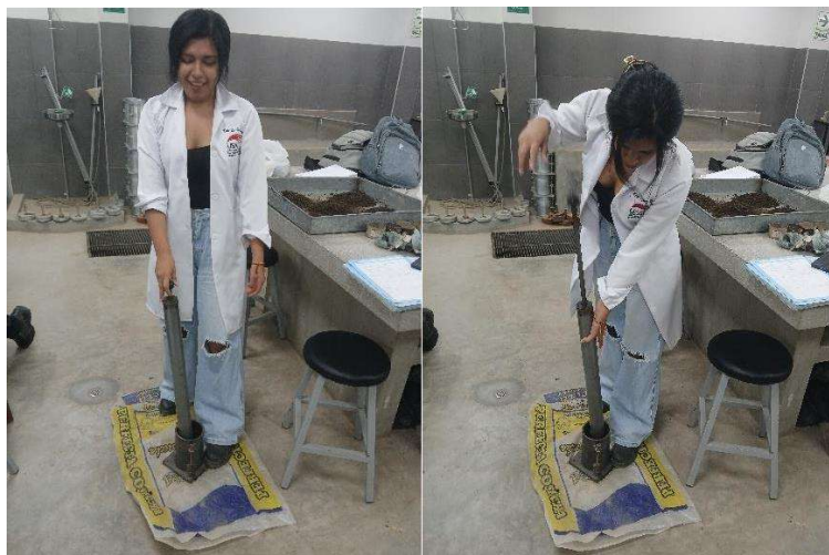
Figura 23. Compactando proctor de la calicata 2
