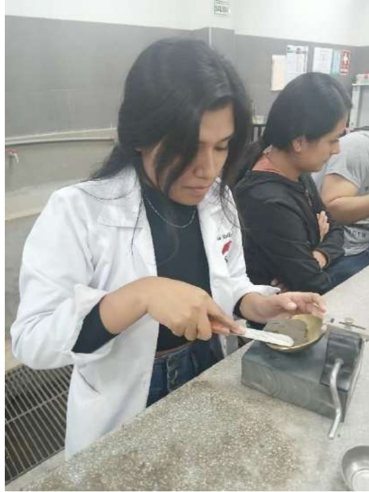
Figura 44. Tesista realizando el ensayo de Casagrande
