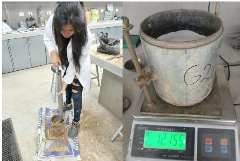
Figura 59. Compactado y pesado
