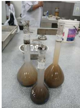
Figura 10. Fiolas con 50 g de tierra de cada calicata mezclada con el agua destilada en el segundo ensayo
