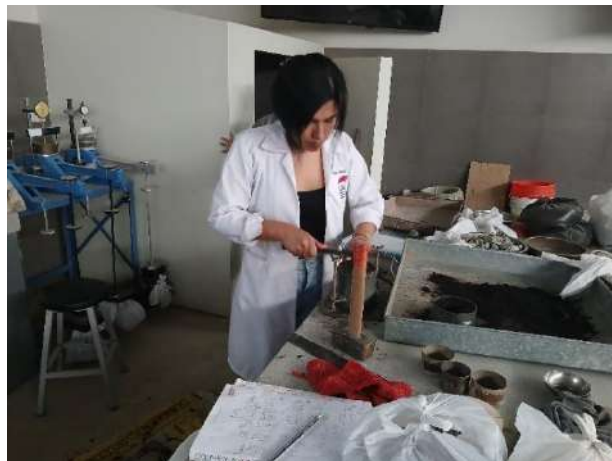
Figura 25. Autora enrazando su proctor de la calicata 3
