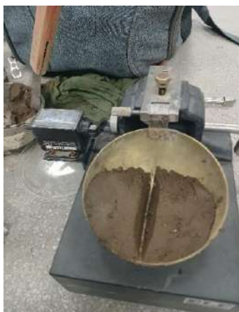
Figura 48. Realización de LL mediante el ensayo de la Casagrande
