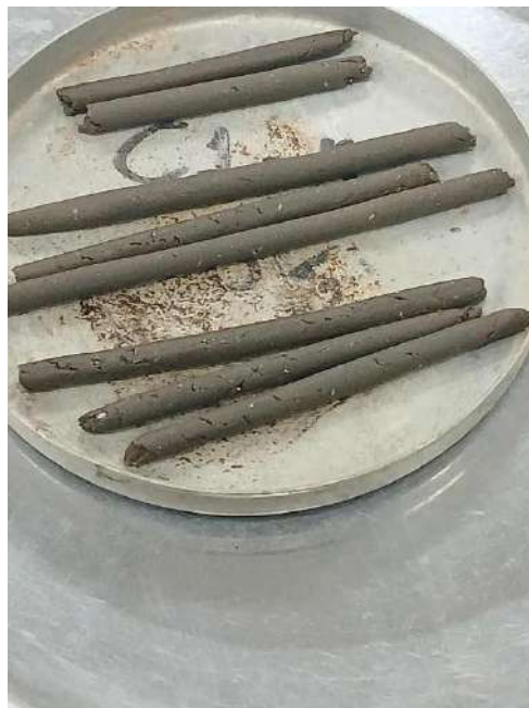
Figura 45. Realización de límite plástico de la calicata 1
