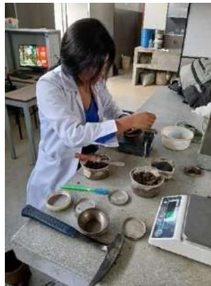
Figura 14. Autora realizando sus primeros ensayos de límites de las 3 calicatas
