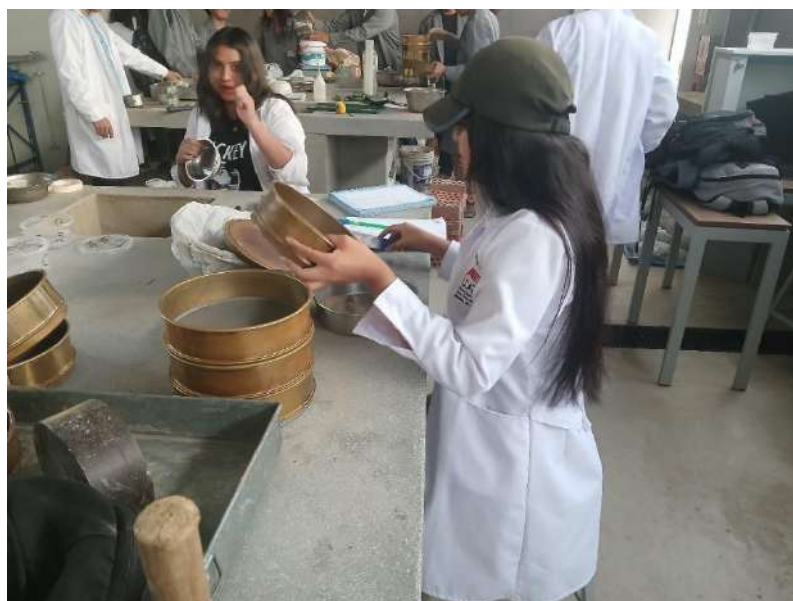
Figura 19. Tesista realizando su tamizado para granulometría
