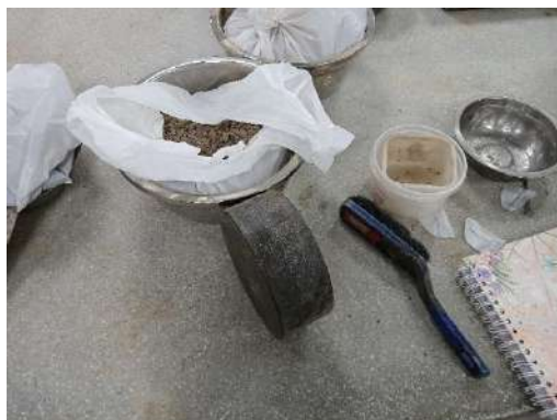
Figura 46. Calicata 2 molida y tamizada por la 40
