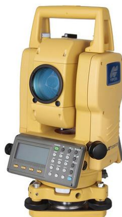
Figura 6: ESTACIÓN TOTAL TOPCON GTS-246NW
