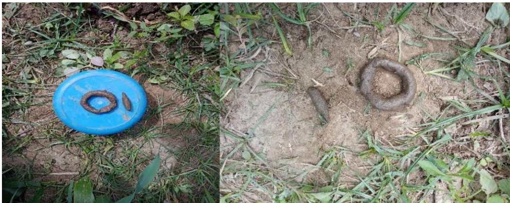
Figura 23. Prueba en campo para la determinación de textura de suelo
