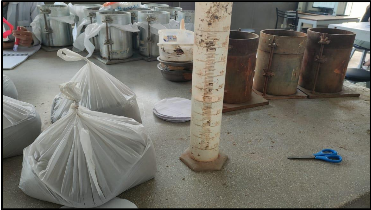
Figura 60. Saturación de muestra para CBR
