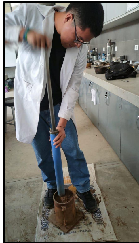
Figura 62. Golpes con martillo compactador para CBR
