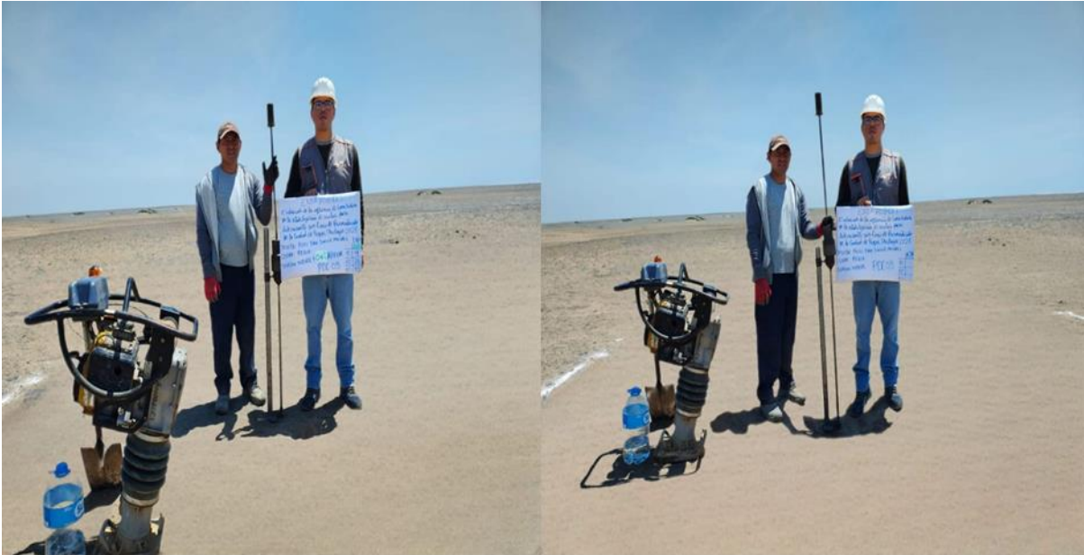
Figura 65. Ensayo penetración dinámica de cono (PDC) en terreno natural y con adición
