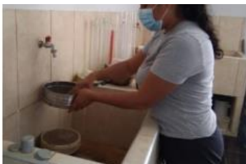
Ilustración 31. Lavado de muestras previo al ensayo de Granulometría
