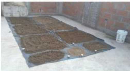
Ilustración 32. Secar las muestras previo a los ensayos respectivos.
