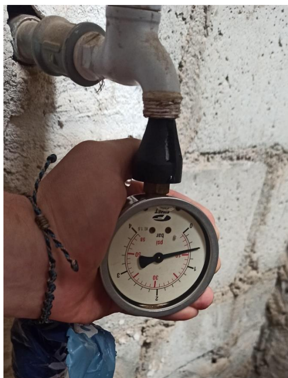
Fig. 68: Toma de Presiones en Campo con Manómetro.
