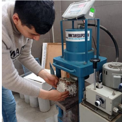
Ilustración 22, Colocación del espécimen para la aplicación de la carga
