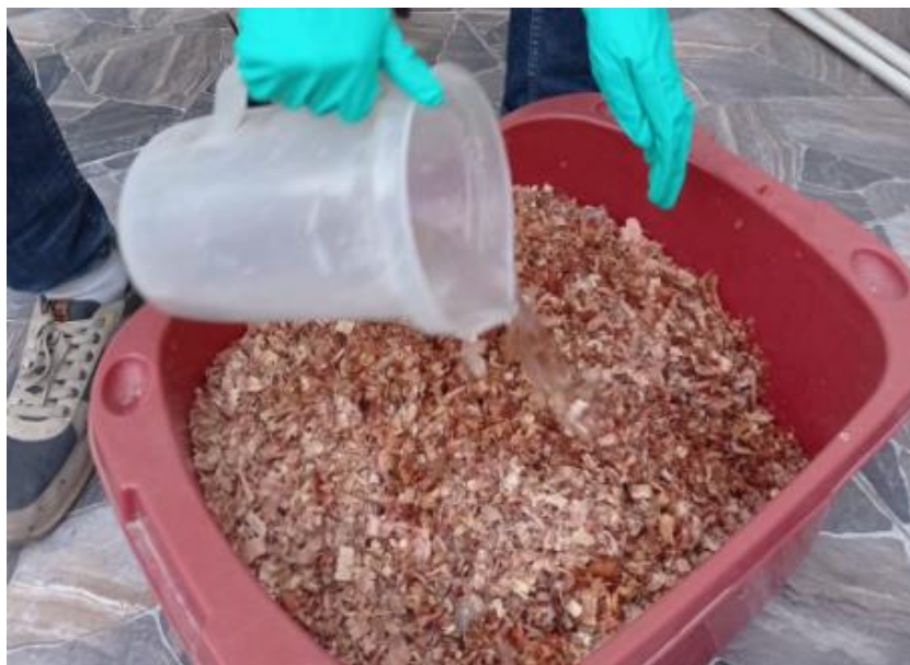
Ilustración 8, Colocación de agua para la humectación de la muestra
