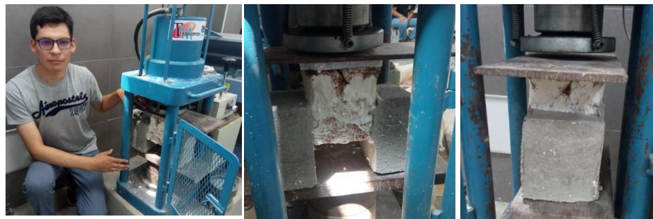
Ilustración 31, Prueba de adherencia
