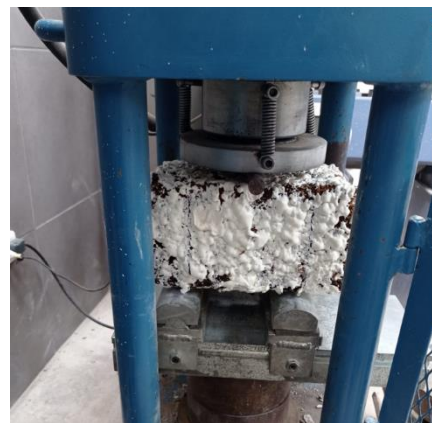
Ilustración 23, Ampliación de la carga en la parte central de la muestra
