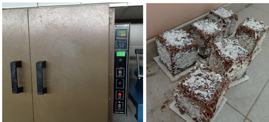
Ilustración 20, Bloques secados en horno a temperatura de 109 °C
