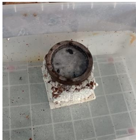
Ilustración 29, Muestra sumergida en agua por 24 horas
