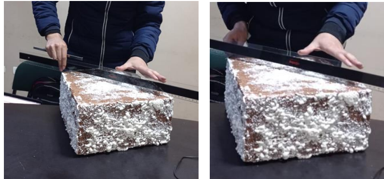
Ilustración 30, Ensayo de alabeo
