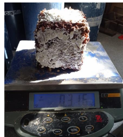
Ilustración 28, Pesado de la muestra después de ser sumergida
