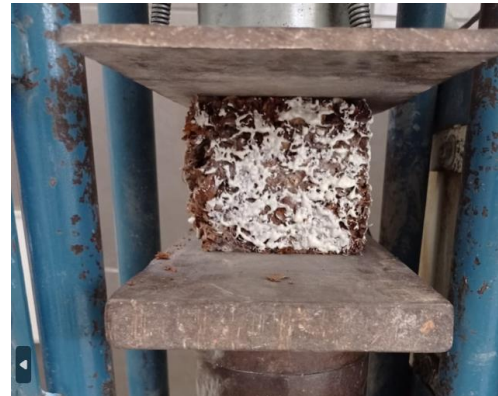
Ilustración 21, Falla del espécimen después de la aplicación de la carga
