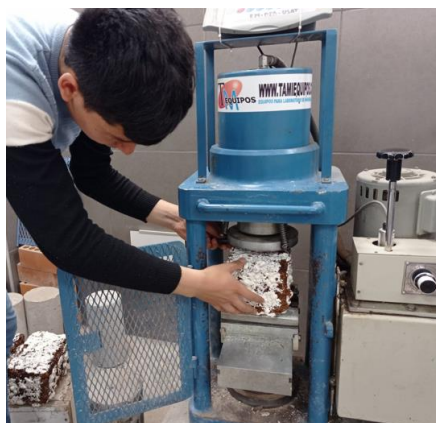
Ilustración 24, Colocación de la muestra para la aplicación de la carga
