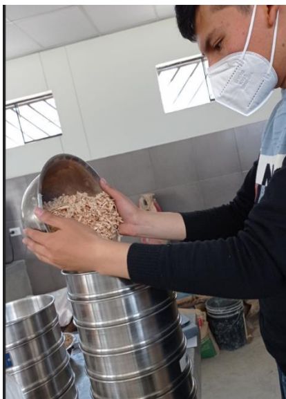
Ilustración 10, Tamizado de una de las muestras de aserrín
