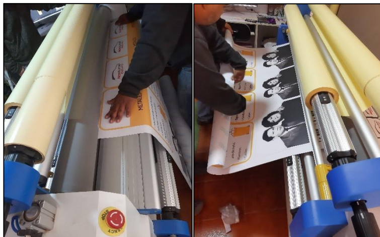
Figura 16. Laminado del vinil impreso.
