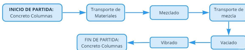
Figura 44: Diagrama de Flujo de la partida Concreto Columnas
