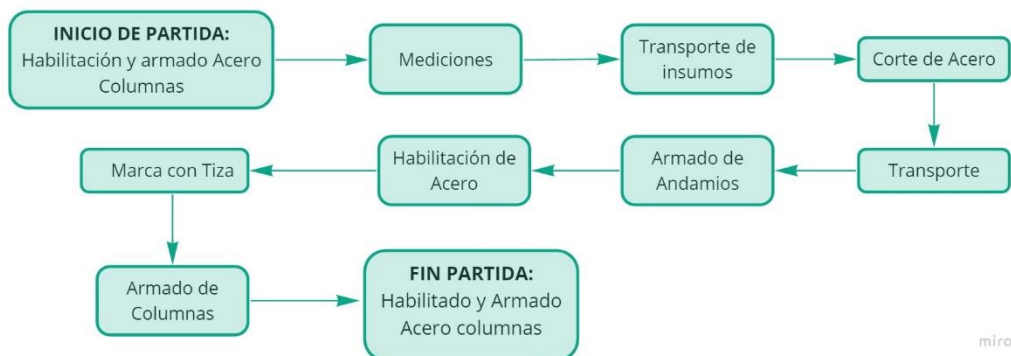
Figura 89: Diagrama de Flujo de la partida de Habilitado y armado de acero Columna
