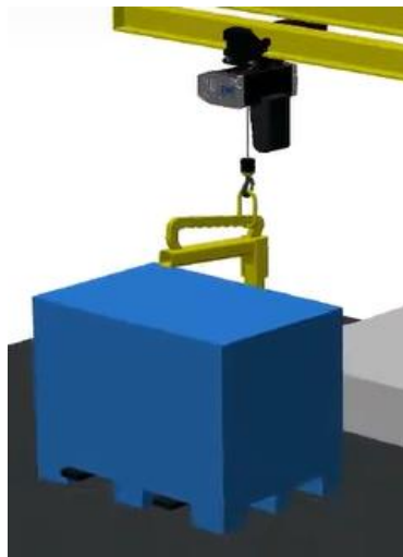
Figura 11. Grúa puente con horquilla para pallets.
