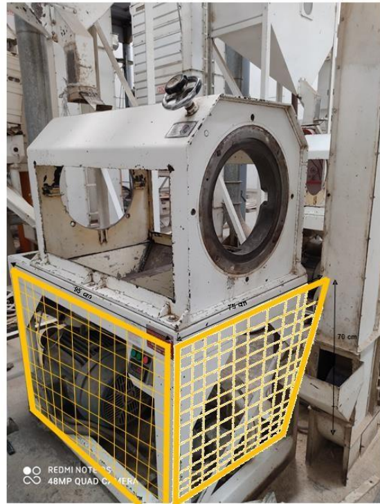
Pulidora con la guarda de seguridad desmontable.
