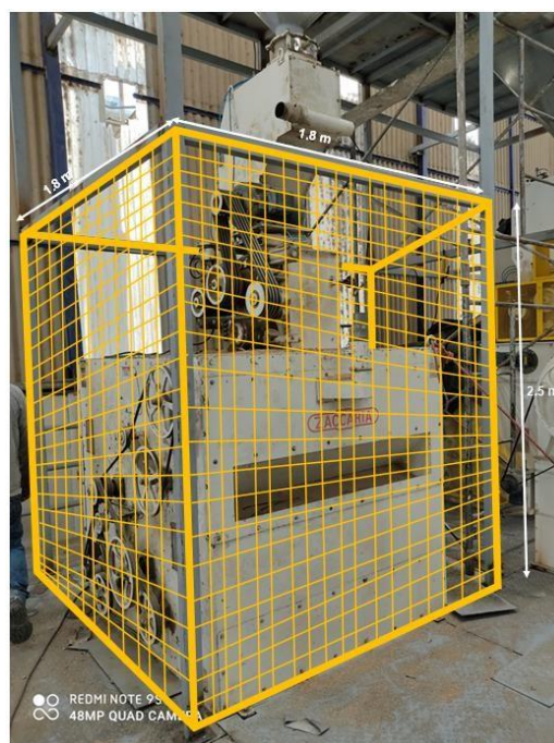
Descascaradora de arroz con la guarda de seguridad desmontable.
