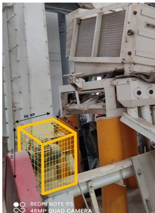
Mesa Paddy con la guarda de seguridad desmontable.
