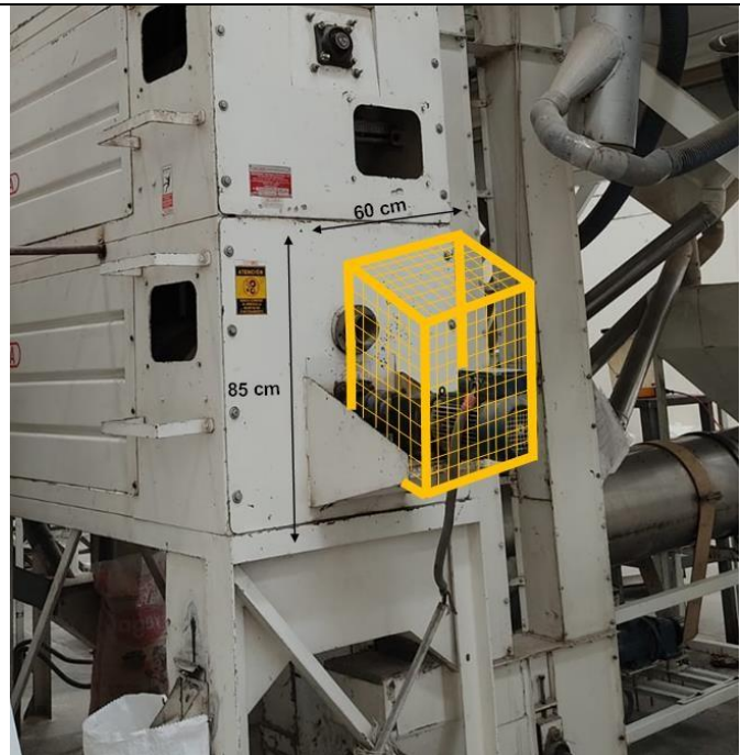
Pulidora con la guarda de seguridad desmontable.
