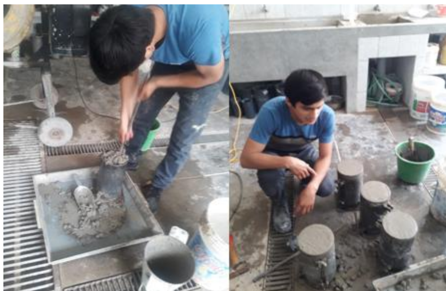
Figura 18. Elaboración y curado de probetas cilíndricas
