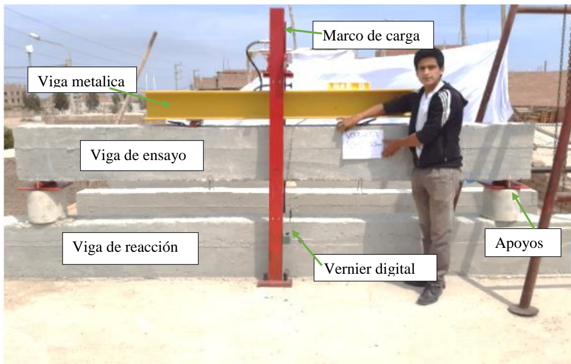
Figura 25. Sistema ensamblado de ensayo a flexión de vigas
