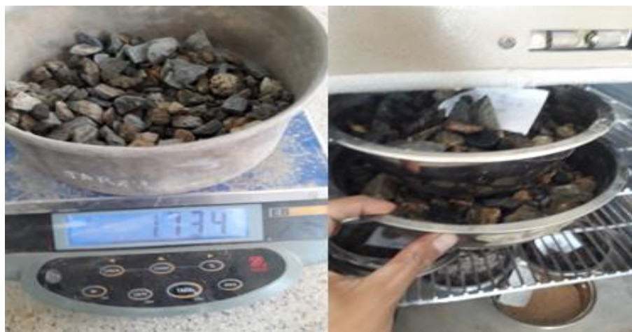
Figura 13. Grado de absorción del agregado grueso
