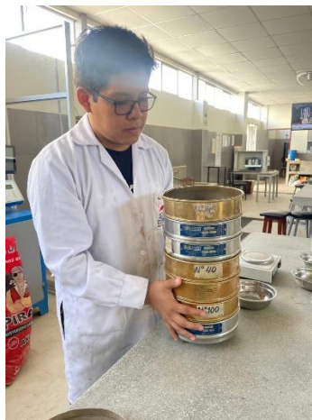
Ilustración N°37. Tamizado de muestra de Suelo Seco; p/ensayo gran. por tamizado
