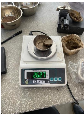
Ilustracion N°49. Muestra para medir el contenido de humedad, p/ ensayo de Lim. Liq.
