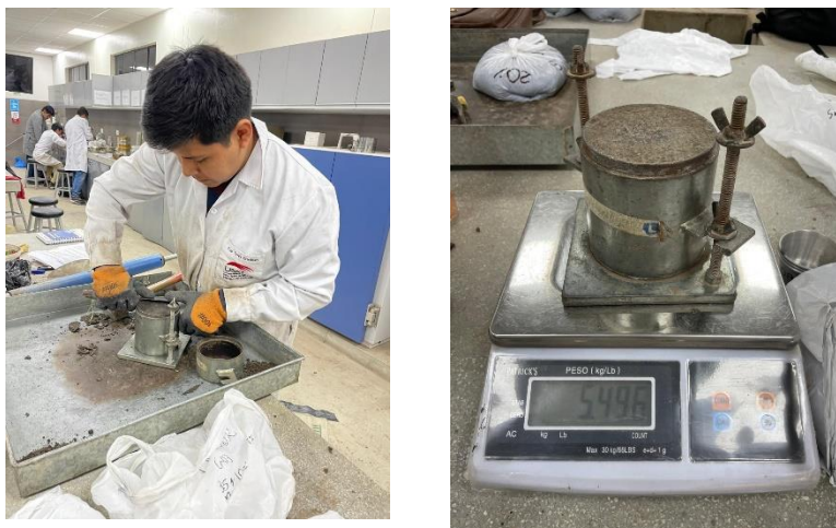
Ilustración N°56. Enrasado y determinación del peso de suelo compactado
