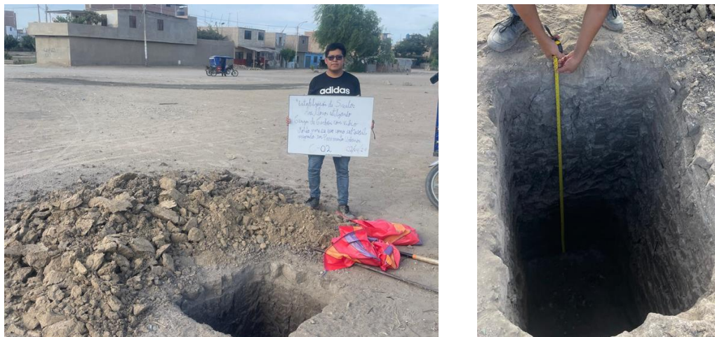
Figura 8: Extracción de muestra de suelo de calicata N°3
