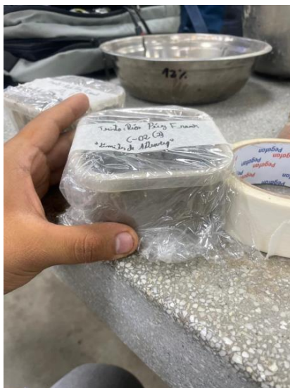
Ilustracion N°43. Reposo de mezcla por 24h, p/ ensayo de Limite Liquido
