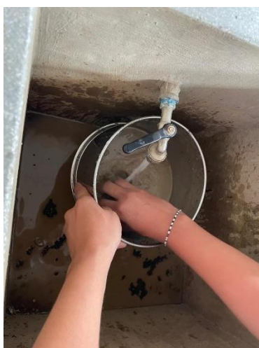
Ilustracion N°33. Lavado de muestra por el tamiz N°200; p/ensayo gran. por tamizado
