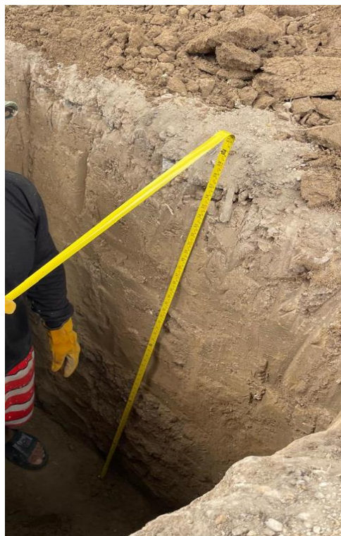
Excavacion de la Calicata N°02: la calle Antenor Orrego y 22 de febrero
