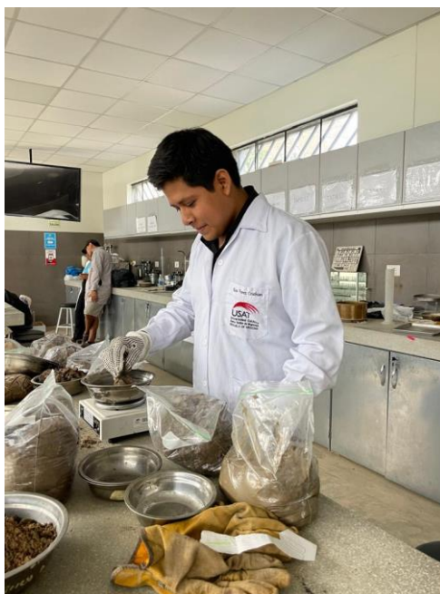
Ilustracion N°26. Peso de Tara + Suelo Húmedo
