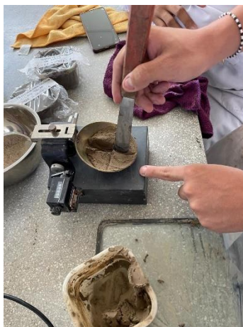
Ilustracion N°49. Muestra para medir el contenido de humedad, p/ ensayo de Lim. Liq.
