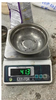
Ilustracion N°30. Peso de Tara; p/ensayo granulométrico por tamizado
