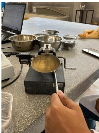
Ilustracion N°44. Verificacion de altura de 1cm, p/ ensayo de Limite Liquido
