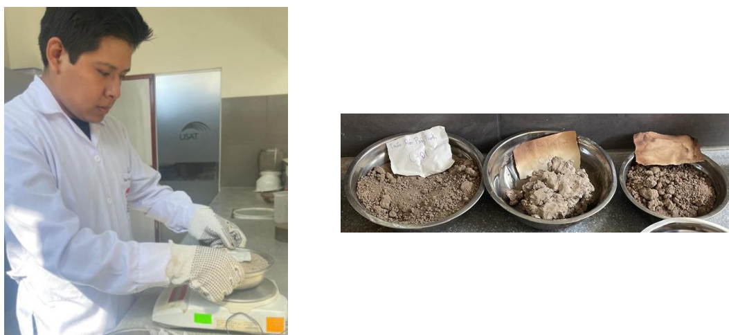
Ilustración N°28. Peso de Tara + Suelo seco
