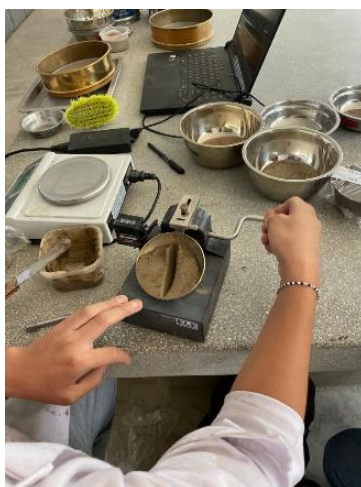
Ilustracion N°47. Conteo de golpes, p/ ensayo de Limite Liquido
