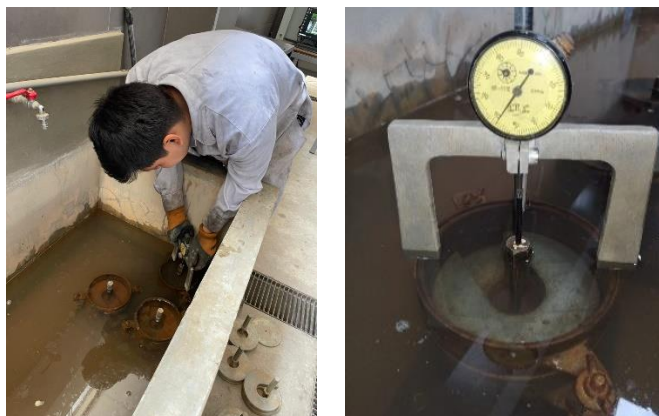
Ilustración N°62. Inmersión de moldes cada 24h p/ 4días y medición de Hinchamiento
