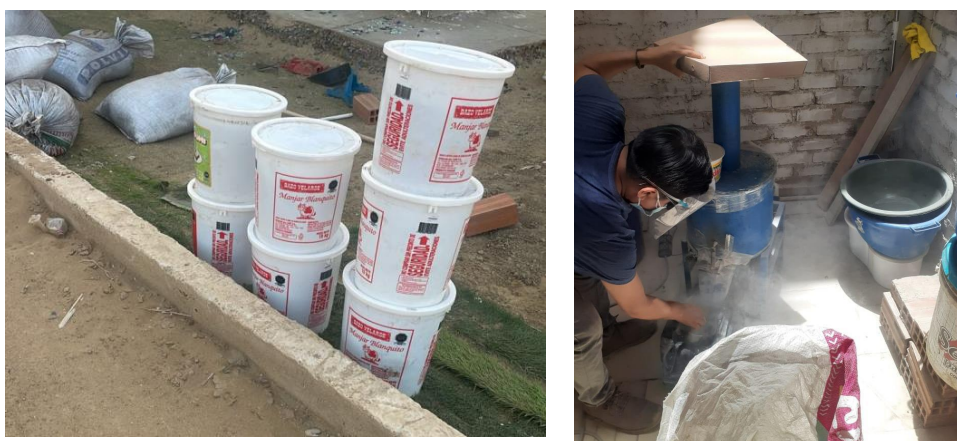
Ilustracion N°21. Triturado de vidrio usando molino artesanal eléctrico
