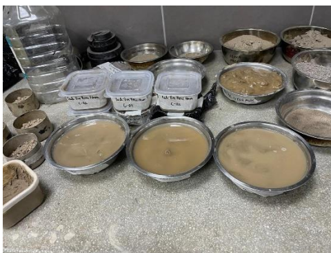
Ilustracion N°32. Reposo de muestra con agua a 24h; p/ensayo gran. por tamizado
