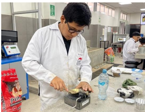
Ilustracion N°45. Emparejamiento de la pasta, p/ ensayo de Limite Liquido
