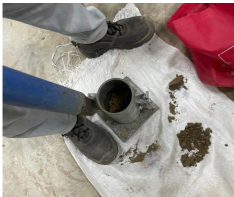
Ilustración N°55. Compactación de capas con martillo de 4.5kg
