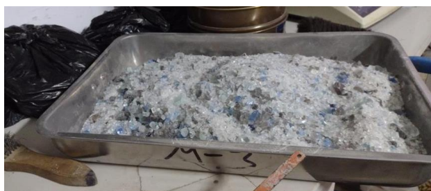
Ilustracion N°22. Vidrio triturado por primera vez con molino artesanal eléctrico
