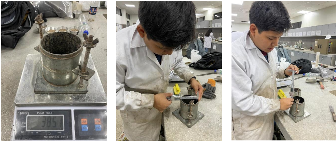
Ilustración N°54. Peso, medición con vernier de diámetro y altura de molde
