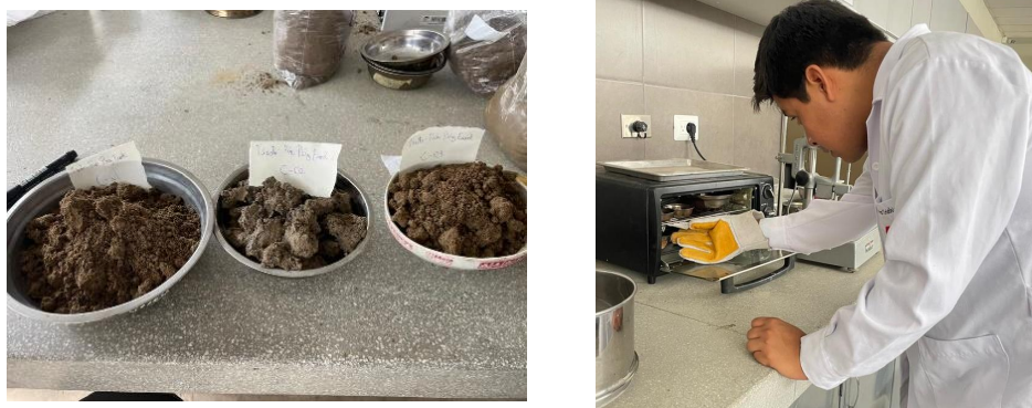
Ilustración N°27. Colocación de muestras a horno a 110\pm 5^{\circ}\text{C}
