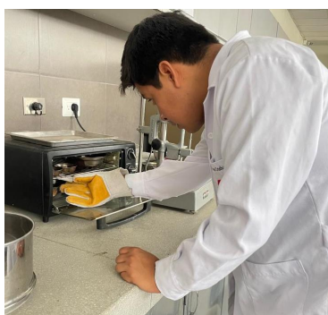
Ilustracion N°52. Muestras puestas al horno por 24h, p/ ensayo de Limite Plástico
