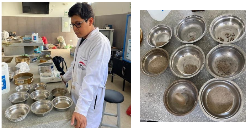
Ilustración N°38. Muestras retenidas en cada tamiz; p/ensayo gran. por tamizado
