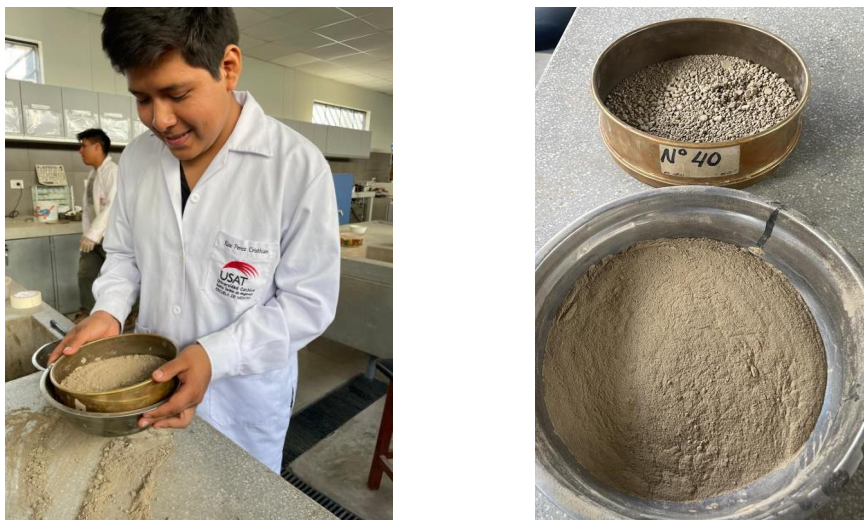
Ilustracion N°41. Proceso de tamizado por el tamiz N°40, p/ ensayo de Limite Liquido
