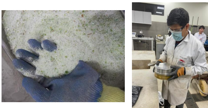
Ilustracion N°23. Vidrio triturado por segunda vez y tamizado por la malla #50
