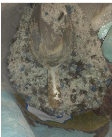
Ilustración N°20. Residuos de vidrio reducidos manualmente en tamaños - 2 a 3 pulgadas
