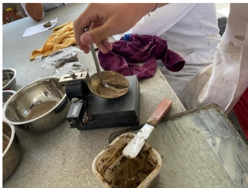
Ilustracion N°46. Separación de masa con ranuradora, p/ ensayo de Limite Liquido
