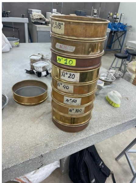
Ilustración N°36. Orden de tamices de mayor a menor; p/ensayo gran. por tamizado
