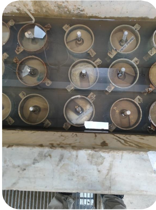
Ilustración 38: Moldes compactados en saturación 4 días.
