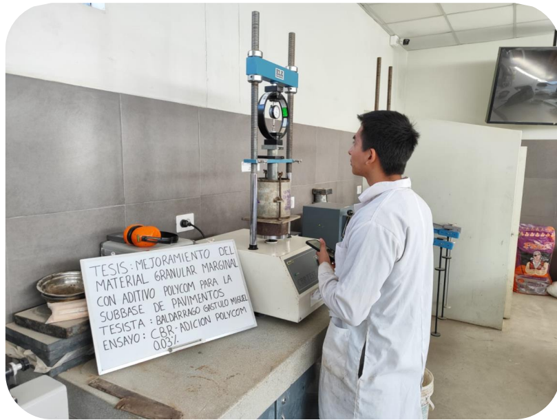
Ilustración 54: Registro de penetración muestra con aditivo Polycom.
