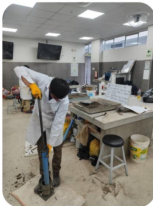
Ilustración 34: Penetración en 5 capas.
