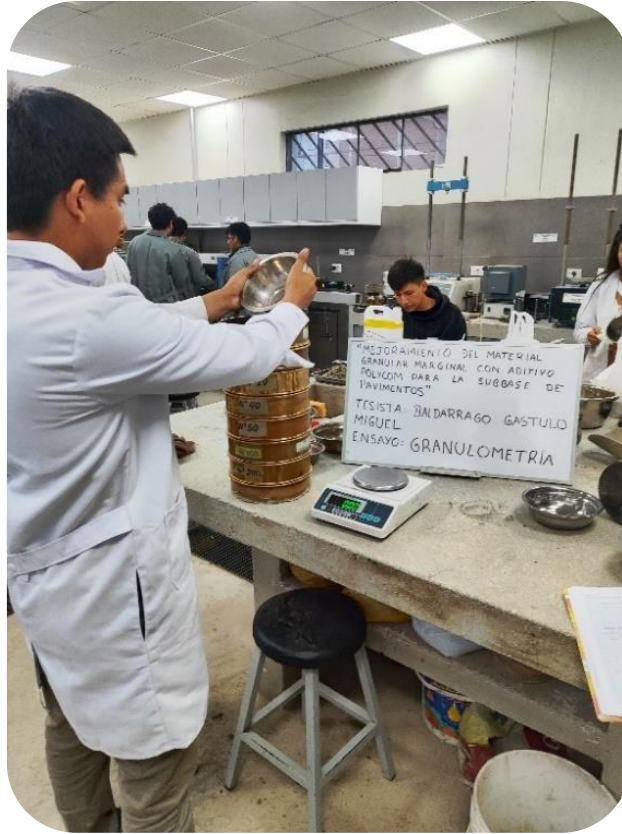
Anexo 13.: Determinación del peso retenido en cada tamiz.
