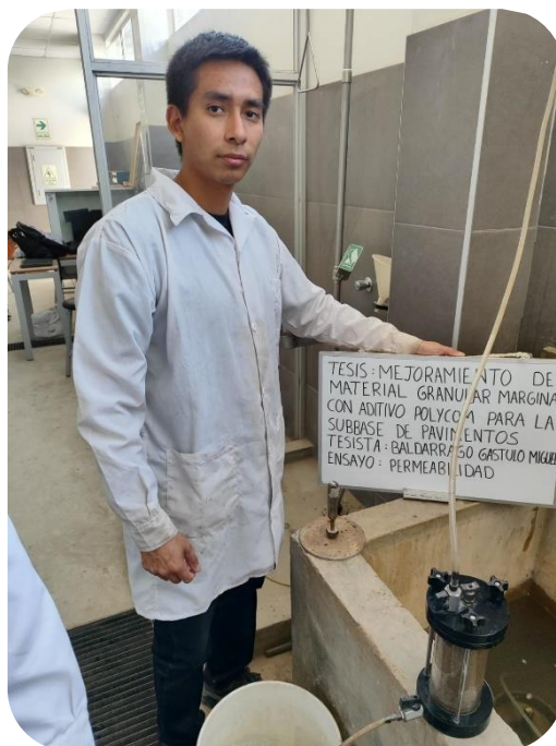
Ilustración 31: Aplicación de un nivel constante de carga hidráulica.
