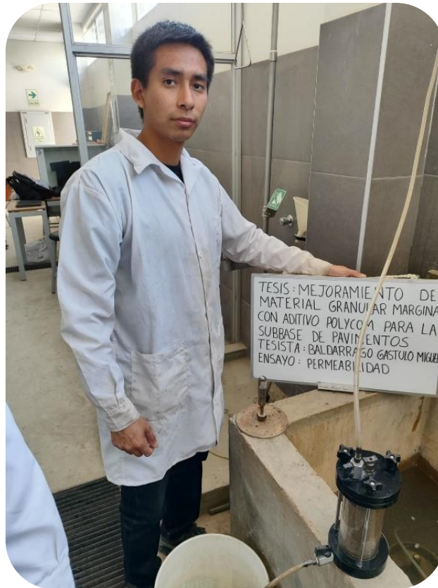
Anexo 23. Aplicación de un nivel constante de carga hidráulica.
