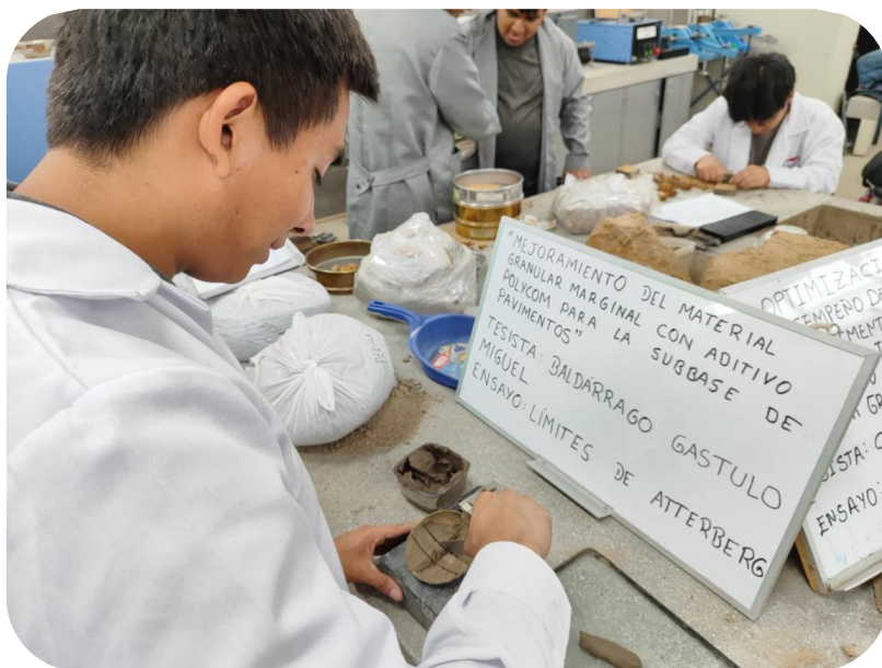
Ilustración 23: Uso de la copa de Casagrande.
