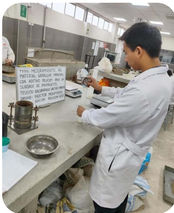
Ilustración 49: Adición de aditivo Polycom + agua.
