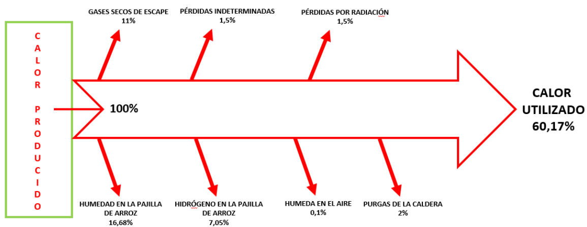
Figura 16 Balance Térmico de la caldera
