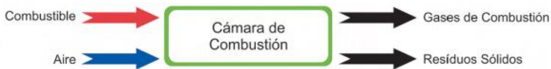
Figura 1 Funcionamiento de la caldera
