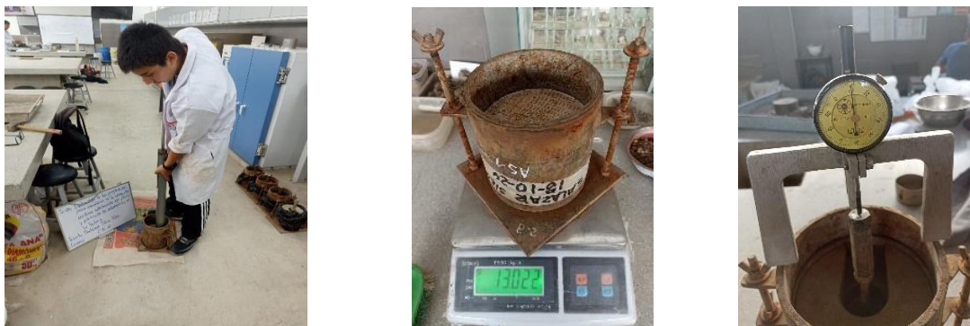
Fig. 11 Ensayo de C.B.R. - Fuente: Propia
