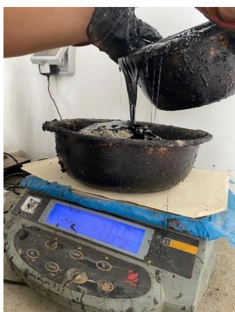
Ilustración 49: Adición de cemento asfáltico
