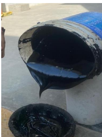
Ilustración 46: Extracción del cemento asfáltico
