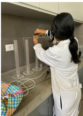
Ilustración 35: Adición de muestra fina humedecida
