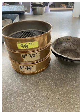
Ilustración 17: Tamices normalizados utilizados
