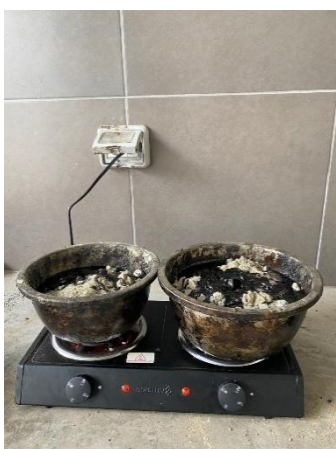
Ilustración 52: Cocinado de mezcla asfáltica
