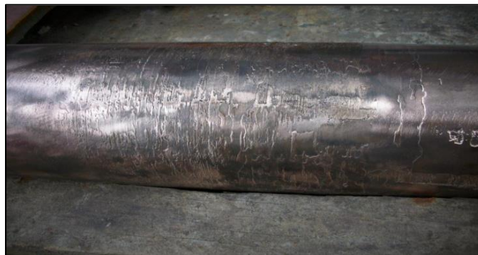
Figura 10 Deformaciones del eje Propulsivo
