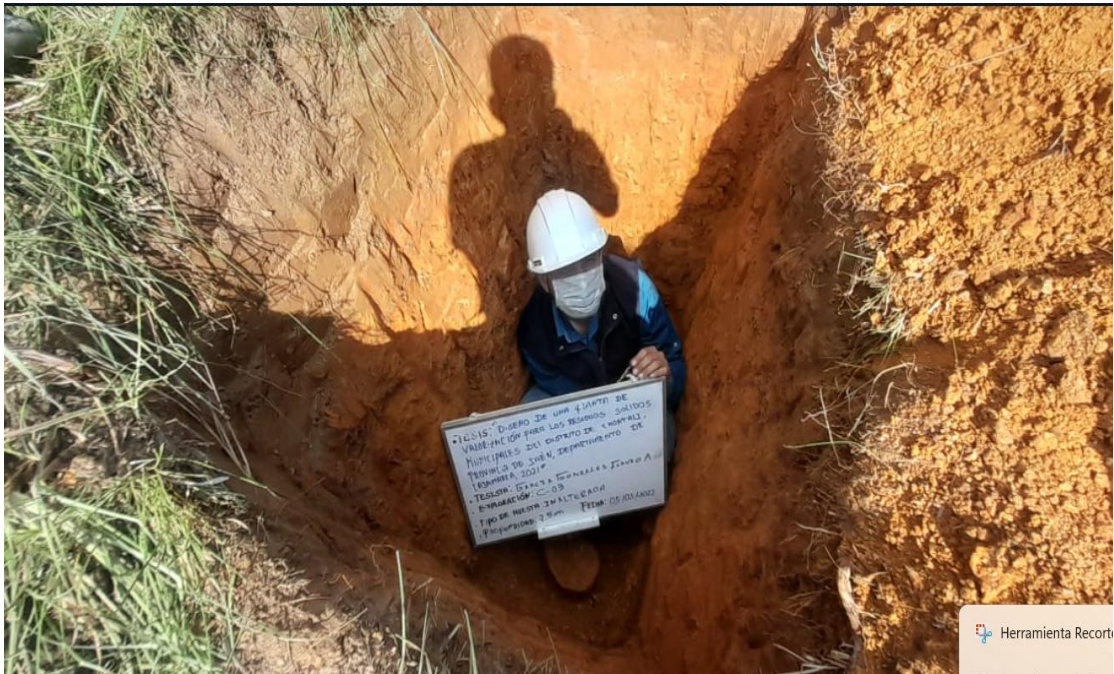
Foto N°10: Calicata N°3 – Estudio de mecánica de suelos.
