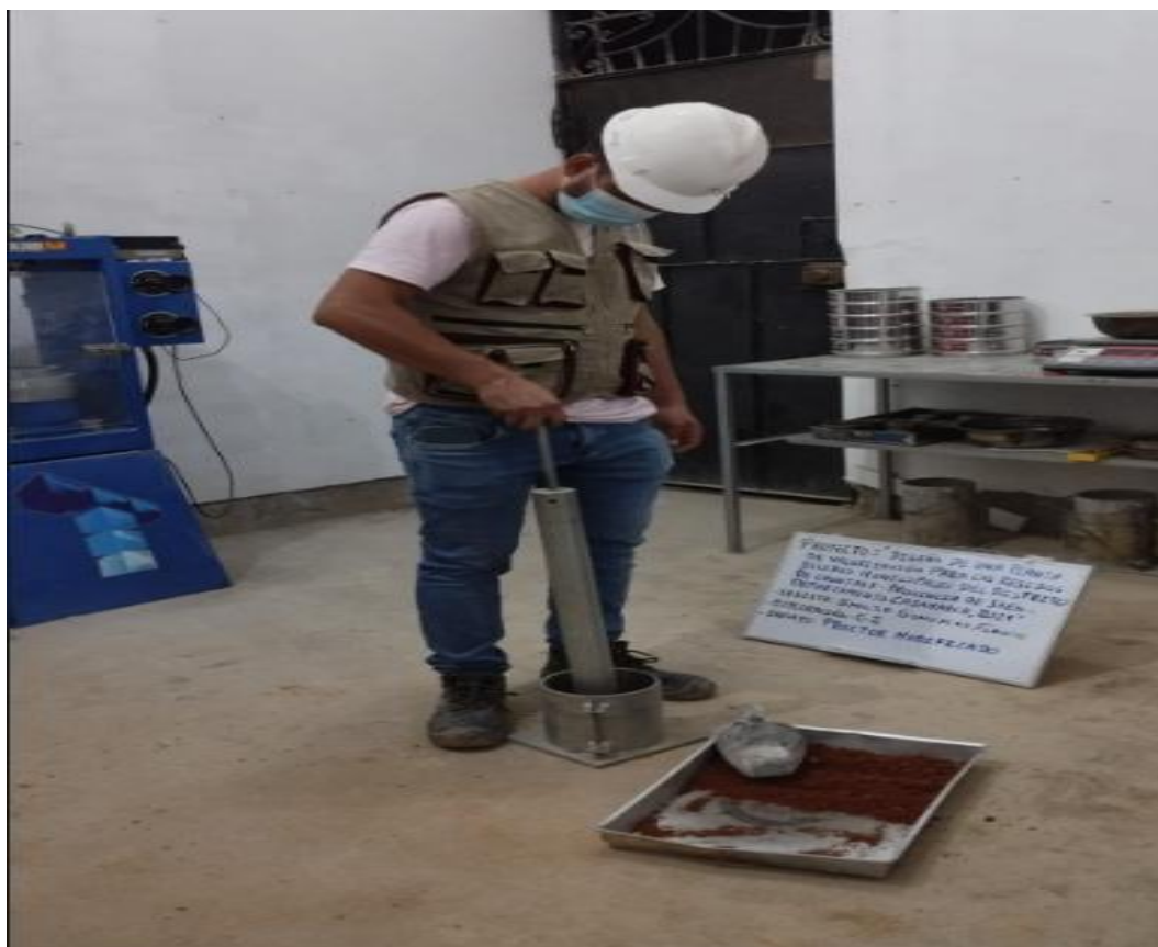
Foto N°15: Ensayo de Proctor modificado – Estudio de mecánica de suelos.
