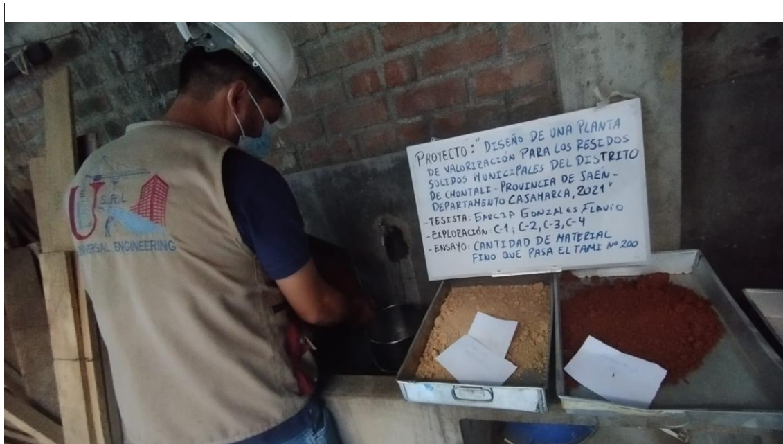
Foto N°11: Contenido de humedad que paso el tamiz # 200 – Estudio de mecánica de suelos.
