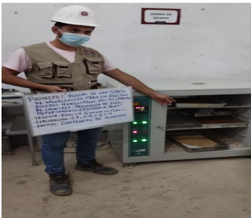
Foto N°14: Contenido de humedad – Estudio de mecánica de suelos.
