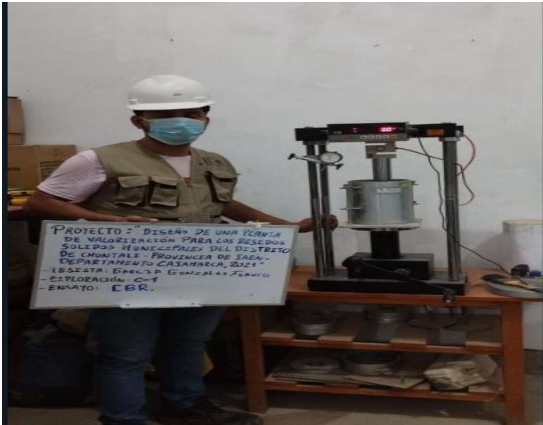
Foto N°11: Ensayo de CBR – Estudio de mecánica de suelos.
