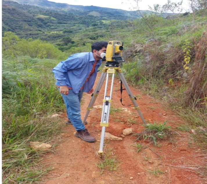
Imagen 5: Equipo Estacion Total
