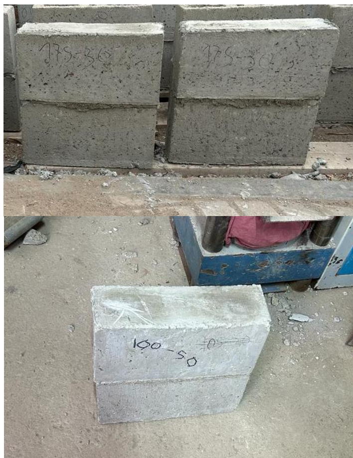
Prismas de albañilería
