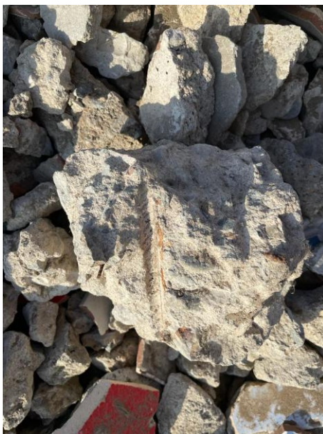
Ilustración 10: Concreto separado del acero corrugado
