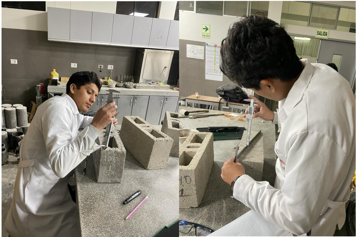
Ilustración 104: Medición para determinar el ensayo de alabeo
