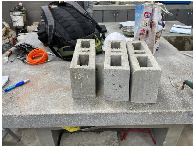
Ilustración 102: Bloque patrón de f'c= 100\text{kg/cm}^2
