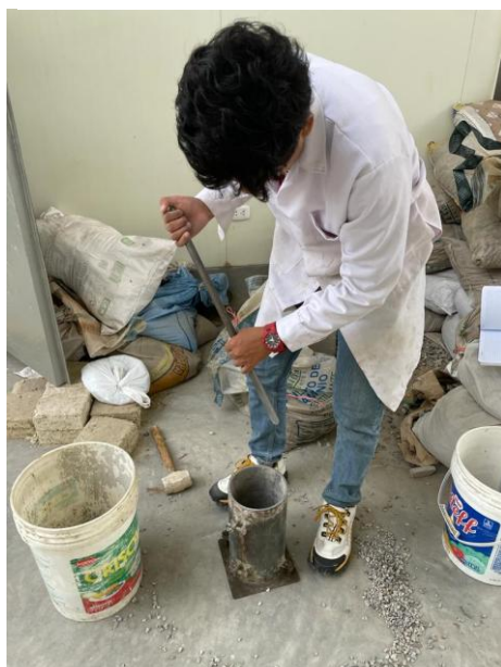
Ilustración 45: Apisonado del agregado
