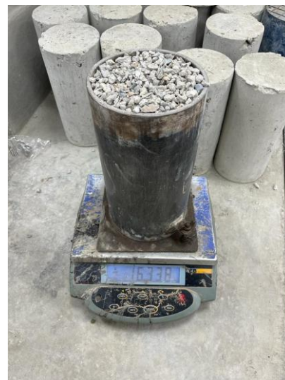
Ilustración 76: Peso unitario suelto de agregado reciclado
