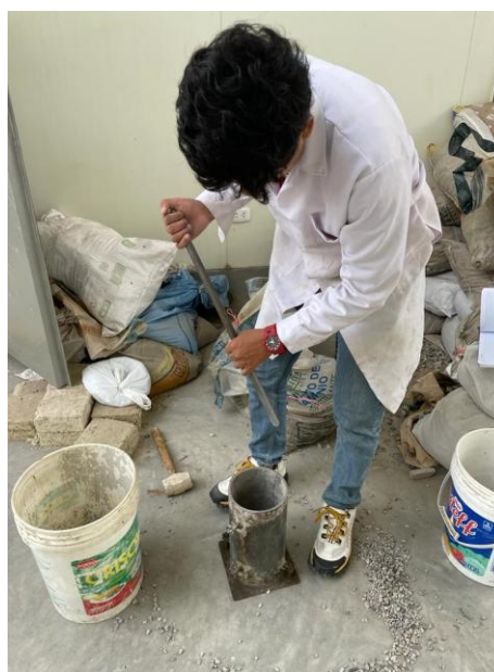
Ilustración 46: Apisonado del agregado
