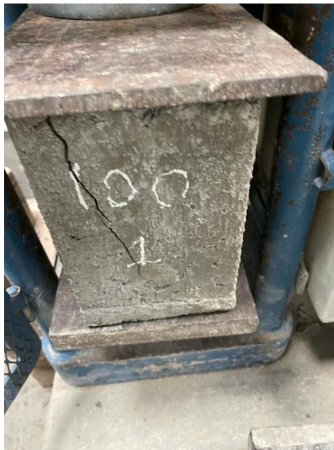
Ilustración 109: Falla de bloque por compresión
