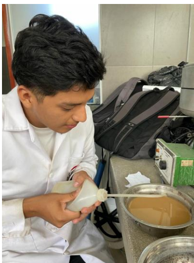
Ilustración 37: Retirar el agua superficial
