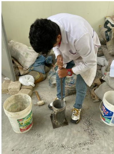
Ilustración 83: Apisonado del agregado
