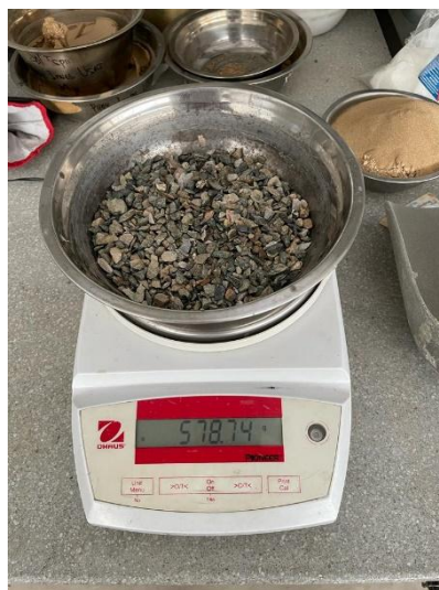
Ilustración 32: Confitillo secado en el horno por 24h
