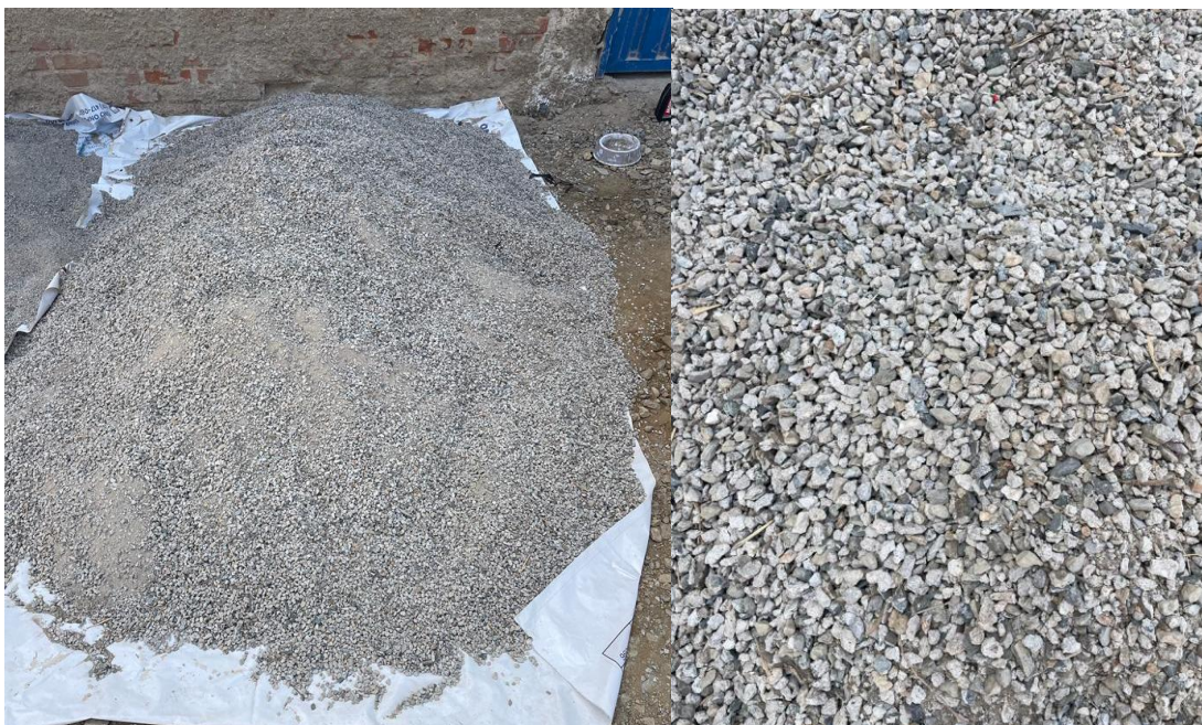
Ilustración 15: Agregado confitillo reciclado, obtenido del proceso de zarandeo
