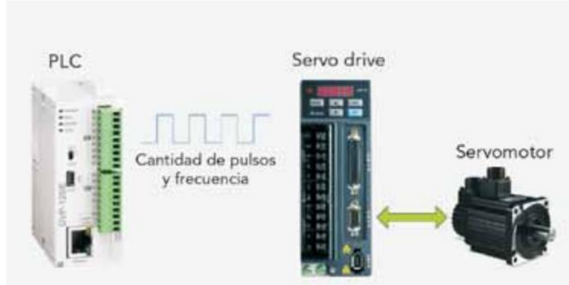
Figura 5: Sistema de conexión del servomotor al PLC [13]
