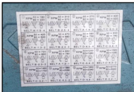
Figura 21: Combinación de velocidades del taladro N°01
