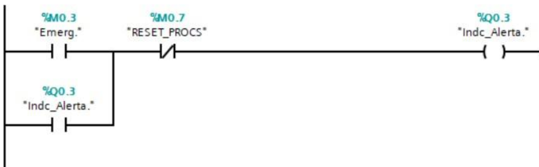
Figura 10: Encendido de lámpara de emergencia Fuente: Elaboración propia
