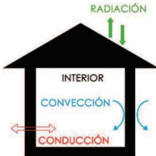
Ilustración 9: Distintos mecanismos de transmisión térmica en edificios
