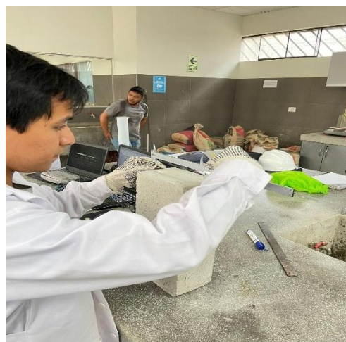
Ilustración 19: Realización del ensayo de variación dimensional
