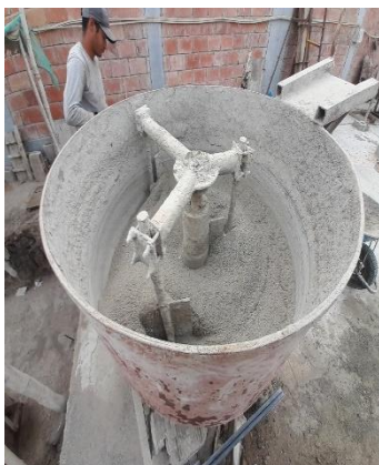
Ilustración 18: : Elaboración de bloques de concreto
