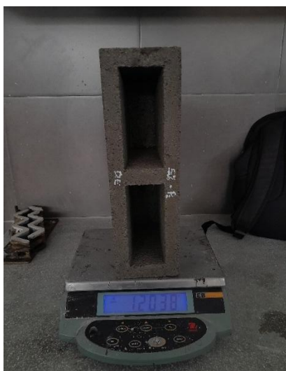
Ilustración 21: Realización del ensayo de densidad y Absorción
