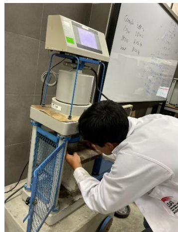
Ilustración 22: Realización del ensayo de resistencia a la compresión
