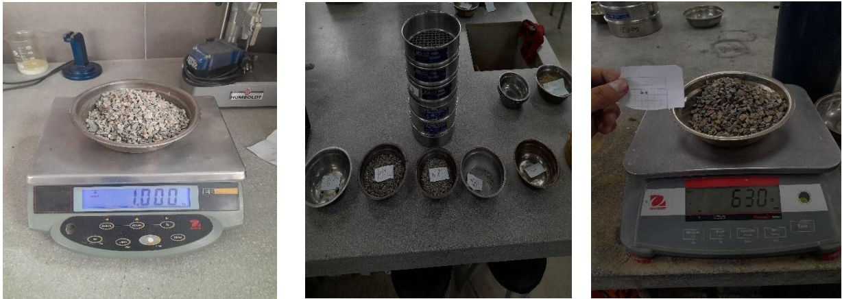
Ilustración 13: granulometría del agregado grueso
