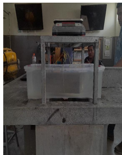
Ilustración 21: Realización del ensayo de densidad y Absorción
