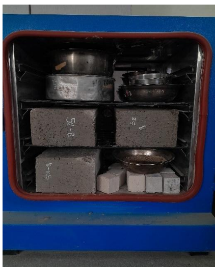
Ilustración 21: Realización del ensayo de densidad y Absorción
