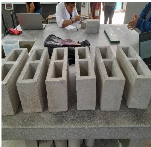
Ilustración 19: Realización del ensayo de variación dimensional
