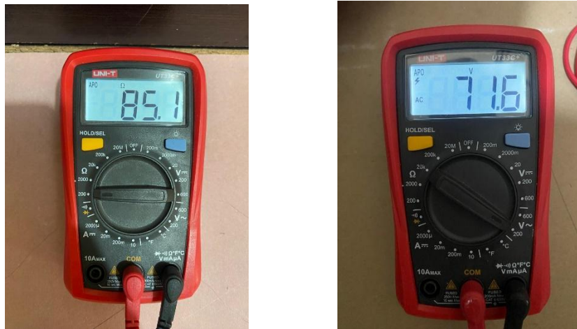
Ilustración 26: Medición de la resistencia y voltaje de la placa caliente
