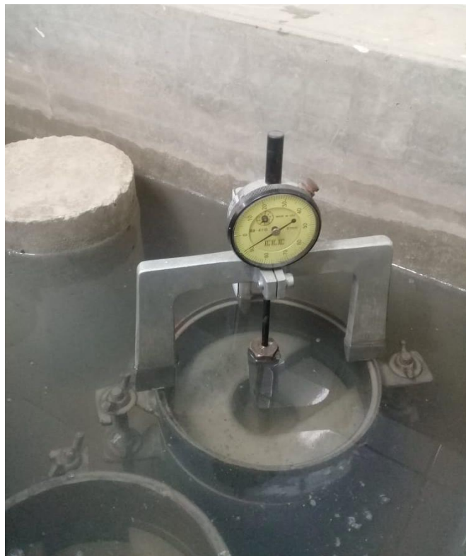
Ilustración 59: Medición de la expansión Fuente: Propia
