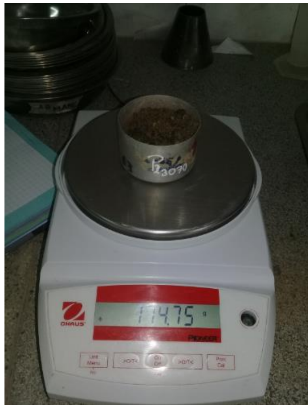
Ilustración 65: Determinación del contenido de humedad de la muestra Fuente: propia
