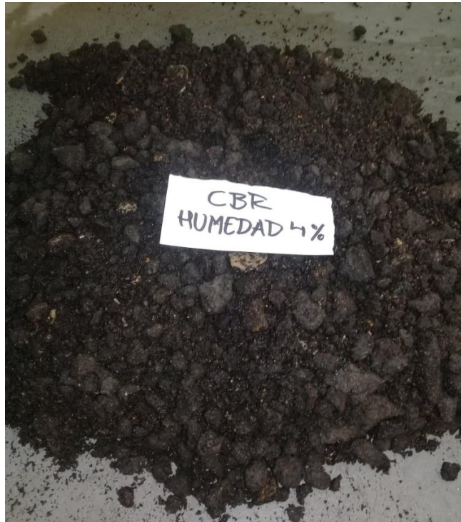
Ilustración 58: Preparación de la muestra para ensayo de CBR Fuente: Propia
