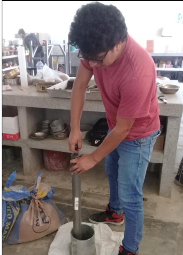
Ilustración 57: Ensayo de proctor modificado Fuente: Propia
