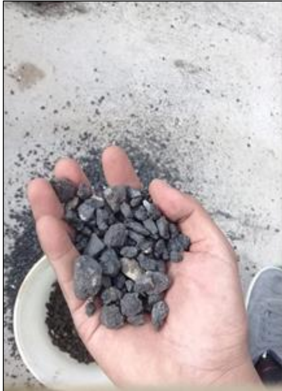
Ilustración 54: Carpeta asfáltica triturada Fuente: Propia
