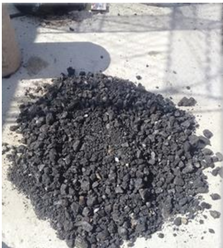
Ilustración 8: Trituración de la carpeta asfáltica Fuente: Propia
