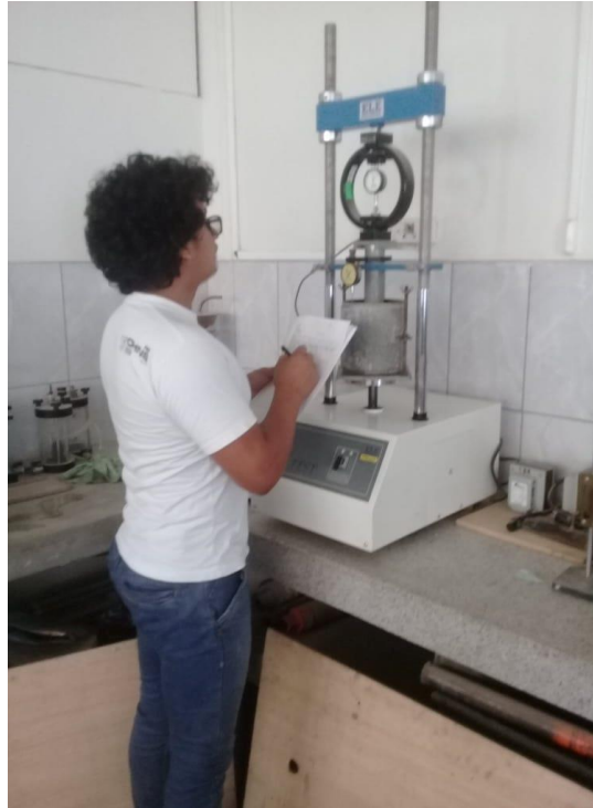
Ilustración 62: Lectura del dial en el ensayo de penetración para cálculo de CBR fuente: Propia
