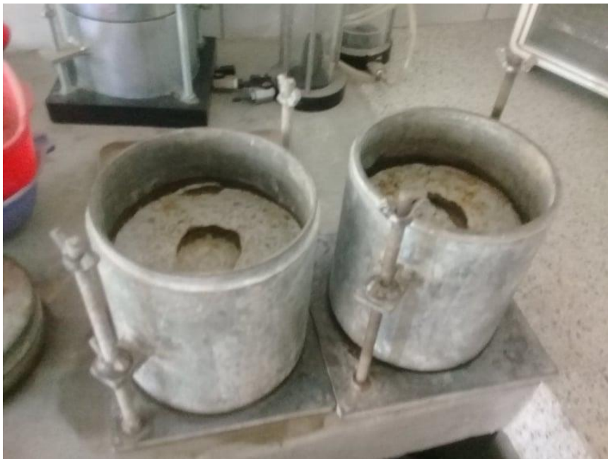
Ilustración 63: Testigos luego del ensayo de penetración Fuente: propia
