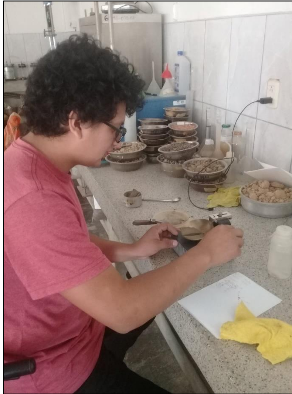
Ilustración 56: Determinación del límite líquido y el límite plástico Fuente: Propia
