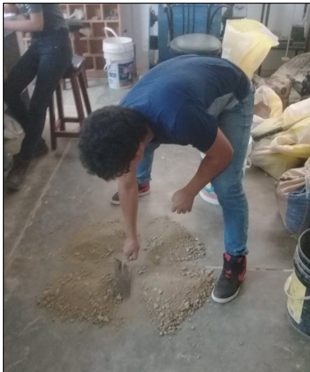
Ilustración 55: Cuarteo de la muestra a ensayar Fuente: Propia
