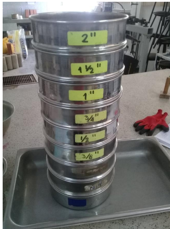
Ilustración 61: Análisis granulométrico por tamizado Fuente: propia
