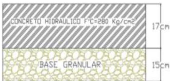
Ilustración 9 Resultado de espesores Pavimentos Rígido ASSHTO -93
