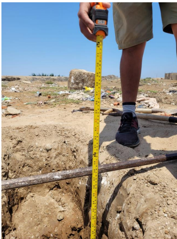
Fotografía 17 Exploración de calicatas (profundidad 1.50 m)
