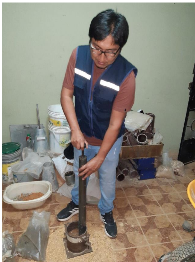
Fotografía 24 Compactación de muestra en moldes
