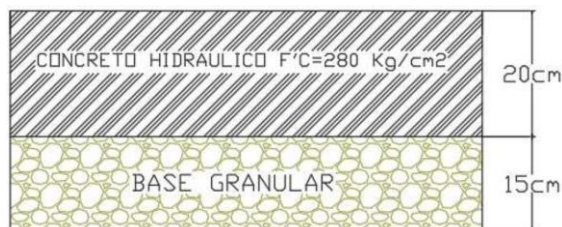
Ilustración 11 Resultado de espesores Pavimentos Rígido PCA
