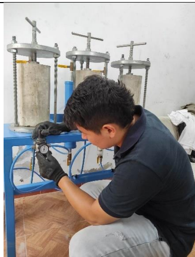
Figura 67: Tesista aplicando presión de 500kPa.
