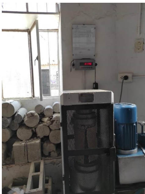
Figura 88: Ensayo de compresión a bioconcreto de 1 \times 10^5 cel/ml.
