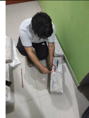
Figura 144: Tesista tomando medidas de viga – concreto patrón.
