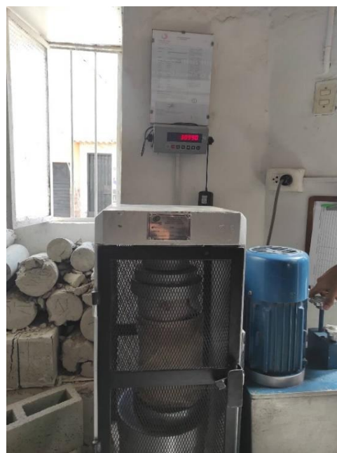
Figura 89: Ensayo de compresión a bioconcreto de 1 \times 10^6 cel/ml.
