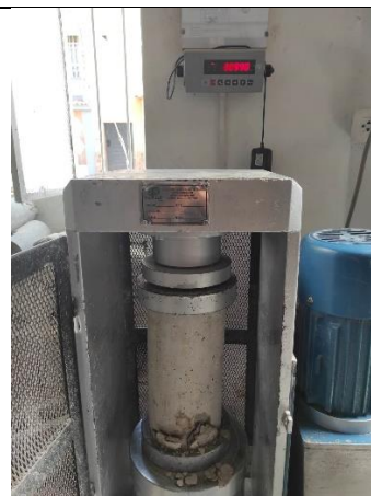
Figura 60: Espécimen de concreto bacteriano, ensayado a compresión.
