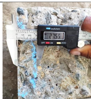
Figura 113: Distancia más lejana que el agua logra penetrar en el bioconcreto – 1 \times 10^5 cel/ml. (2B).
