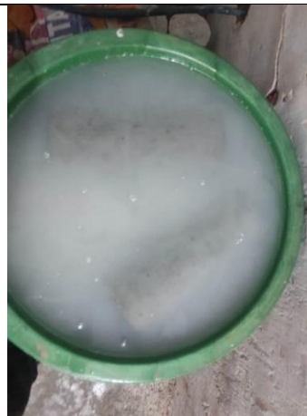
Figura 58: Curado a bioconcreto con hidróxido de calcio y urea
