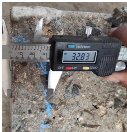
Figura 111: Distancia más lejana que el agua logra penetrar en el bioconcreto – 1 \times 10^5 cel/ml. (1B).
