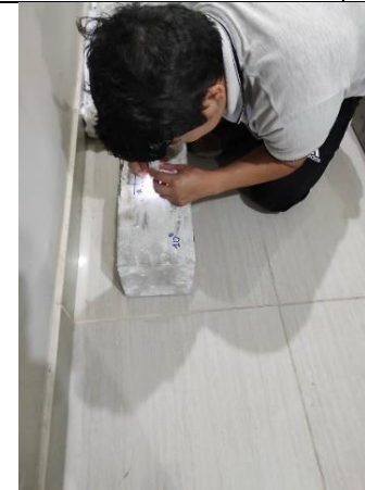
Figura 161: Tesista tomando medidas de viga - bioconcreto 1 \times 10^5 cel/ml.
