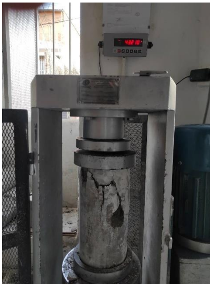
Figura 91: Ensayo de compresión a bioconcreto de 1 \times 10^5 cel/ml.cel/ml.
