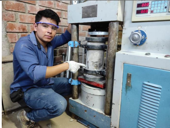
Figura 99: Tesista ensayando concreto patrón.
