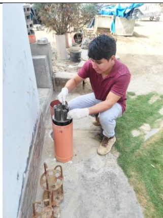
Figura 123: Tesista retirando vigas de la solución sulfatosa.
