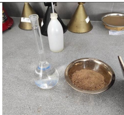
Figura 29: Matraz con agua y muestra de agregado fino.
