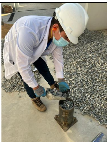
Figura 24: Llenado de molde con agregado grueso.
