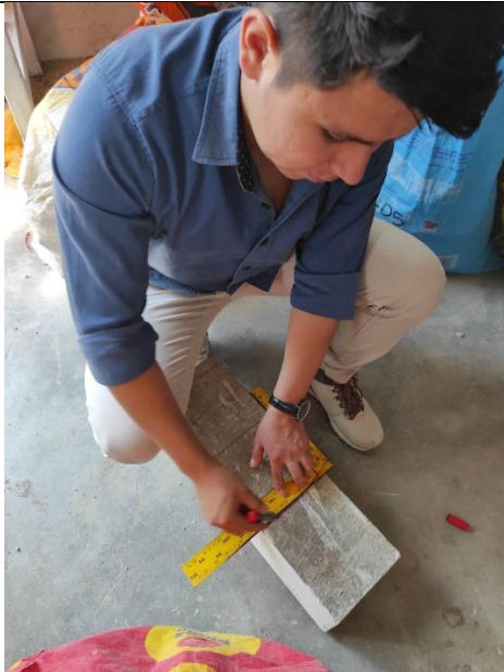
Figura 63: Tesista marcando viga para ser ensayada a flexión.
