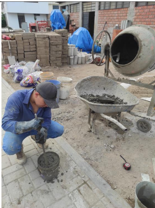
Figura 120: Tesista varillando mortero ya pasado por la malla N°4.
