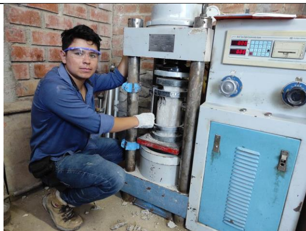
Figura 101: Tesista ensayando concreto bacteriano 1 \times 10^6 cel/ml.
