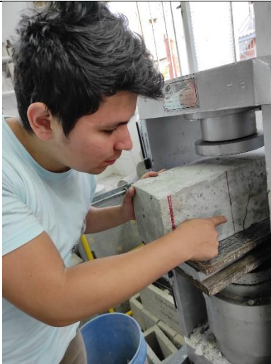
Figura 77: Tesista señalando la fisura obtenida en la muestra prismática.
