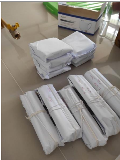
Figura 30: Material de vidrio que será colocado al horno a 150°C por 24 h.
