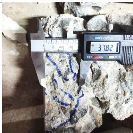
Figura 116: Distancia más lejana que el agua logra penetrar en el bioconcreto – 1 \times 10^6 cel/ml. (1A).
