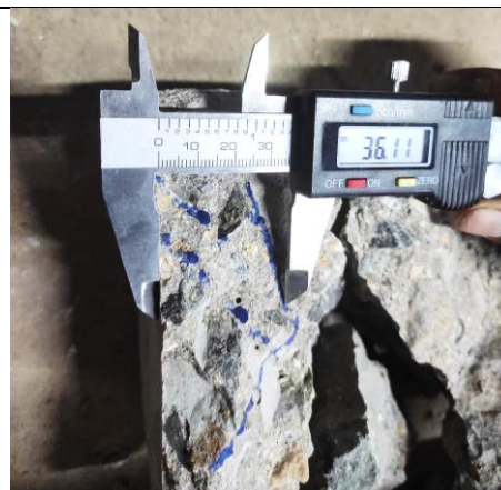
Figura 117: Distancia más lejana que el agua logra penetrar en el bioconcreto – 1 \times 10^6 cel/ml.. (1B).
