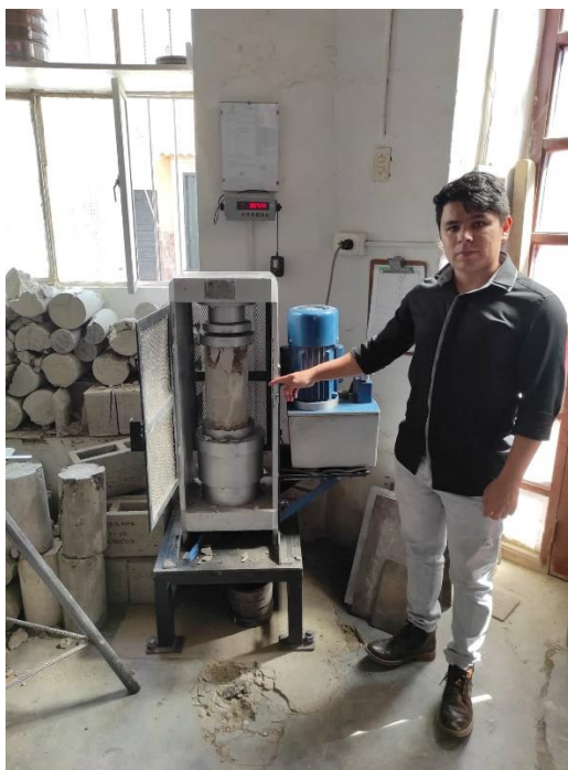
Figura 87: Ensayo de compresión a concreto patrón.
