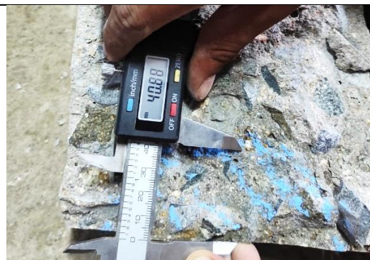
Figura 107: Distancia más lejana que el agua logra penetrar en el concreto patrón (2B).
