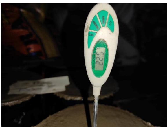
Figura 85: Temperatura alcanzada del bioconcreto de 1 \times 10^5 cel/ml.
