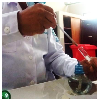
Figura 46: Inserción de Asa con aguja Sterilin dentro de tubo de ensayo.
