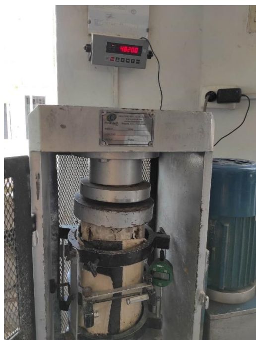
Figura 94: Ensayo de compresión a bioconcreto de 1 \times 10^5 cel/ml.
