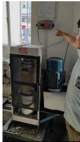
Figura 92: Ensayo de compresión a bioconcreto de 1 \times 10^6 cel/ml.
