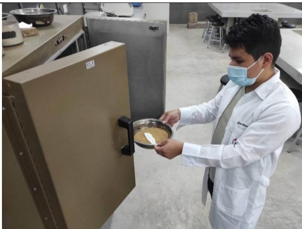
Figura 20: Tesista colocando muestra de agregado fino al horno.
