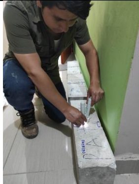
Figura 143: Tesista tomando medidas de viga – concreto patrón.
