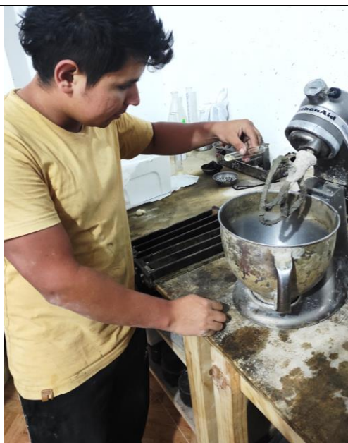
Figura 73: Tesista colocando inóculo bacteriano a muestras de mortero.
