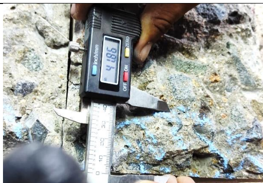
Figura 106: Distancia más lejana que el agua logra penetrar en el concreto patrón (2A).
