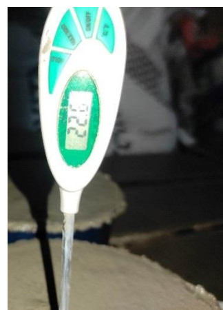
Figura 86: Temperatura alcanzada del bioconcreto de 1 \times 10^6 cel/ml.
