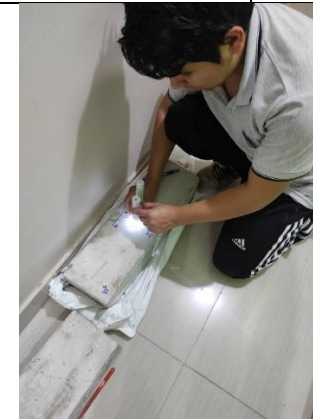
Figura 178: Tesista tomando medidas de viga - bioconcreto 1 \times 10^6 cel/ml.
