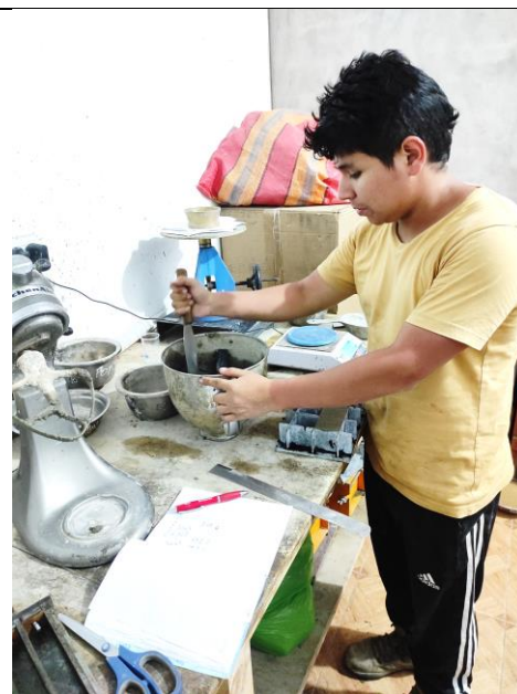
Figura 74: Tesista preparando muestras de mortero de cemento Portland.
