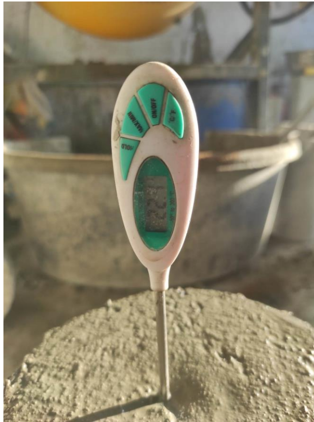
Figura 84: Temperatura alcanzada del concreto patrón.
