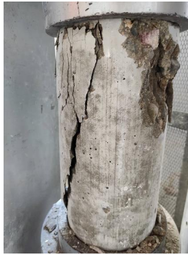
Figura 90: Ensayo de compresión a concreto patrón.
