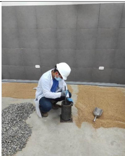
Figura 22: Apisanado por capa para peso unitario compactado.
