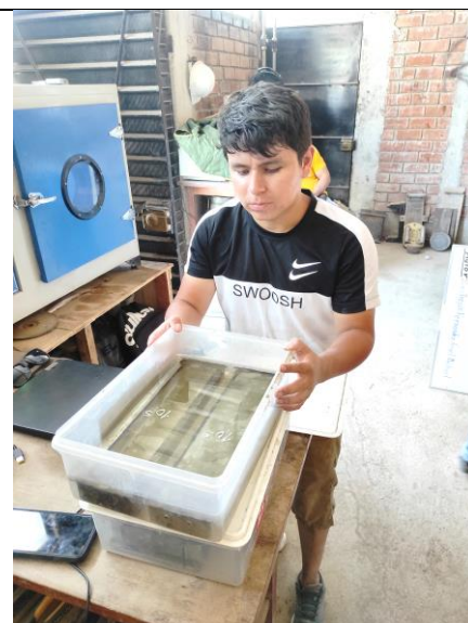
Figura 76: Tesista con muestras de bioconcreto 1 \times 10^5 cel/ml en curación.
