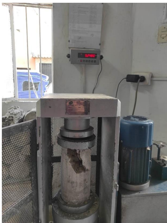
Figura 97: Ensayo de compresión a bioconcreto de 1 \times 10^5 cel/ml.
