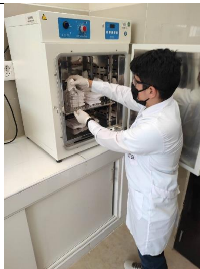
Figura 31: Tesista colocando material de vidrio a estufa a 60°C.
