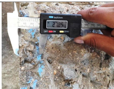
Figura 112: Distancia más lejana que el agua logra penetrar en el bioconcreto – 1 \times 10^5 cel/ml. (2A).
