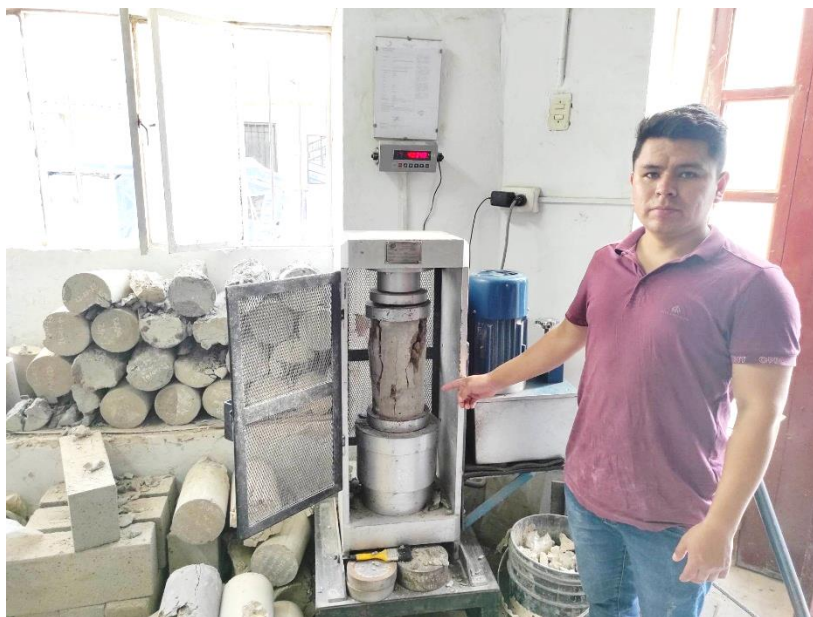
Figura 96: Ensayo de compresión a concreto patrón.
