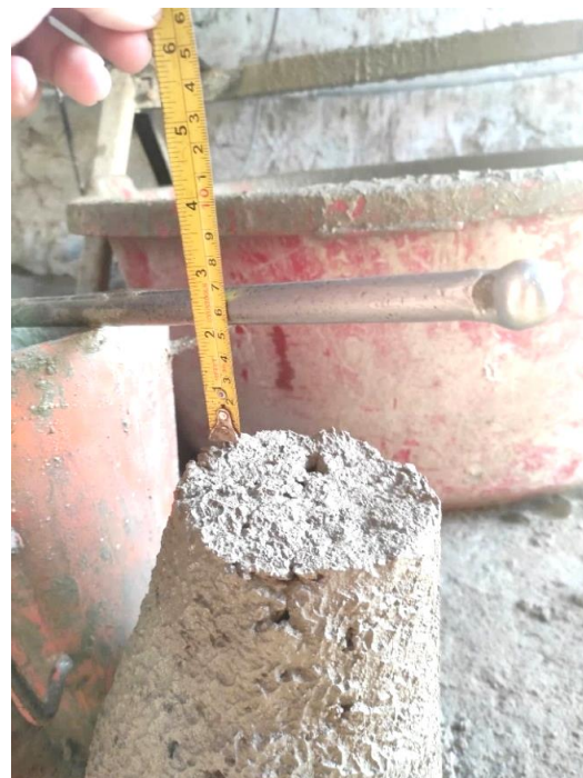
Figura 83: Asentamiento alcanzado del bioconcreto de 1 \times 10^6 cel/ml.
