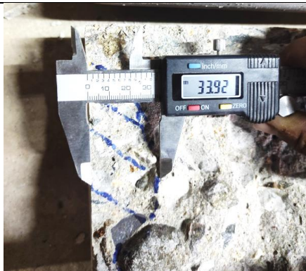
Figura 118: Distancia más lejana que el agua logra penetrar en el bioconcreto – 1 \times 10^6 cel/ml. (2A).
