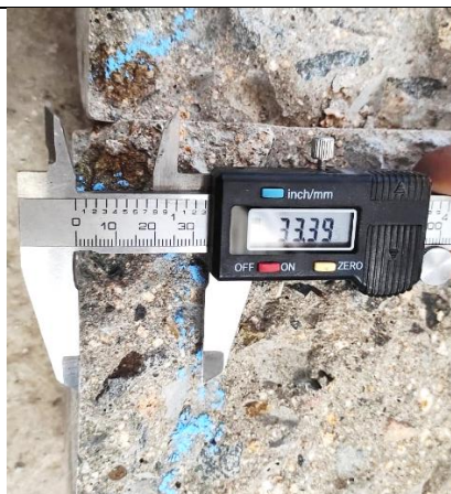
Figura 110: Distancia más lejana que el agua logra penetrar en el bioconcreto – 1 \times 10^5 cel/ml. (1A).
