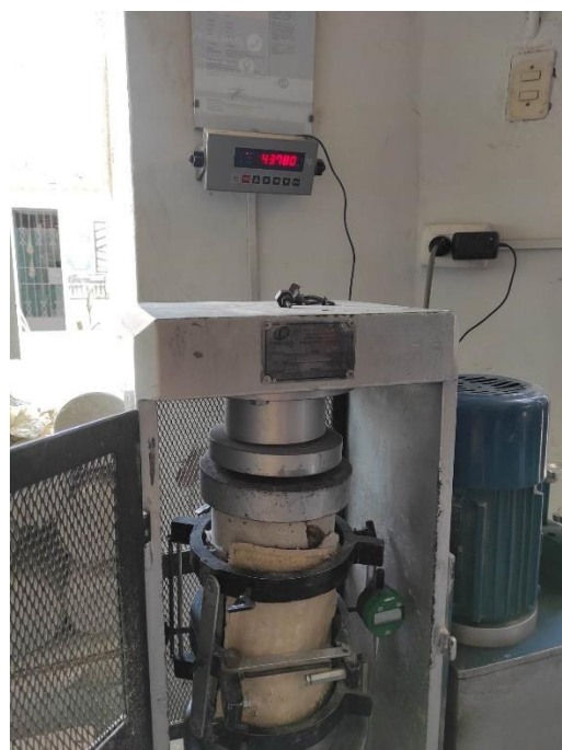
Figura 95: Ensayo de compresión a bioconcreto de 1 \times 10^6 cel/ml.
