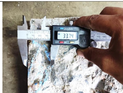
Figura 105: Distancia más lejana que el agua logra penetrar en el concreto patrón (1B).
