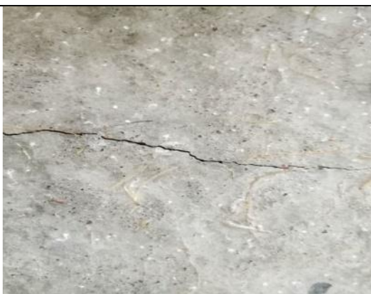
Figura 1: se observa grietas de 1,5 mm creadas manualmente en un elemento de 28 días de endurecimiento.
