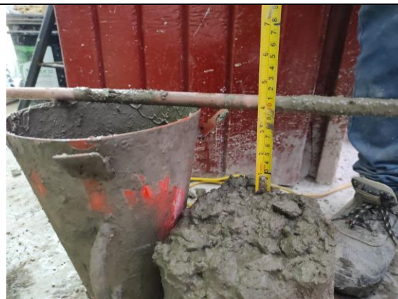
Figura 54: Slump de concreto patrón 4"
