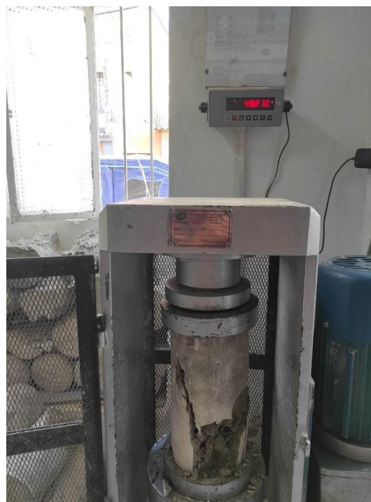
Figura 98: Ensayo de compresión a bioconcreto de 1 \times 10^6 cel/ml.
