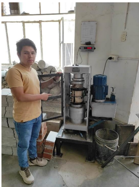
Figura 93: Ensayo de compresión a concreto patrón.
