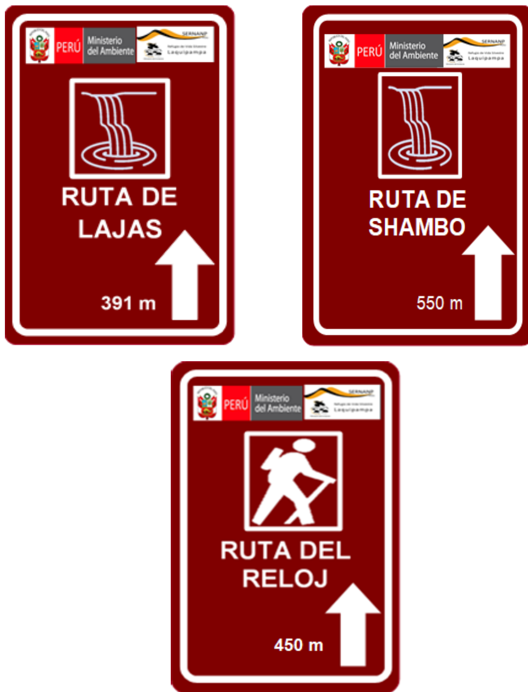
Figura N° 9: Señal Informativa de Pre-señalización de destino en vías peatonales
