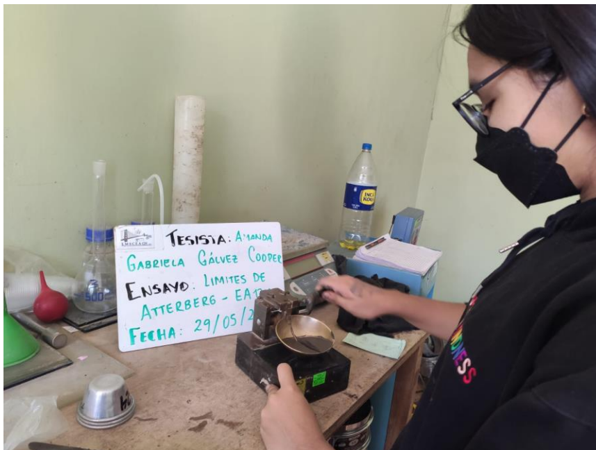
Figura 20: Ejecución de ensayo de limite líquido a suelo con adición de emulsión asfáltica.
