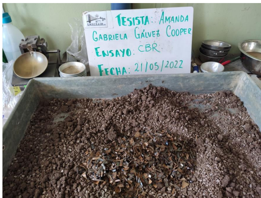
Figura 14: Preparación de mezcla de suelo – virutas de acero. Fuente: Elaboración propia.
