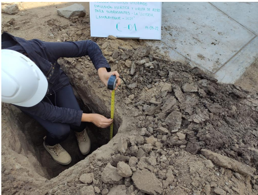
Fotografía IV: Toma de medida de calicata 02.
