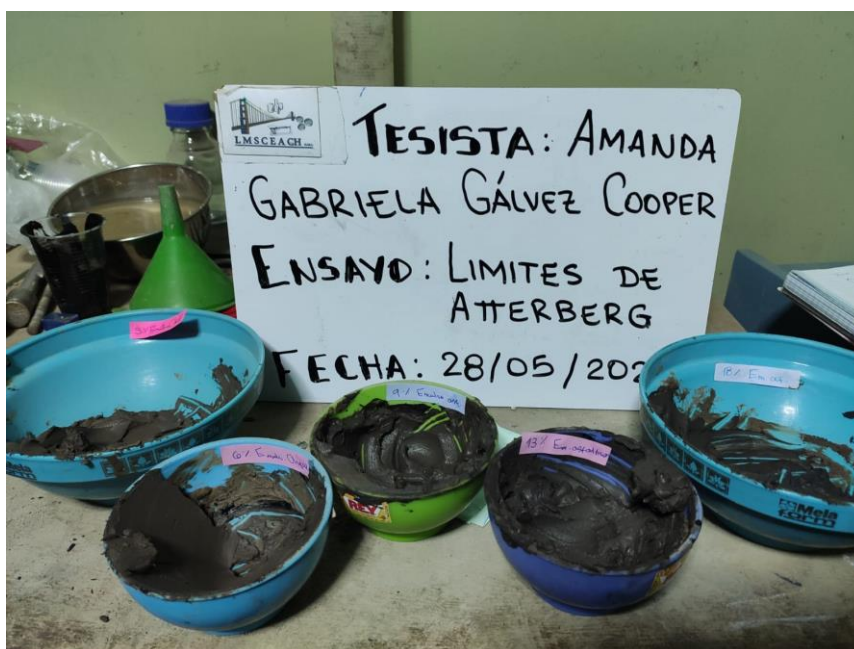
Figura 18: Mezcla realizada para la ejecución del ensayo de Límites de Atterberg de suelo con adición de emulsión asfáltica.
