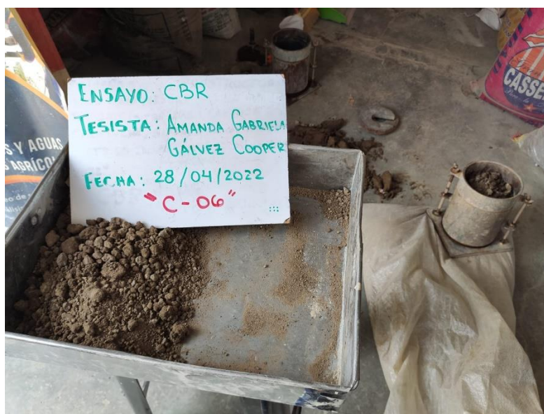
Figura 10: Preparación de mezcla y compactación de suelo para el ensayo de CBR.
