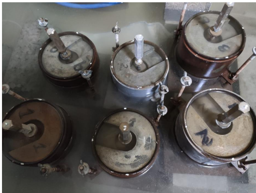
Figura 23: Probetas de CBR sumergidas en agua. Fuente: Elaboración propia.
