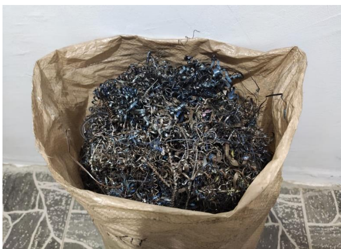
Figura 12: Estado inicial de las virutas de acero antes de su procesamiento. Fuente: Elaboración propia.
