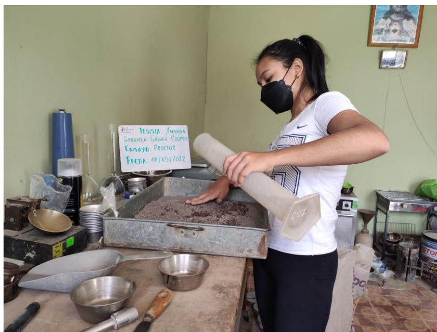
Figura 15: Preparación de mezcla suelo – virutas de acero Fuente: Elaboración propia.
