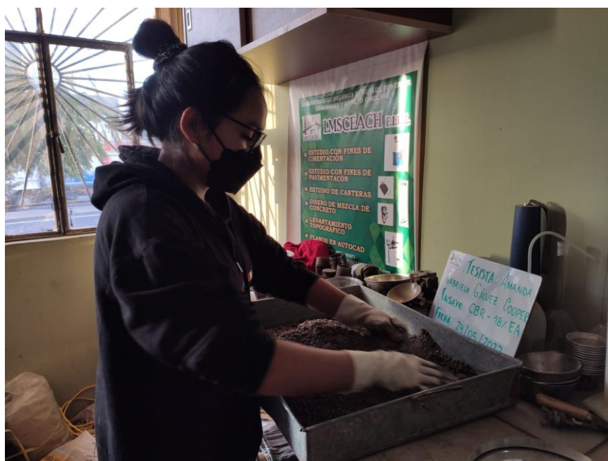
Figura 21: Preparación de mezcla de suelo con emulsión asfáltica para el ensayo de CBR.
