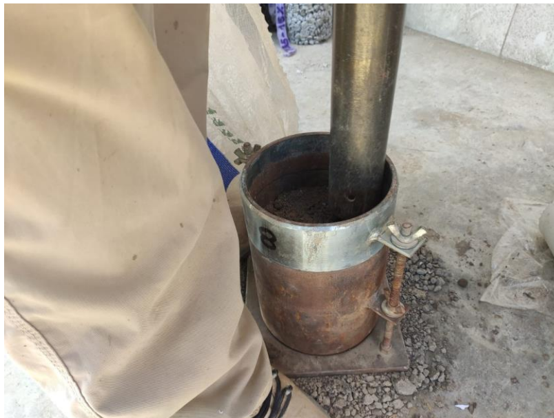
Figura 16: Compactación de la muestra se suelo en los moldes de CBR. Fuente: Elaboración propia.
