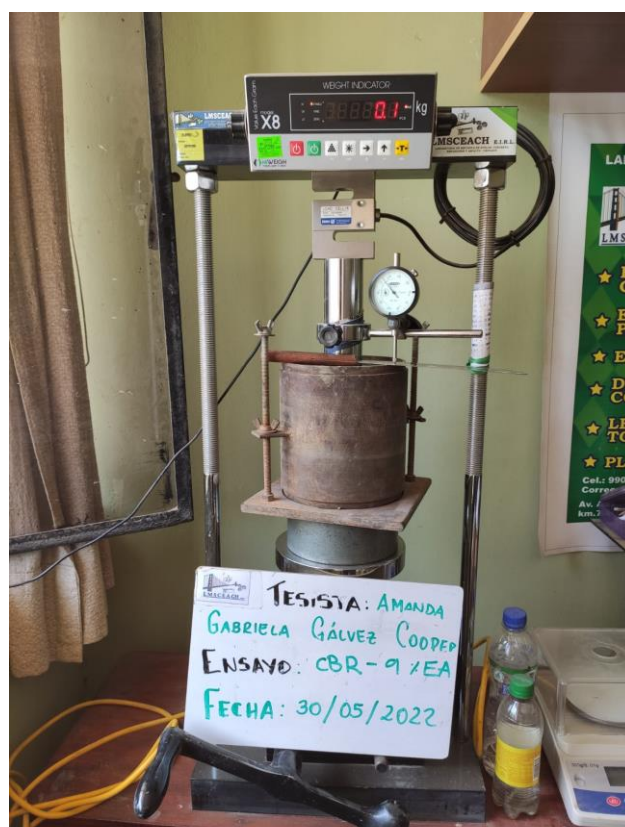
Figura 22: Penetración de probetas de suelo con adición de emulsión asfáltica. Fuente: Elaboración propia.
