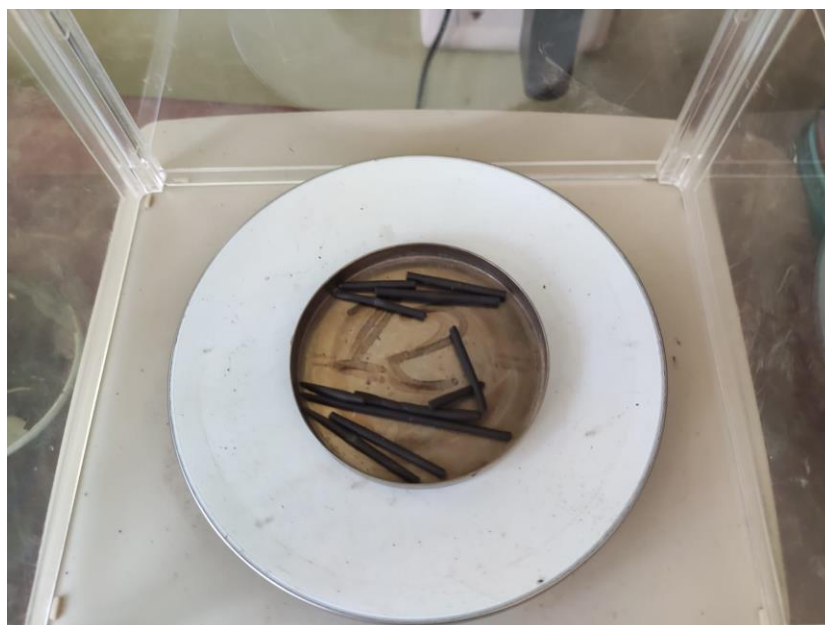
Figura 19: Elaboración de barritas de suelo con emulsión asfáltica para el ensayo de Limite plástico.
