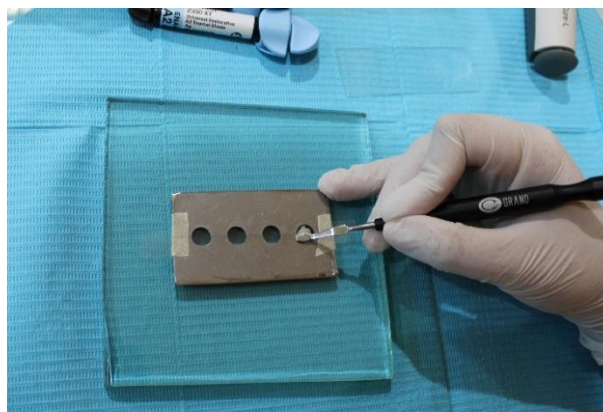
Fig 2: Fabricación del disco de resina Z350XT utilizando una matriz
