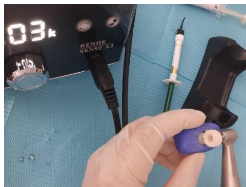
Fig 12: Pulido con pasta de diamante Diamond Polish de 1 \mu m y felpa
