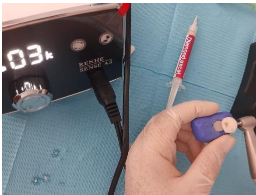
Fig 13: Pulido con pasta de diamante Diamond Excel de 2-4 \mu m y felpa
