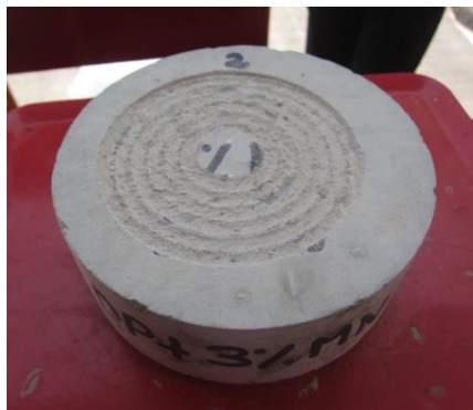
Ilustración 93. Resultado final del ensayo. Desgaste después de 3 ciclos.
