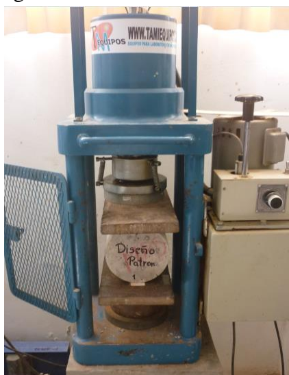
Ilustración 84. Aplicación de la carga – Resistencia a la Tracción.
