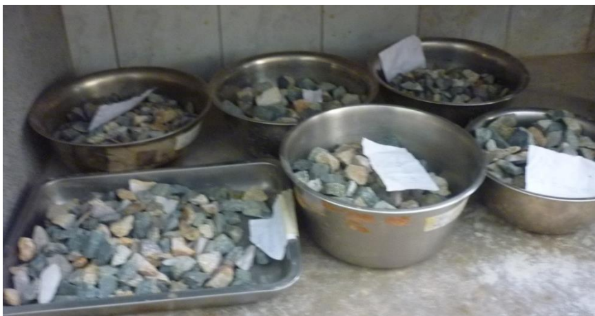
Imagen 8. Contenido de Humedad del agregado grueso.
