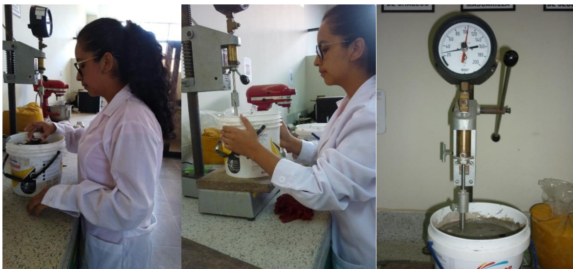
Imagen 27. Ensayo de penetración - Tiempo de Fraguado.
