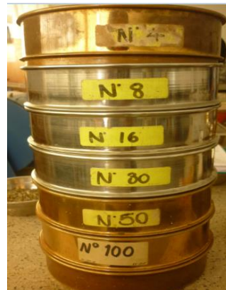
Ilustración 19. Tamices para la granulometría del agregado fino.
