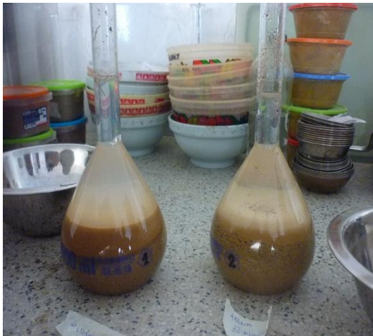
Ilustración 29. Reposo del agregado fino en la fiola por 24hr.
