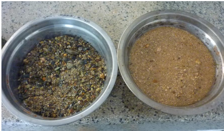
Imagen 7. Agregado fino lavado a través del tamiz N°200 de la cantera Bomboncito y La victoria - Ensayo de granulometría.
