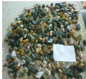
Ilustración 36. Secado del agregado grueso a temperatura ambiente.
