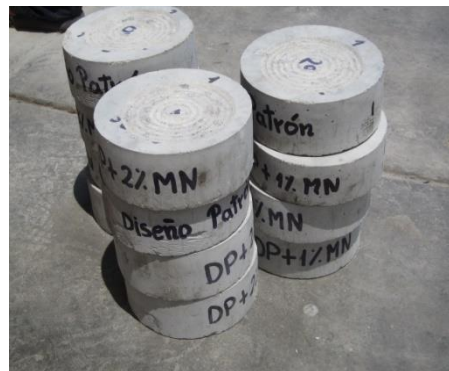
Ilustración 94. Probetas ensayadas - Resistencia al desgaste.
