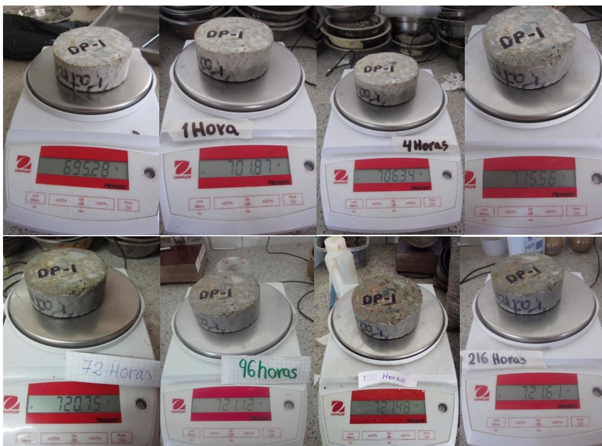
Imagen 42. Ensayo de permeabilidad - Absorción de agua de las muestras del diseño de mezclas ajuste por slump, f'c=210\text{kg/cm}^2 , 28 días de edad.
