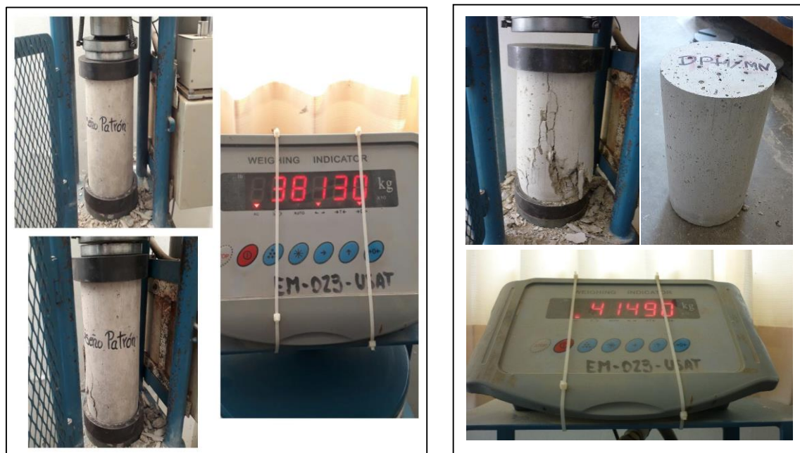
Imagen 30. Ensayo de resistencia a la compresión del concreto f'_c=210\text{kg/cm}^2 , 14 días de edad.
