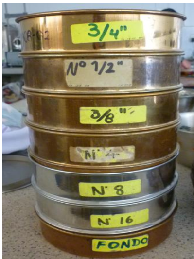
Ilustración 22. Tamices para el análisis granulométrico del agregado grueso.
