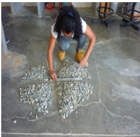
Ilustración 20. Cuarteo del agregado grueso.
