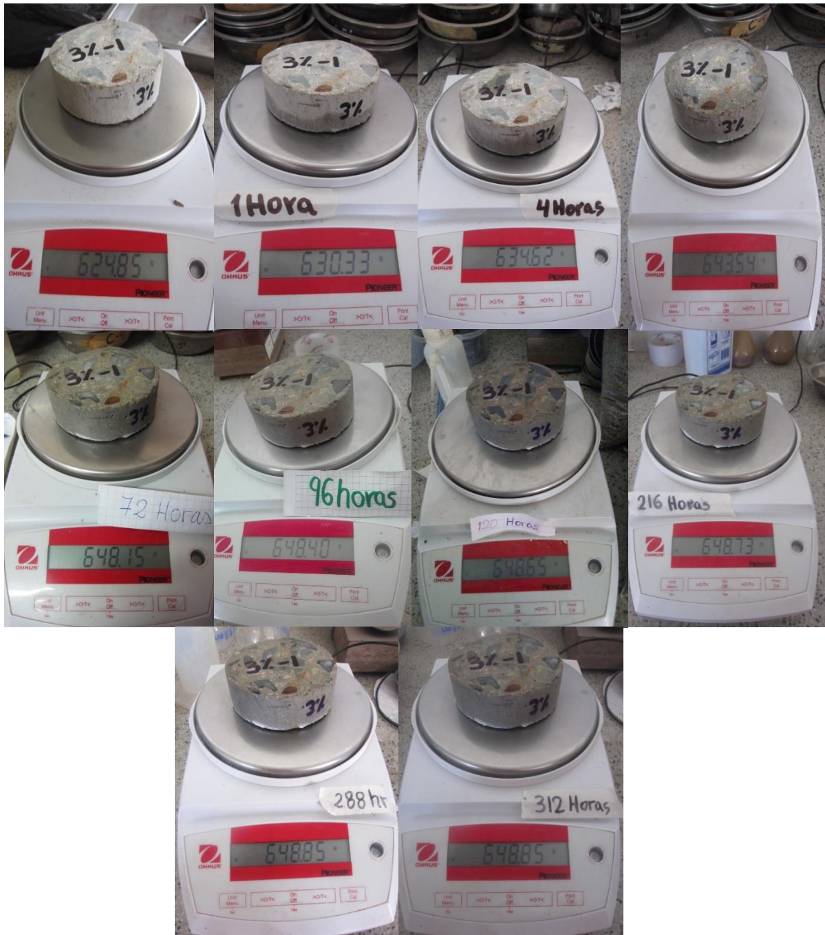
Imagen 45. Ensayo de permeabilidad - Absorción de agua de las muestras del diseño de mezclas ajuste por slump + 3%MN, 28 días de edad.
