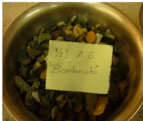
Ilustración 38. Agregado grueso listo para ser colocada en el horno por 24hr.
