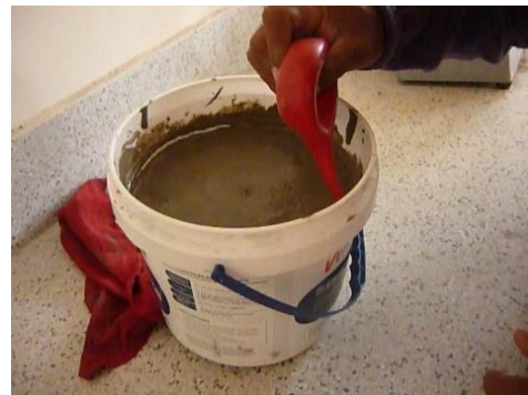
Ilustración 73. Extracción del agua generada por la exudación del concreto.
