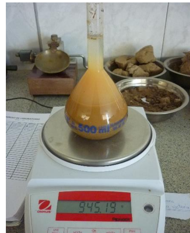
Ilustración 30. Peso de la muestra + fiola + agua.
