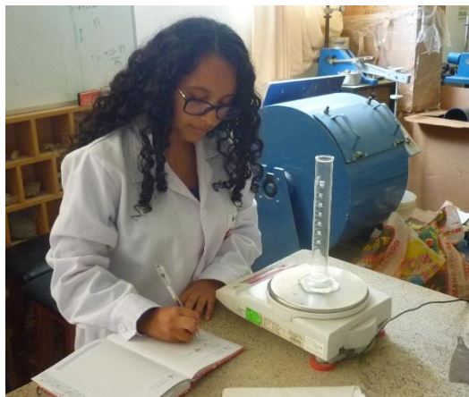
Ilustración 45. Registro de datos obtenidos en el ensayo - Densidad del Mucílago de Nopal.
