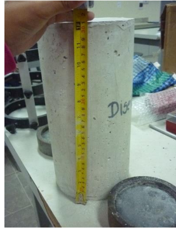
Ilustración 97. Medición de la altura del testigo.
