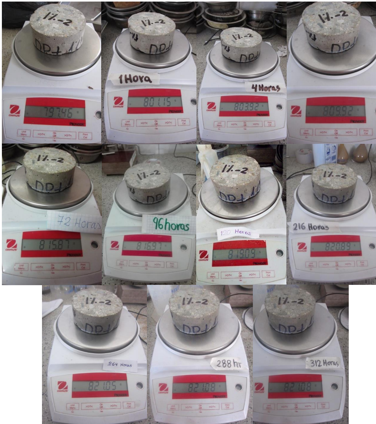
Imagen 43. Ensayo de permeabilidad - Absorción de agua de las muestras del diseño de mezclas ajuste por slump + 1%MN, 28 días de edad.
