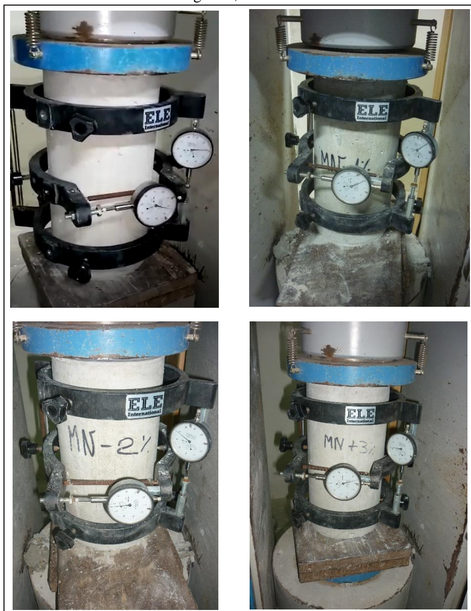
Imagen 37. Ensayo del módulo de elasticidad del concreto, f'_c=210\text{kg/cm}^2 , 28 días de edad.
