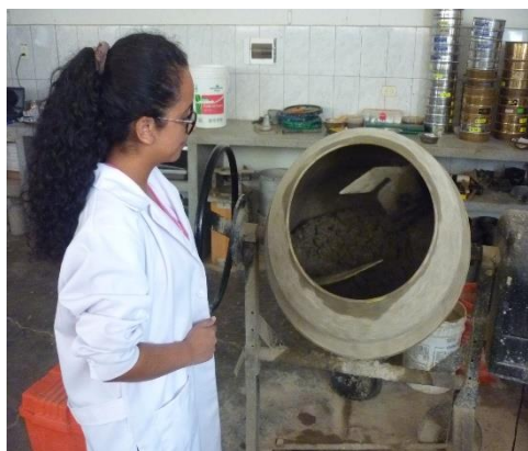
Ilustración 54. Mezcla de concreto en el trompo para muestra de ensayo.
