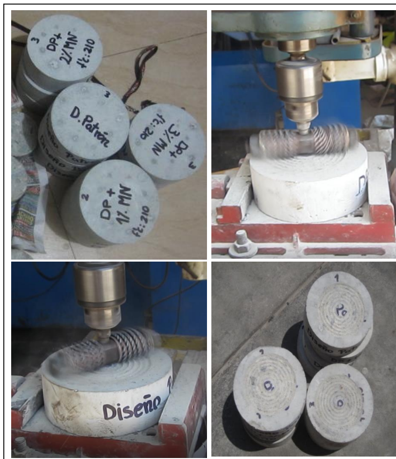
Imagen 34. Ensayo de Resistencia al desgaste del concreto, f'_c=210\text{kg/cm}^2 , 28 días de edad
