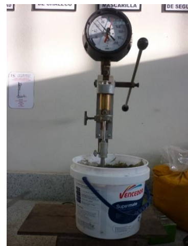
Ilustración 75. Penetración de la aguja en la muestra.
