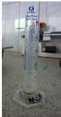
Ilustración 67. Probeta de 100ml contenida con el agua extraída de la muestra de concreto.
