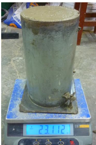
Ilustración 51. Peso del recipiente de medida más el concreto.
