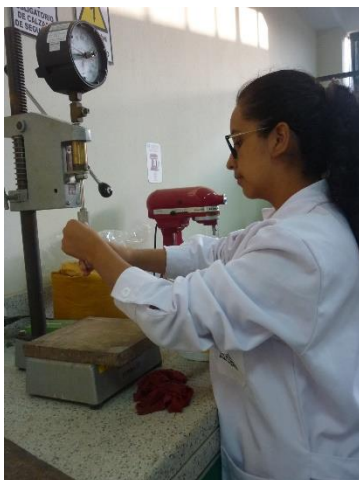
Ilustración 74. Colocación de las agujas de penetración en el dispositivo.
