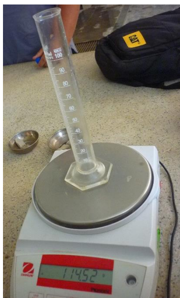
Ilustración 43. Peso de la fiola graduada.
