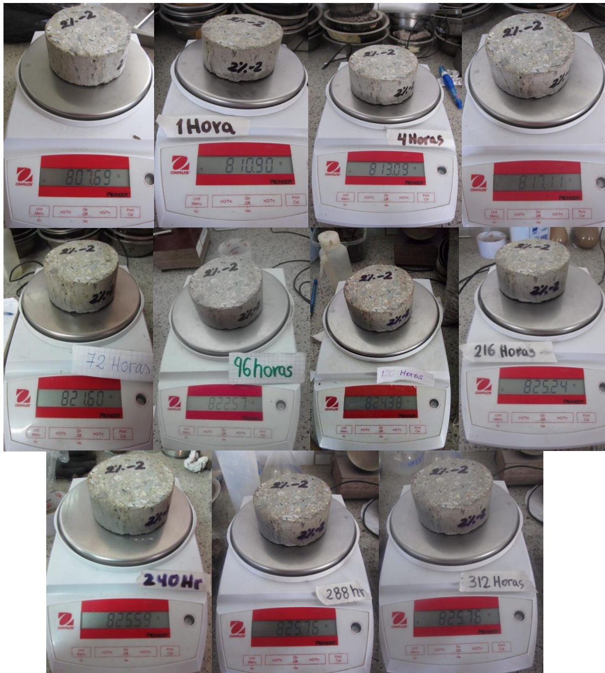
Imagen 44. Ensayo de permeabilidad - Absorción de agua de las muestras del diseño de mezclas ajuste por slump + 2%MN, 28 días de edad.
