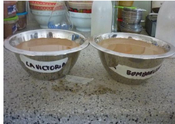
Imagen 10. Agregado fino en los recipientes listos para estar 24hr en el horno – Peso Específico.
