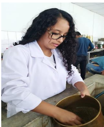
Ilustración 18. Lavado de la muestra para eliminar finos en la malla N° 200.
