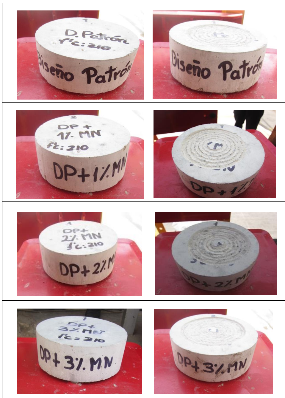
Imagen 35. Probetas desgastadas por el ensayo de durabilidad.
