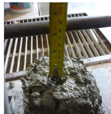
Ilustración 48. Slump de la muestra patrón 2.8".
