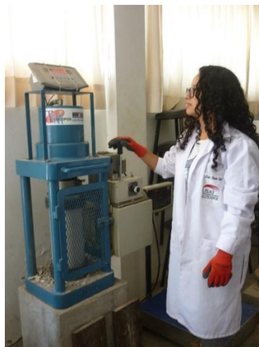
Ilustración 81. Aplicación de la carga – Resistencia a la Compresión.
