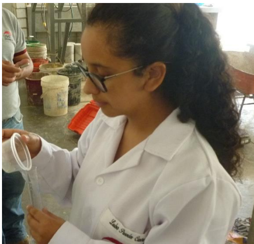
Ilustración 66. Colocación del agua exudada en la probeta de 100ml.
