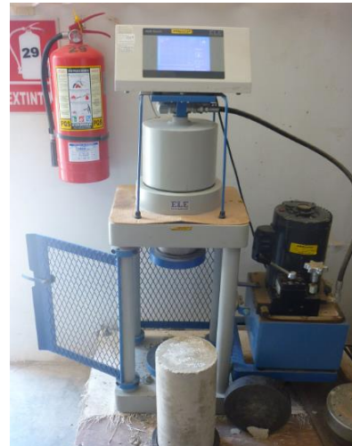
Ilustración 80. Testigo listo para ser colocado en la compresora.
