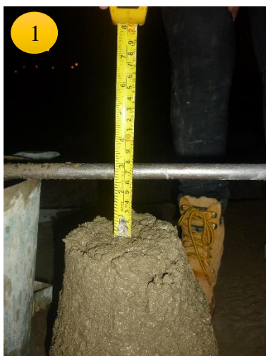
Imagen 22. Asentamiento del concreto - diseño de mezclas ajuste por Slump, más los diseños con incorporación de mucílago de nopal (1%, 2% y 3%).
