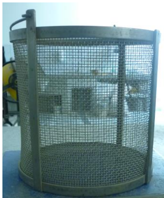
Ilustración 37. Canastilla para que el agregado grueso esté sumergida en el agua.
