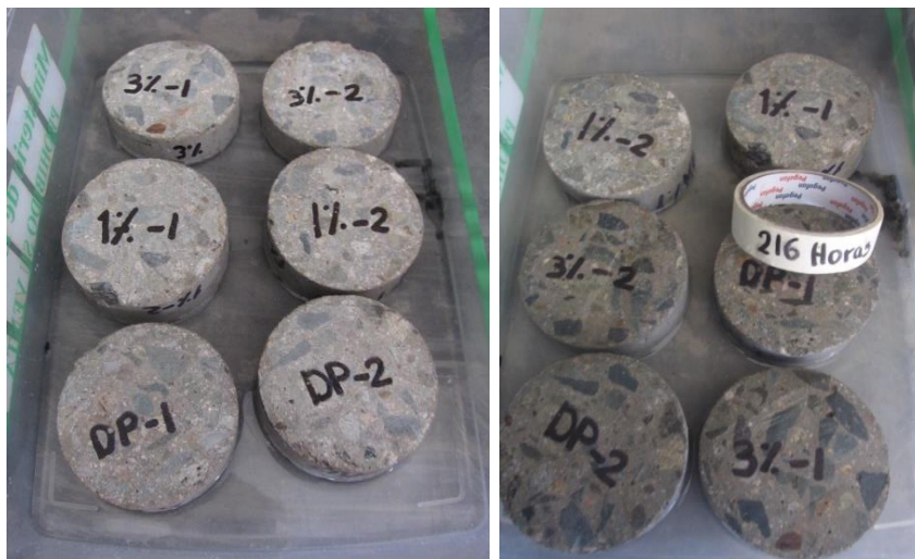
Imagen 41. Proceso de absorción de agua de las muestras de concreto en diferentes tiempos - Ensayo de Permeabilidad.
