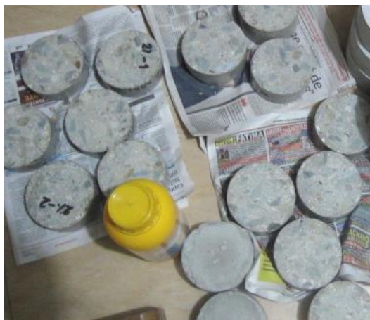
Imagen 39. Probetas aserradas e impermeabilizadas - Ensayo de Permeabilidad.
