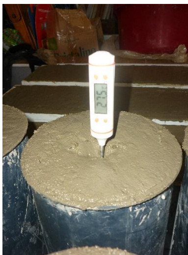
Ilustración 77. Temperatura de la muestra de concreto.
