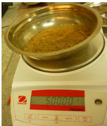
Ilustración 17. Peso del agregado fino para la granulometría (500gr).
