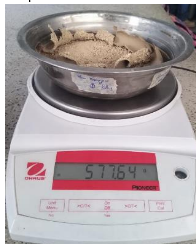
Ilustración 32. Peso de la muestra secada al horno + recipiente.
