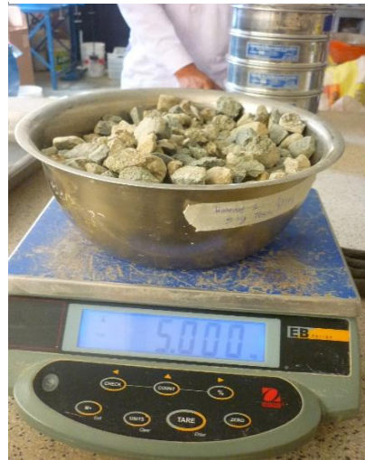
Ilustración 24. Peso del agregado grueso para ensayo de contenido de humedad (5kg).
