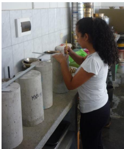
Ilustración 82. Marcación de las líneas diametrales de los testigos.
