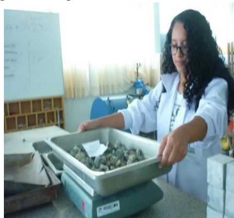
Ilustración 21. Pesado del agregado grueso (5kg).
