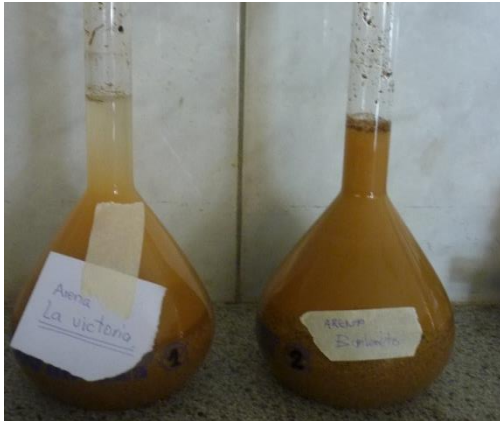
Imagen 9. Reposo del agregado fino en la fiola – Ensayo de Peso Específico.
