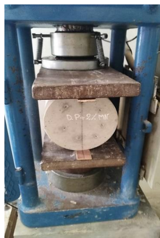
Ilustración 83. Posición adecuada del testigo para ser ensayado.
