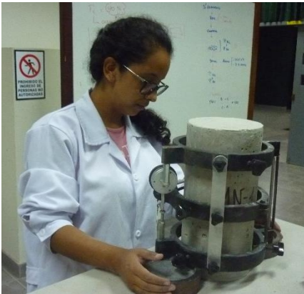
Ilustración 98. Colocación del equipo compresómetro – extensómetro en el testigo.
