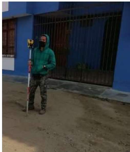
Figura 30. Prismero posicionado para toma de puntos
