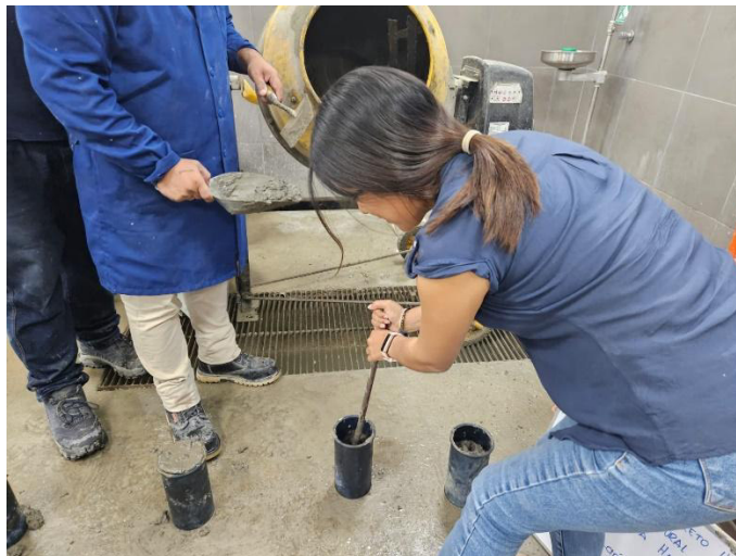
Gráfico 27: Llenado de Probetas
