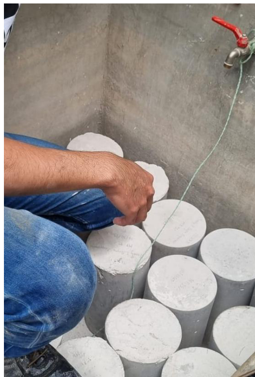
Gráfico 30: Llenado de piscina para curado de las probetas cilíndricas
