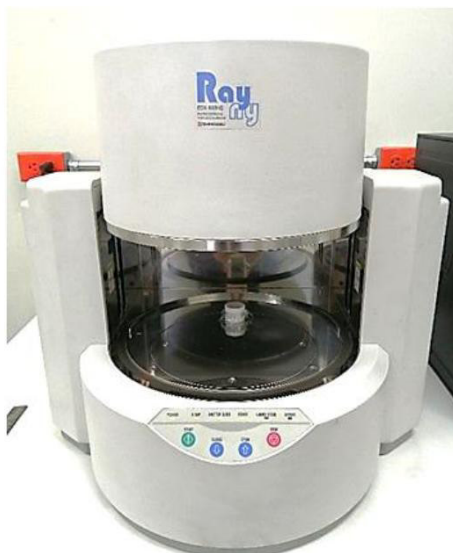
Gráfico 13: Análisis de Composición Química Usando el Espectrómetro De Fluorescencia De Rayos X De Energía Dispersiva (SHIMADZU, EDX-800HS)
