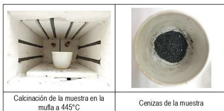
FIGURA N°2. CALCINACIÓN DE LA MUESTRA DE CÁSCARA DE PALTA HASS MOLIDA EN LA MUFLA (DAIHAN SCIENTIFIC) A 445°C.
