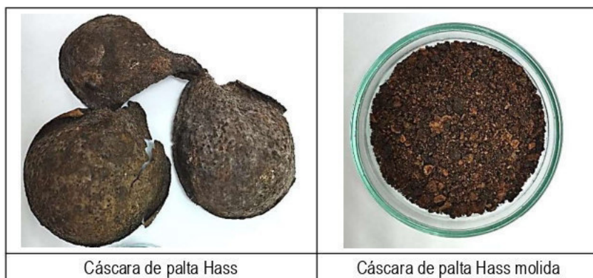
FIGURA N°1. MUESTRA DE CÁSCARA DE PALTA HASS Y SU MOLIENDA.
