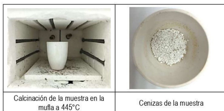
FIGURA N°2. CALCINACIÓN DE LA MUESTRA DE SEMILLAS DE PALTA HASS MOLIDA EN LA MUFLA (DAIHAN SCIENTIFIC) A 445°C.
