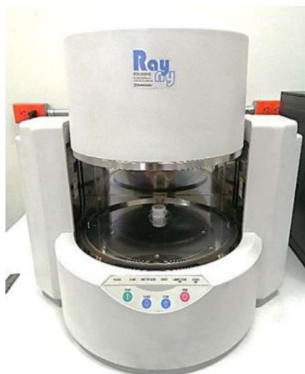
FIGURA N°3. ANÁLISIS DE COMPOSICIÓN QUÍMICA USANDO EL ESPECTRÓMETRO DE FLUORESCENCIA DE RAYOS X DE ENERGÍA DISPERSIVA (SHIMADZU, EDX-800HS).
