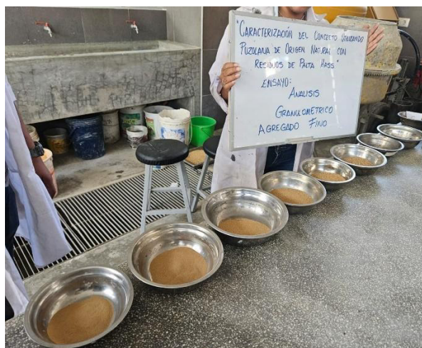
Gráfico 16: Separación del agregado de fino por retención de tamices
