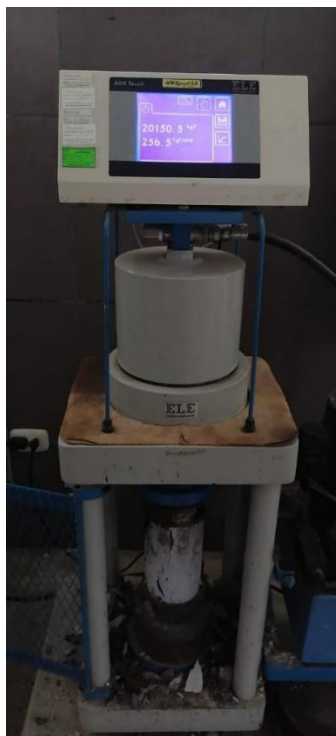
Gráfico 31: Rotura probetas cilíndricas
