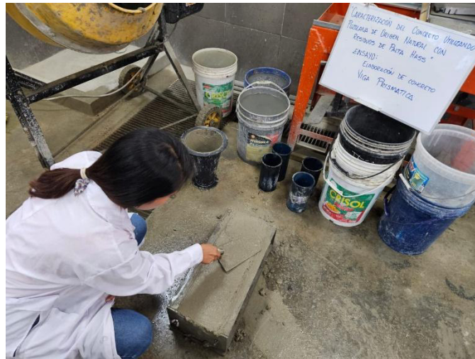
Gráfico 29: Llenado de muestras de moldes prismáticos
