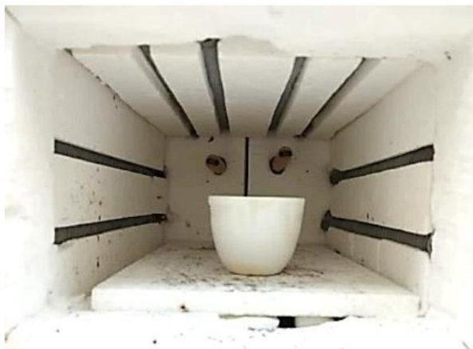
Gráfico 11: Calcinación de la muestra en la mufla a 445°C
