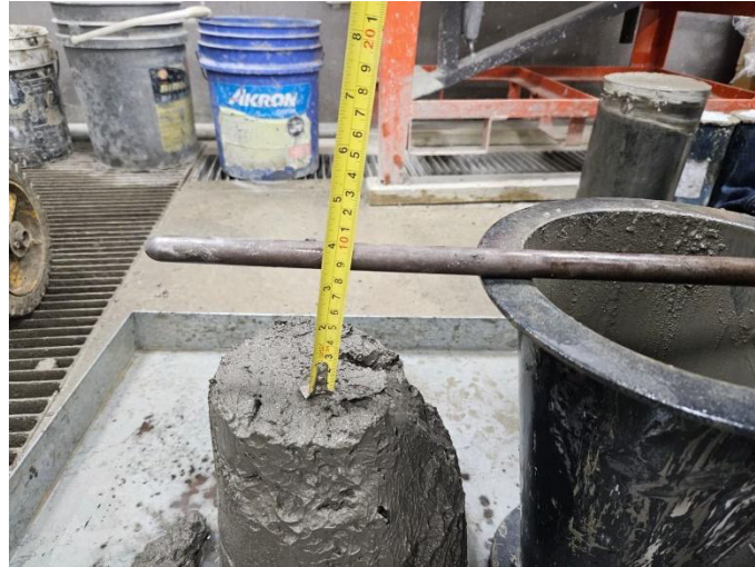
Gráfico 23: Ensayo de Asentamiento
