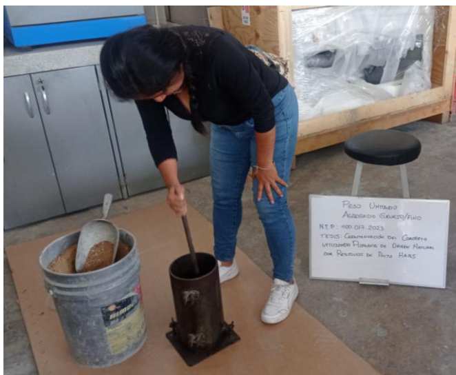
Gráfico 19: Compactado de Agregado fino
