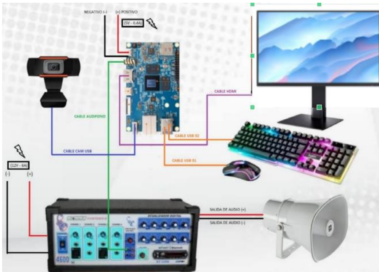
Figura 3. Gráfico de conexión de Orange PI 5 con altavoces
