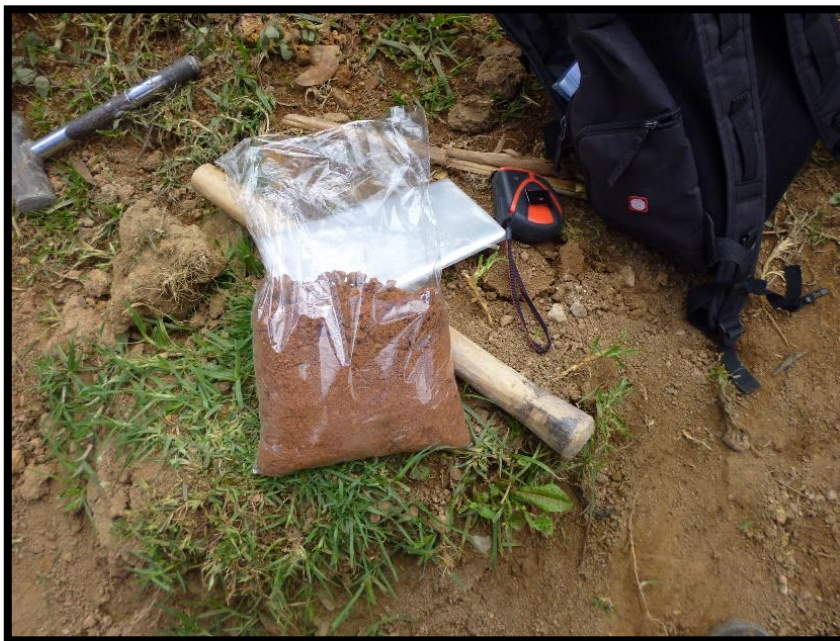
Figura 3. 34. Toma de muestras por estrato en calicatas a cielo abierto
