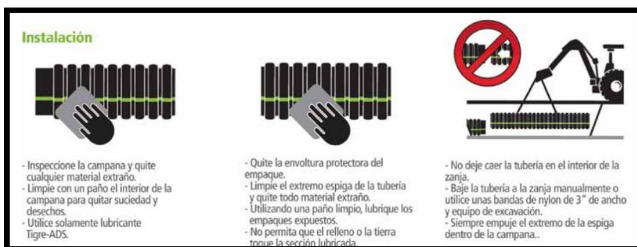
Figura 4. 34. Método de Instalación
