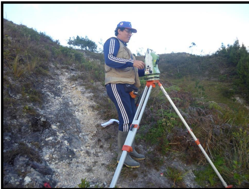
Figura 4. 12. Estación como punto de referencia para el levantamiento
