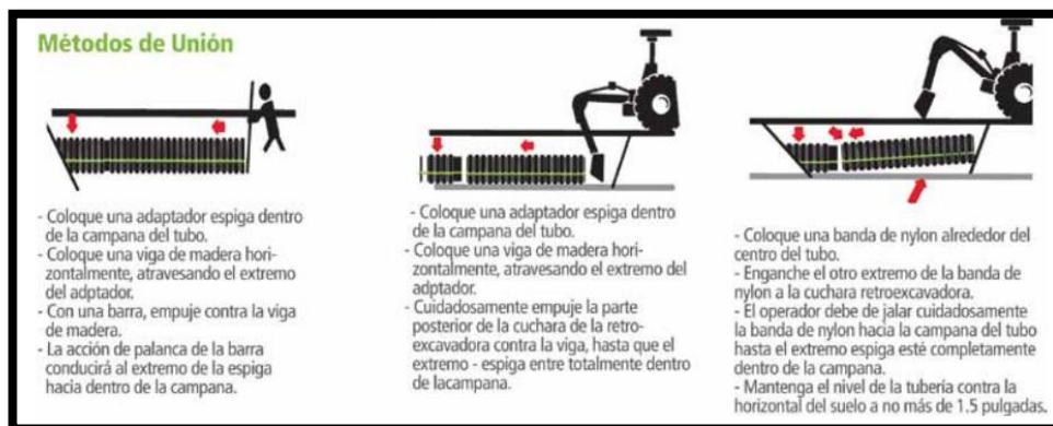
Figura 4. 35. Método de Unión
