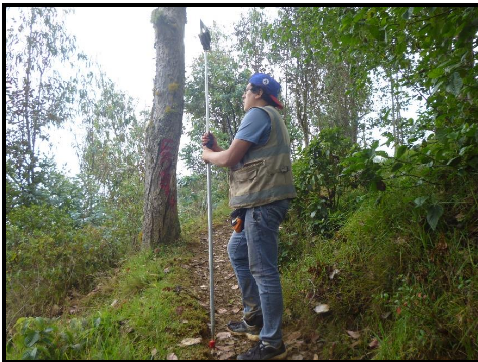
Figura 3. 22. Ubicación del punto de referencia para cambios de estación
