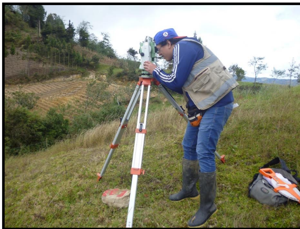
Figura 3. 17. Levantamiento con Estación Total – Trazo definitivo
