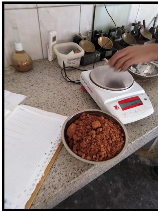
Figura 4. 18. Peso de las muestras para el inicio de los ensayos
