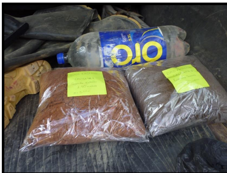
Figura 3. 36. Embalaje de las muestras por estratos de las calicatas
