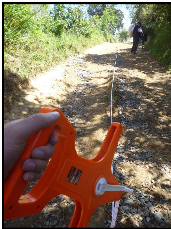
Figura 3. 20. Medición para ubicar los BM cada 500 m
