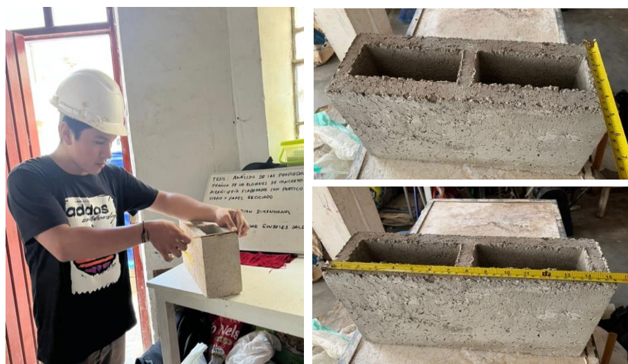
Figura 9. Ensayo de Variación Dimensional
