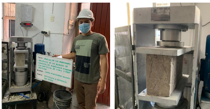
Figura 12. Ensayo de Resistencia a Compresión Simple f'm
