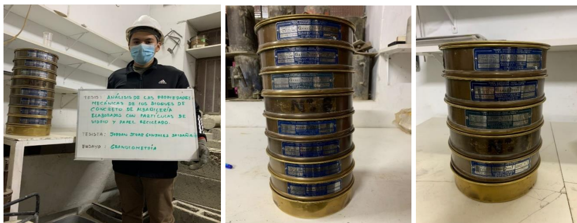
Figura 3. Análisis Granulométrico de agregados
