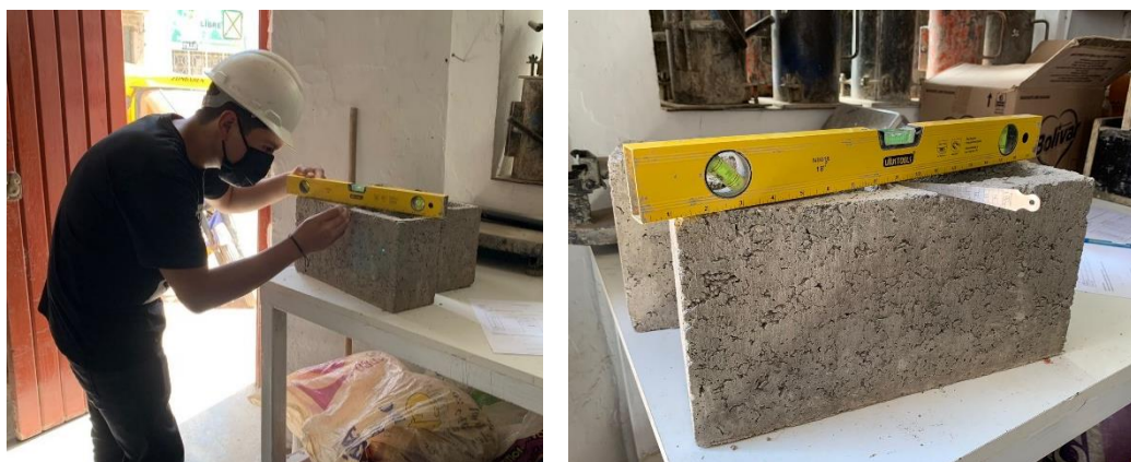
Figura 11. Ensayo de Alabeo
