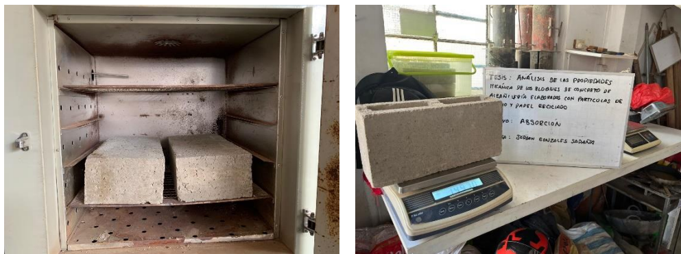
Figura 10. Ensayo de Absorción
