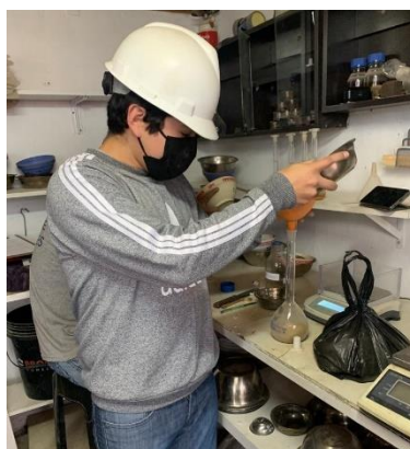
Figura 5. Peso específico y absorción
