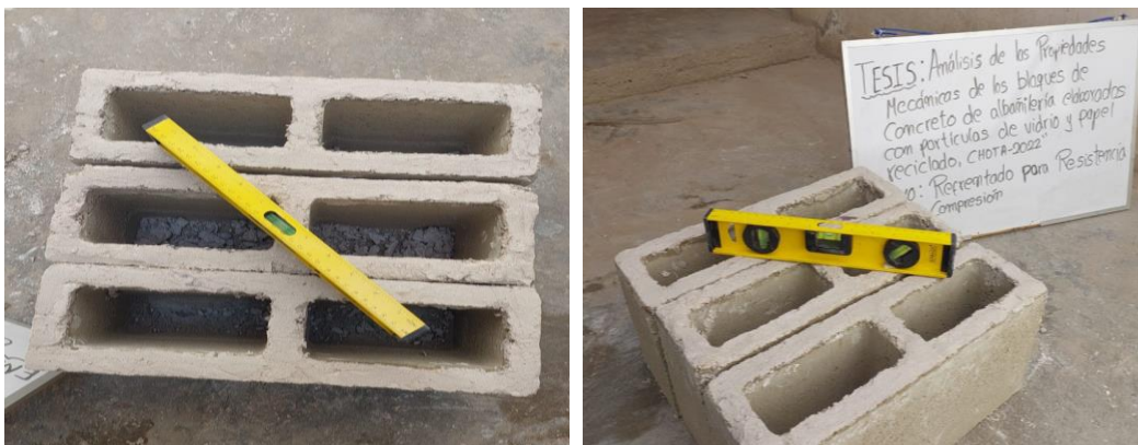
Figura 8. Unidades de albañilería refrentadas 48 horas antes del ensayo a compresión
