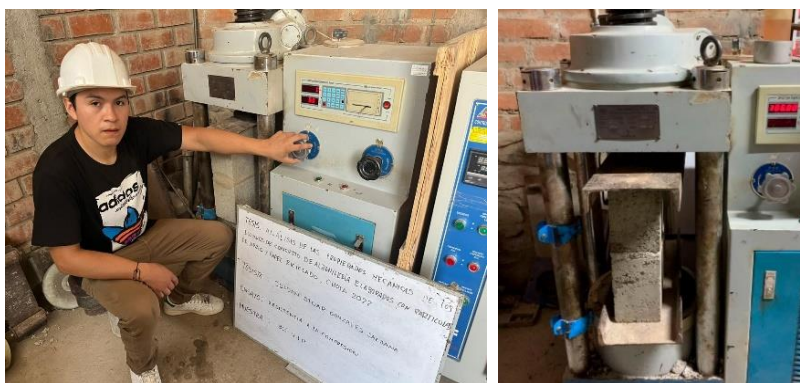
Figura 13. Ensayo de resistencia a compresión axial en Pilas f'm
