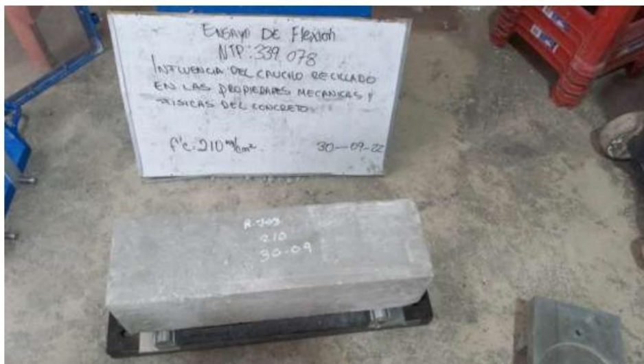
Figura N° 13 Ensayo de flexión de testigos
