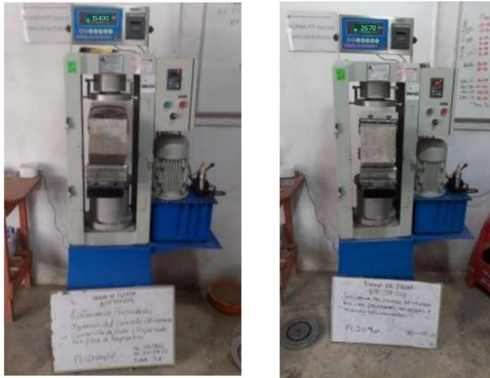
Figura N° 15 Ensayo de módulo de elasticidad de testigos
