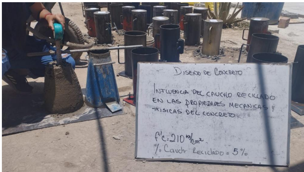
Figura N° 7 Ensayo acerca de la manejabilidad del concreto en estado fresco.
