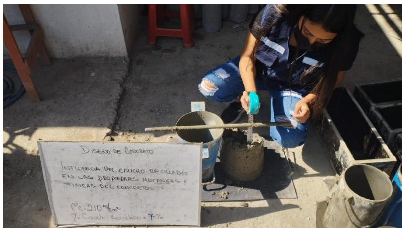
Figura N° 34 Diseño del concreto adicionando 7% del caucho reciclado
