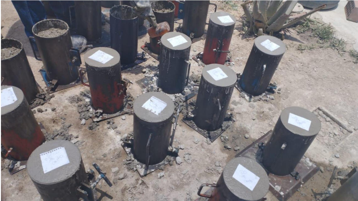
Figura N° 32 Diseño del concreto adicionando 3% del caucho reciclado
