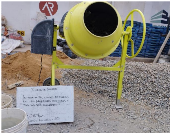
Figura N° 31 Diseño del concreto adicionando 3% del caucho reciclado
