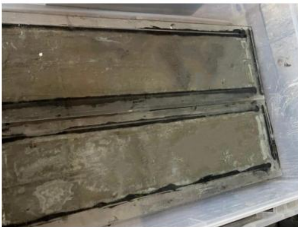
Figura. N° 2 Ensayo de Expansión por Sulfatos: Concreto Patrón
