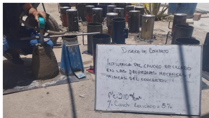
Figura N° 33 Diseño del concreto adicionando 5% del caucho reciclado
