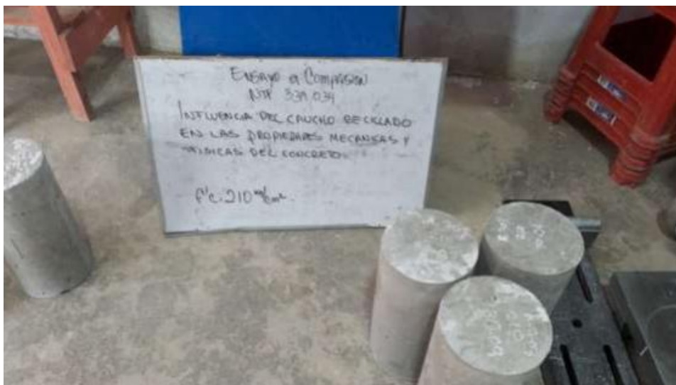
Figura N° 11 Ensayo a la compresión
