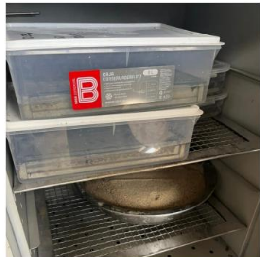
Figura. N° 2 Ensayo de Expansión por Sulfatos: Concreto Patrón
