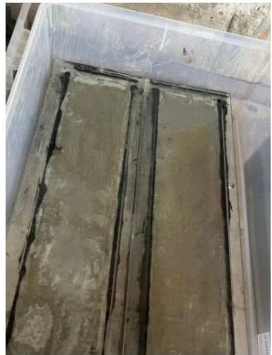
Figura. N° 1 y 2 Ensayo de Expansión por Sulfatos: Concreto Patrón
