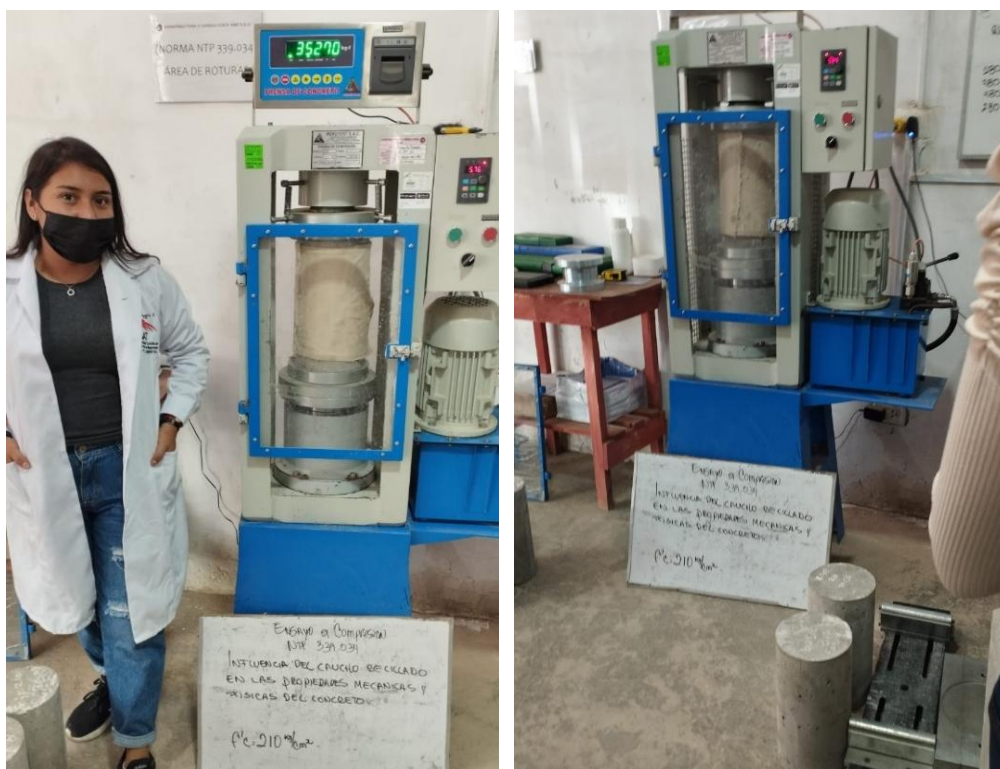
Figura N° 12 Ensayo a compresión de testigos cilíndricos
