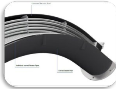
Figura 35: Ensilladuras marca DSI. Fuente: [32]
