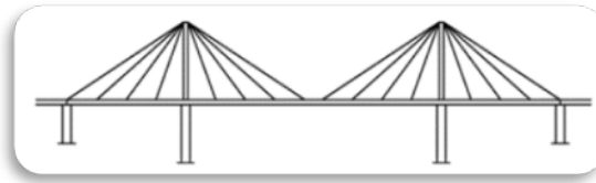
Figura 20: Esquema del sistema de abanico Fuente: [27].
