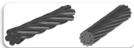
Figura 16: Cordones formados por 7 a más alambres helicoidales. Fuente: [27].
