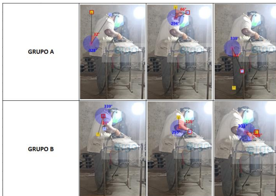
Figura 14A. Postura soldadura de piezas pequeñas
