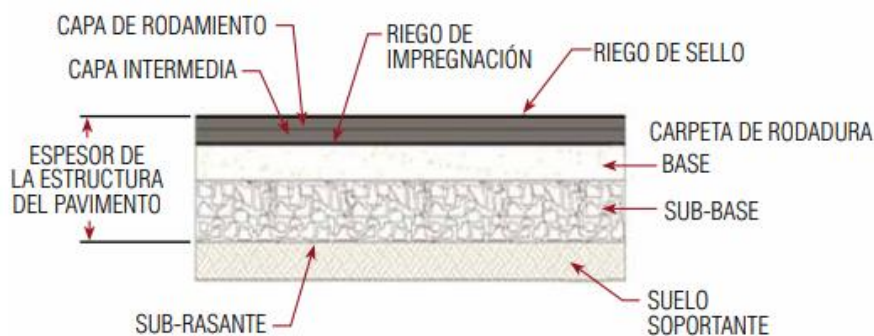
Figura N°07: Corte transversal y Componentes del Pavimento Flexible.
