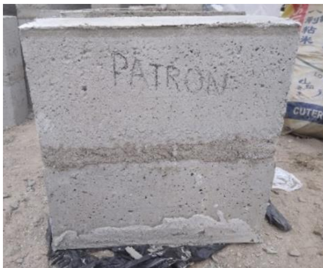
Figura 23. Pila de bloque de concreto refrentada
