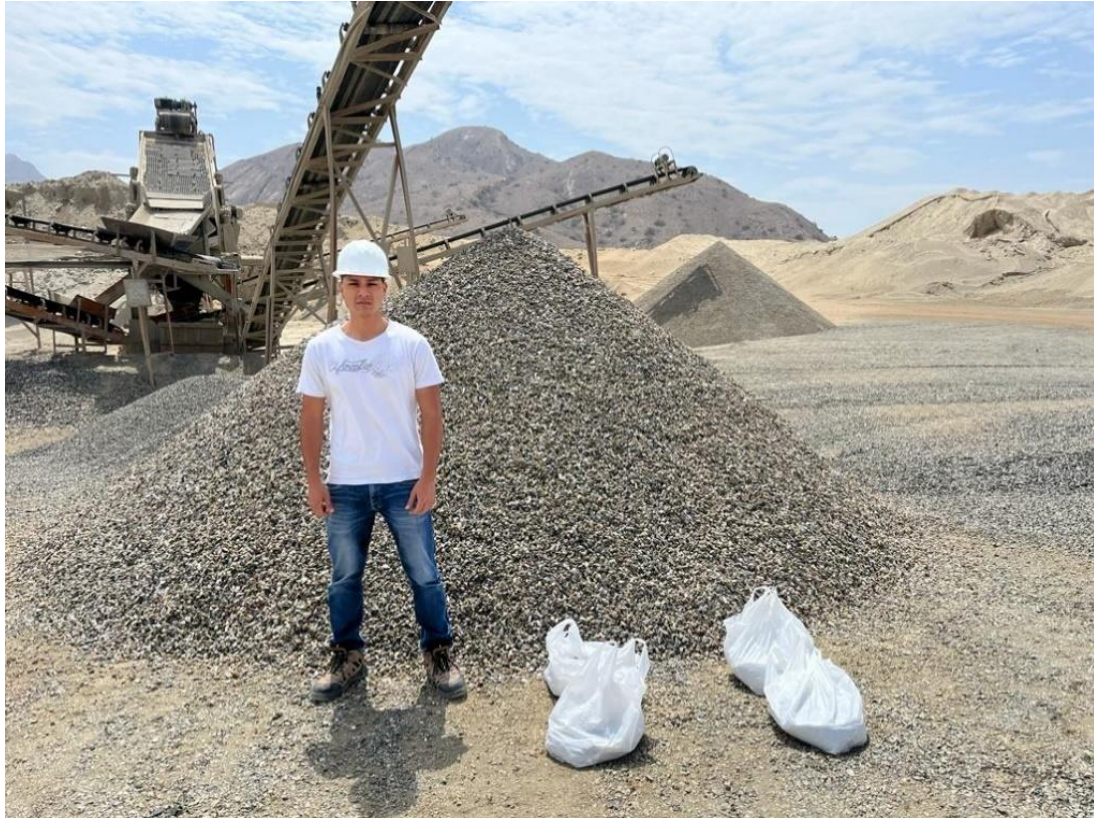
Figura 30. Selección de agregado grueso (chancadora "Piedra Azul").
