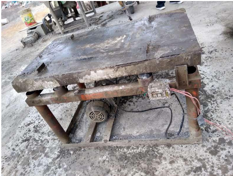
Figura 35. Maquina vibratoria para elaboración de bloques.
