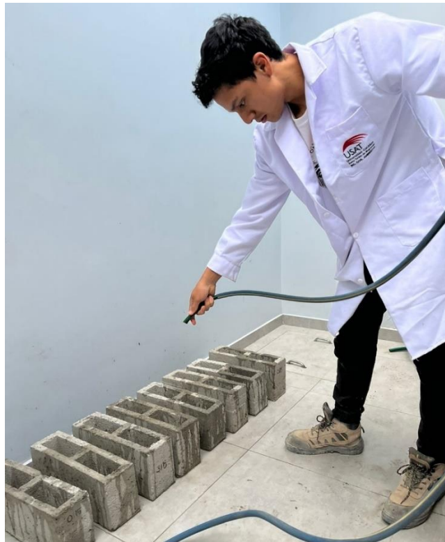
Figura 38. Curado de los bloques de concreto
