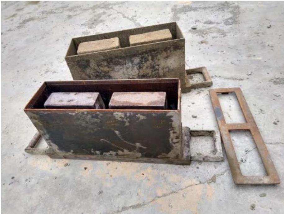
Figura 34. Moldes metálicos para bloques de concreto
