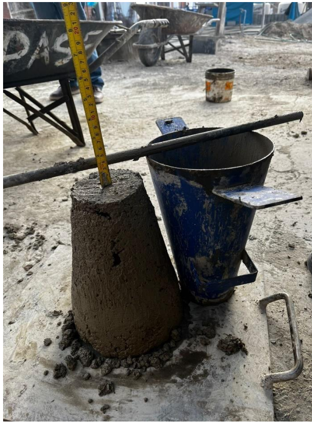
Figura 36. Medición de slump por cono de Abrams
