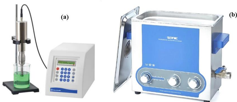
Figura 5. Tipos de Sonicador, (a) por Sonda y (b) por baño de ultrasonidos.
