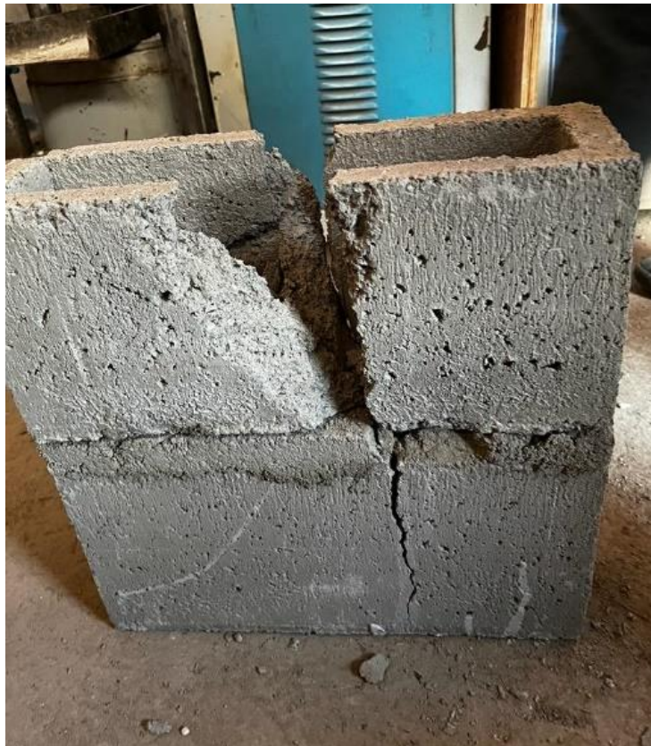
Figura 43. Falla en pilas de bloques de concreto
