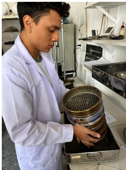
Figura 33. Ensayo granulométrico por tamizado de los agregados
