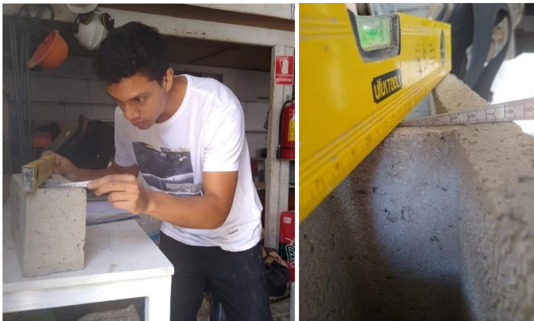
Figura 19. Ensayo de alabeo en bloque de concreto
