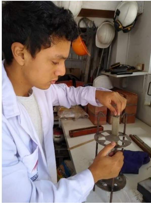
Figura 46. Muestra de ensayo de durabilidad depositada en soporte metálico.
