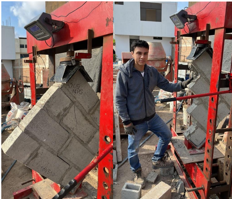
Figura 45. Fallas en muretes de bloques de concreto
