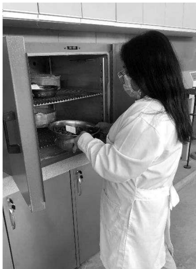
Figura N° 10: Colocado de muestra de Agregado grueso en el horno
