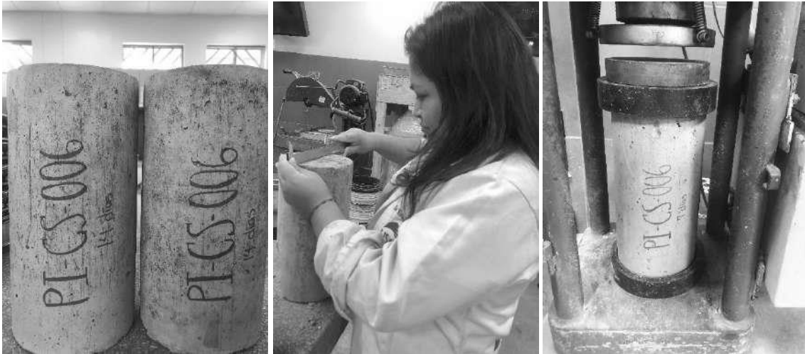
Figura N° 32: Procedimiento de rotura para conocer la resistencia a compresión
