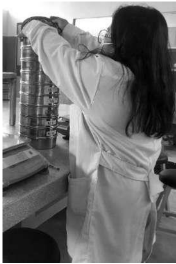
Figura N° 12: Tamizado del Agregado grueso
