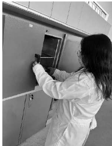
Figura N° 9: Colocado de muestra del Ag. fino en el horno
