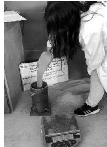
Figura N° 24: Llenado del molde con el material hasta desbordar el recipiente
