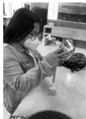
Figura N° 15: Colocación del Ag. Fino en la fiola con ayuda de embudo
