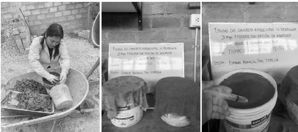
Figura N° 29: Rellenado y tamizado de la muestra para iniciar el ensayo de tiempo de fraguado
