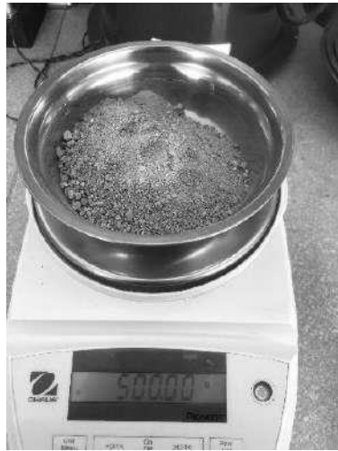
Figura N° 14: Peso de la muestra del Ag. fino
