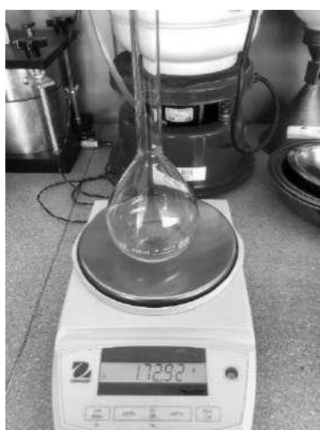
Figura N° 16: Peso de la fiola para ensayo de peso específico y absorción
