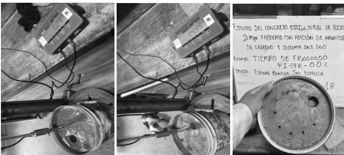
Figura N° 30: Inicio de la penetración de agujas en el concreto
