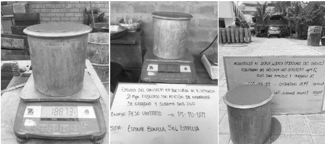
Figura N° 28: Peso del recipiente más el concreto
