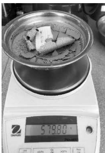
Figura N° 20: Peso de la muestra secada en horno + recipiente
