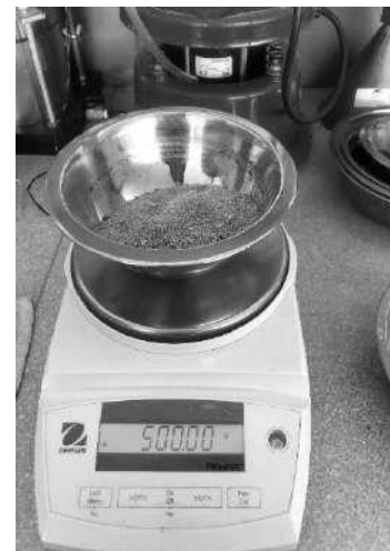
Figura N° 8: Peso de la muestra para análisis granulométrico
