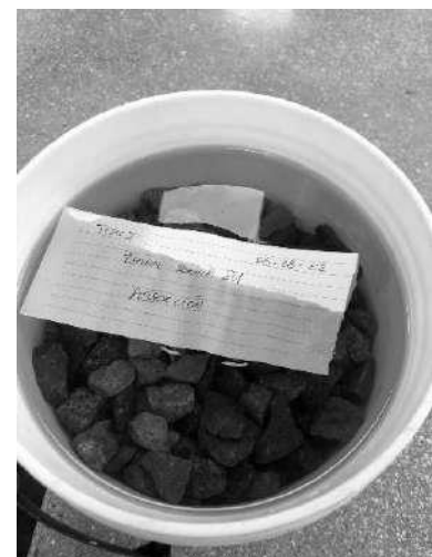
Figura N° 22: Agregado grueso sumergido 24 hrs en agua
