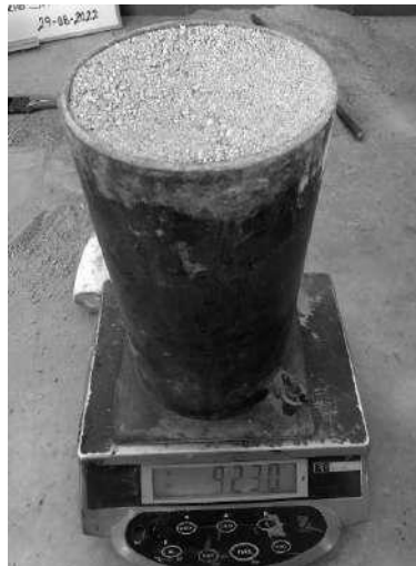
Figura N° 26: Peso de la muestra apisonada + recipiente
