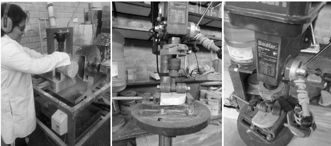
Figura N° 38: Cortado de probetas y ensayo de discos en la máquina de desgaste
