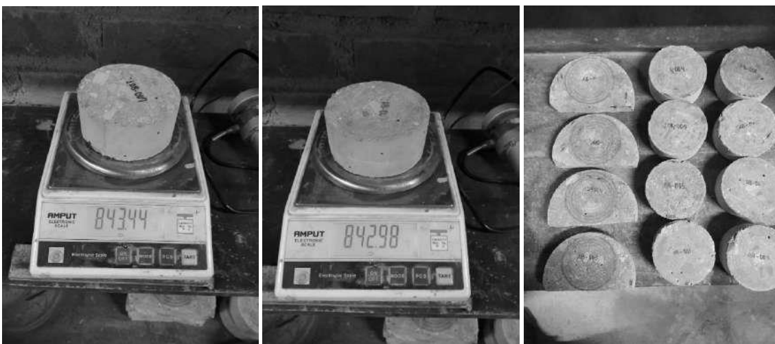
Figura N° 39: Peso de masa inicial y final de los discos después de cada ciclo
