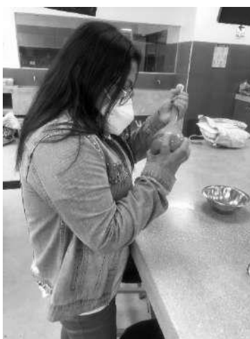
Figura N° 19: Remover la fiola para eliminar el contenido de aire
