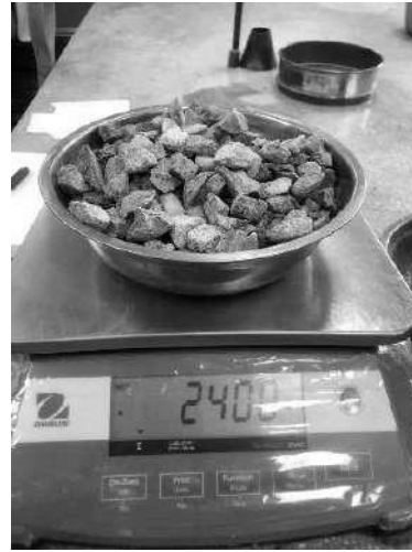
Figura N° 13: Peso de la muestra de Ag. grueso
