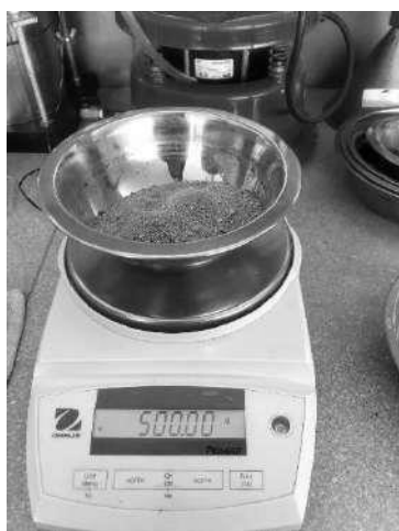
Figura N° 17: Peso del Ag. fino para ensayo de peso específico y absorción
