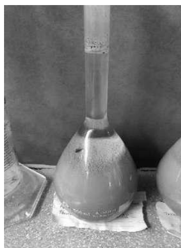
Figura N° 18: Reposo del Ag. fino en la fiola por 24 hrs
