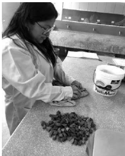
Figura N° 23: Acomodo de la muestra después de ser retirada del agua
