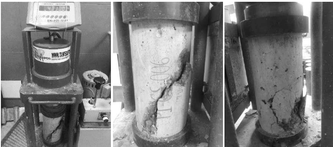
Figura N° 33: Rotura y tipo de falla del ensayo a compresión
