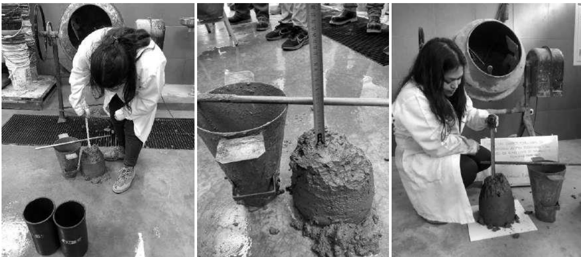
Figura N° 27: Medición del asentamiento del concreto (SLUMP)
