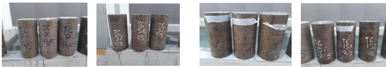
Figura 29 Probetas 12 de f'c 50kg/cm 2 –0%, 5%, 10% y 15% de adición
