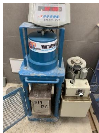
Figura 69 Bloque de concreto sometida a resistencia a la compresión, resistencia a los 28 días
