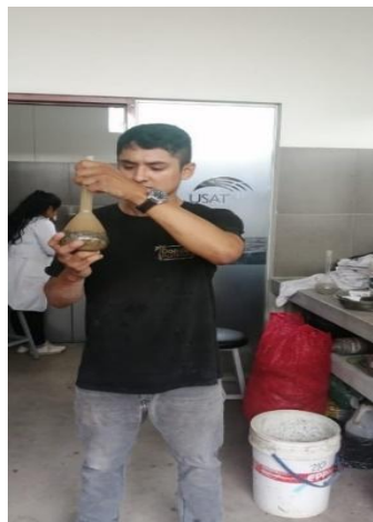
Figura 10 Purificación de oxígeno dentro de la fiola que lleva la arena gruesa y piedra triturada
