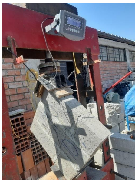
Figura 90 Murete de concreto, con 10% de adición.
