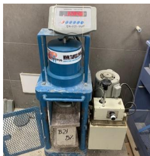
Figura 65 Bloque de concreto sometida a resistencia a la compresión
