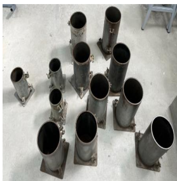
Figura 19 Moldes cilíndricos de dimensiones
