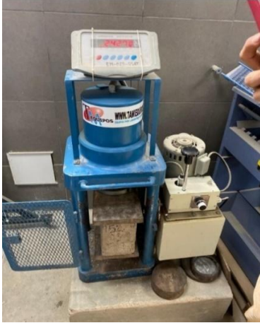
Figura 70 Bloque de concreto sometida a resistencia a la compresión
