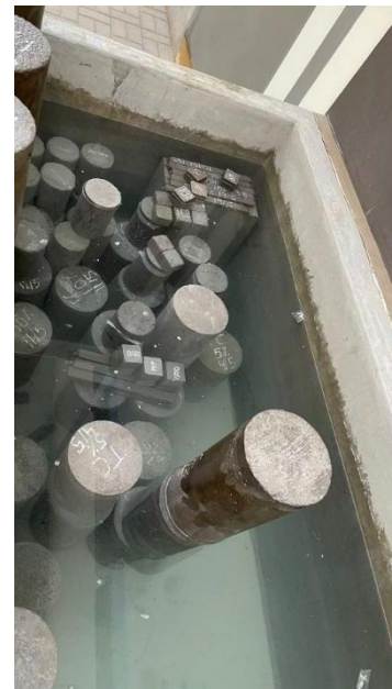
Figura 21 Muestras cilíndricas de 15x30cm , para ensayo de resistencia a la compresión
