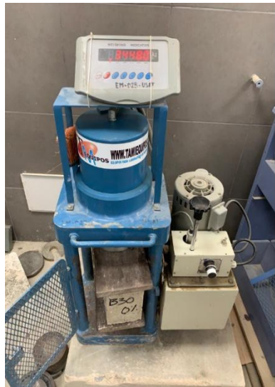
Figura 59 Bloque de concreto sometida a resistencia a la compresión
