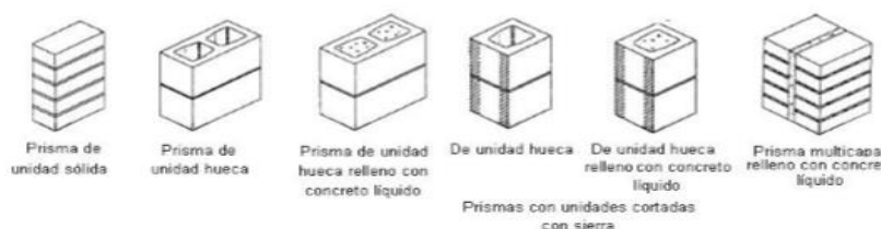
Figura 2 Pilas con los bloques de concreto
