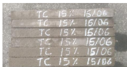
Figura 43 Viguetas listas para ser sometidas a soluciones sulfatadas
