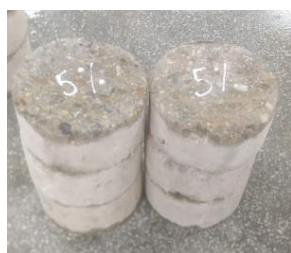
Figura 32 Discos para ensayo de succión
