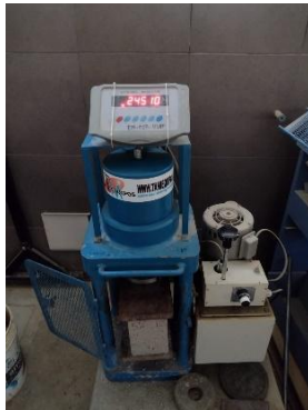
Figura 63 Bloque de concreto sometida a resistencia a la compresión
