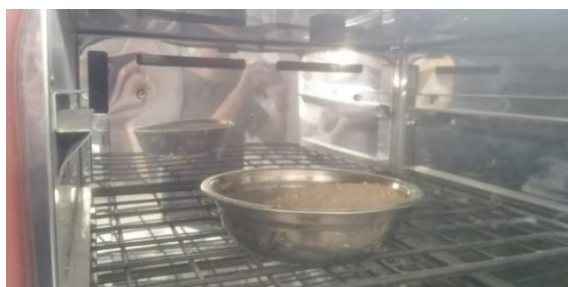
Figura 9 Colocación al horno de la muestra de agregado fino
