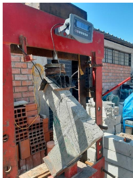
Figura 91 Murete de concreto, con 15% de adición.
