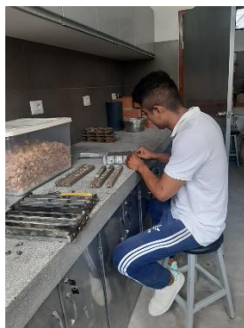
Figura 39 Vaciado de viguetas en laboratorio
