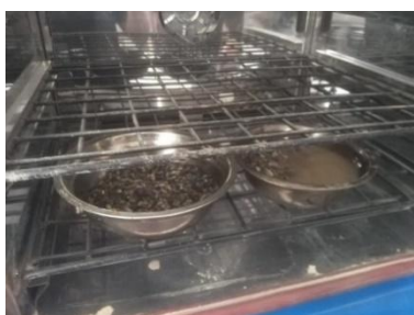
Figura 9 Colocación al horno de la muestra de agregado fino
