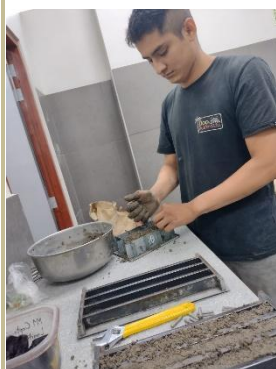
Figura 39 Vaciado de viguetas en laboratorio
