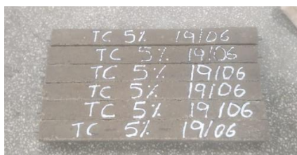
Figura 43 Viguetas listas para ser sometidas a soluciones sulfatadas
