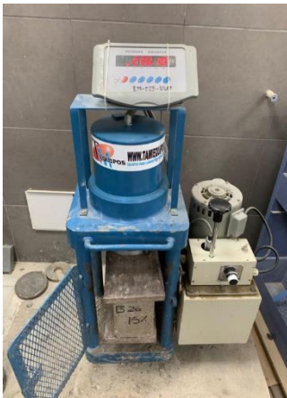
Figura 72 Bloque de concreto sometida a resistencia a la compresión
