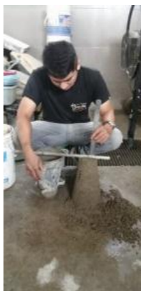
Figura 20 Prueba de Slump
