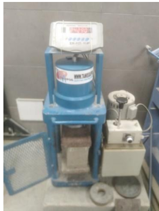
Figura 68 Bloque de concreto sometida a resistencia a la compresión, resistencia a los 14 días
