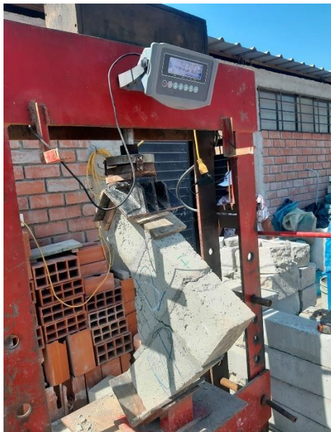
Figura 88 Murete de concreto , con 0% de adición.
