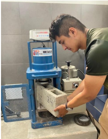
Figura 55 Bloque de concreto sometida a resistencia a la
