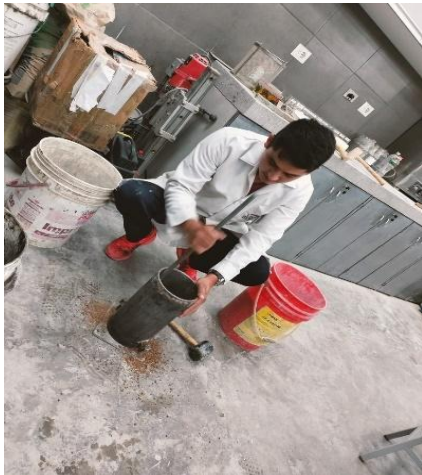
Figura 12 Ensayo de peso unitario seco compactado de arena gruesa
