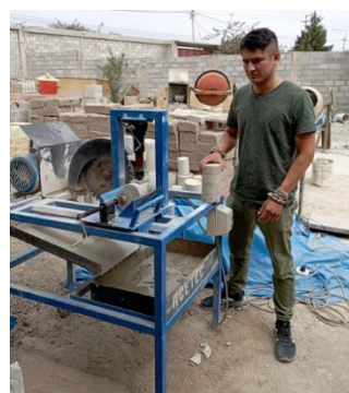
Figura 31 Corte individual de probetas cilíndricas de 10x20cm
