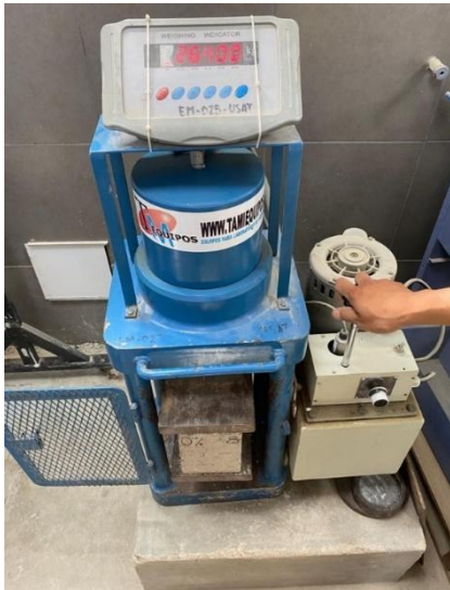
Figura 57 Bloque de concreto sometida a resistencia a la compresión
