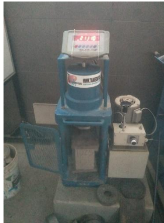
Figura 67 Bloque de concreto sometida a resistencia a la compresión, resistencia a los 7 días
