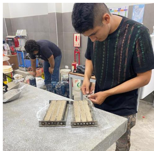
Figura 40 Desencofrado Fuente: Elaboración Propia
