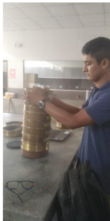
Figura 7 Tamizado de arena
