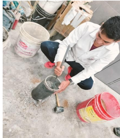
Figura 11 Ensayo de peso unitario seco compactado de piedra triturada
