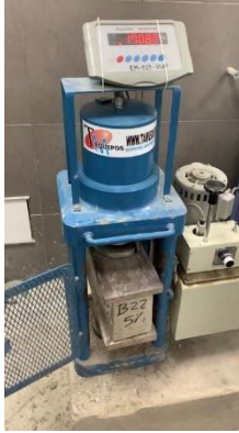
Figura 61 Bloque de concreto sometida a resistencia a la compresión
