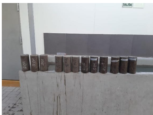
Figura 23 Muestras cilíndricas de 10x20cm , para ensayo de succión cápillar
