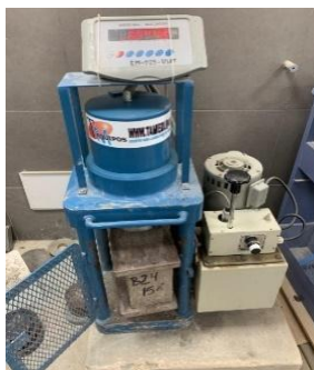
Figura 74 Bloque de concreto sometida a resistencia a la compresión
