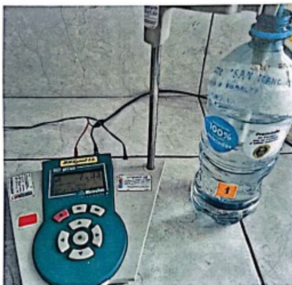
Figura 1. Medición del pH de la muestra Sector San Francisco - Carretera a Pomalca - Pozo tubular (1), en el equipo Metrohm 827 pH lab.
