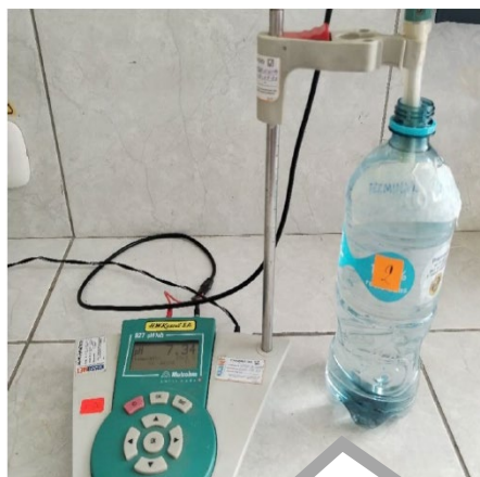
Medición del pH de la muestra Terminal Gacela Pozo, en el equipo Metrohm 827.
