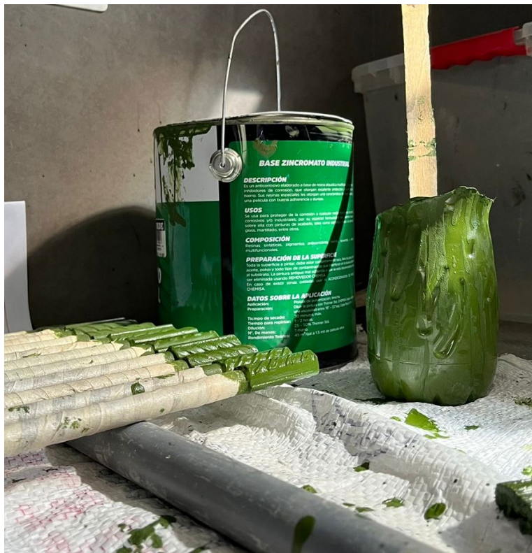
Fotografía 3 Aceros con recubrimiento de pintura en base zincromato industrial
