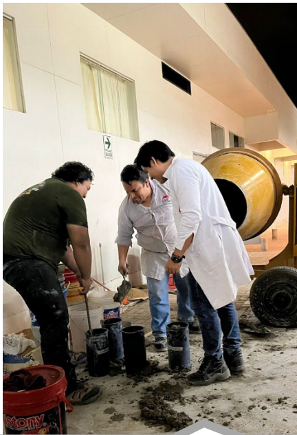
Vaciado de la mezcla en moldes de 15x30cm
