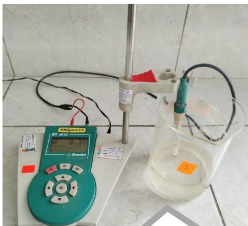
Medición del pH de la muestra Calicata Pimentel - I, en el equipo Metrohm 827 pH
