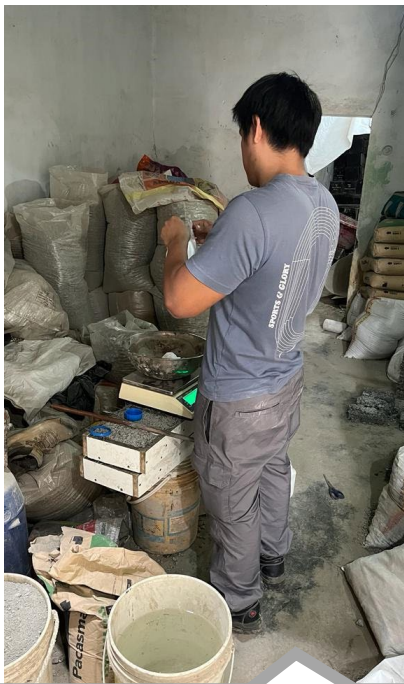
Elaboración de probetas con NaCl en su diseño de mezcla
