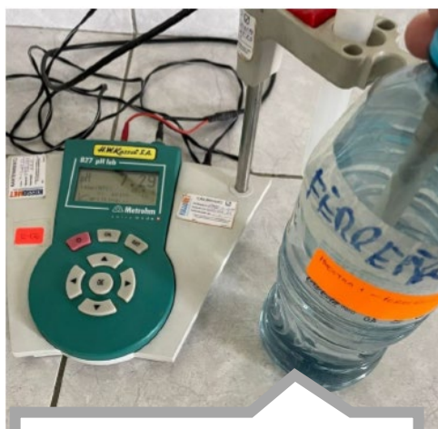
Medición del pH de la muestra Ferreñafe, en el equipo Metrohm 827 pH.
