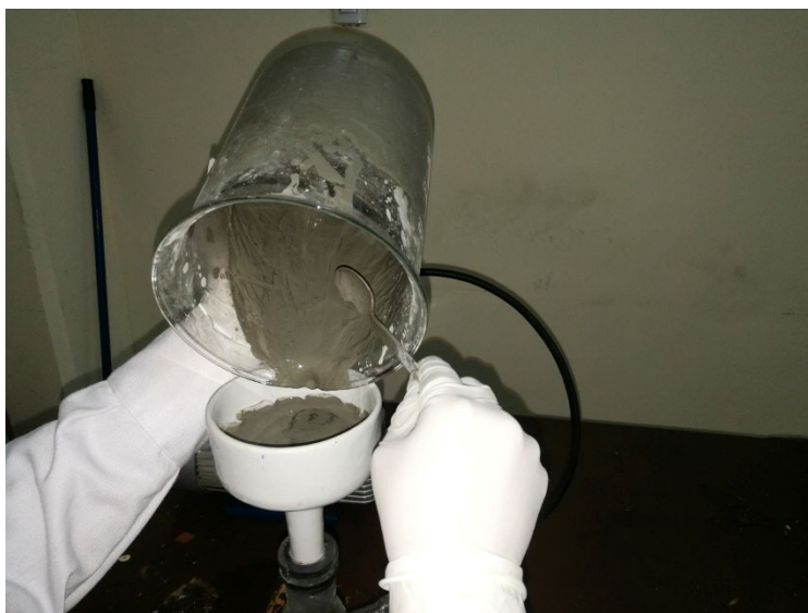
Fotografía 10. Mezcla de relación a/c de 0.5 ingresando al matraz
