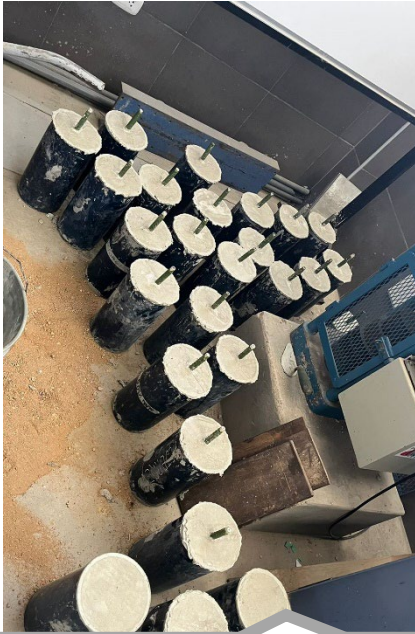
Probetas listas con acero incrustado en el centro
