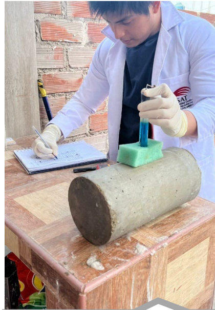
Medición de potencial de probetas
