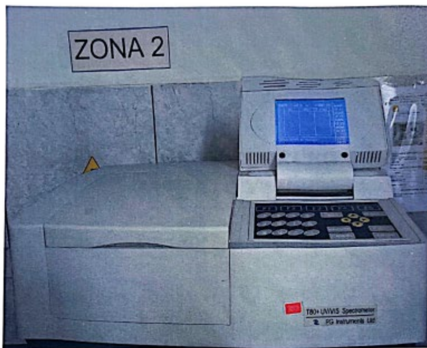
Figura 5. Medición de la absorbancia en el espectrofotómetro UV-V T80+, PG Instruments Ltd.
