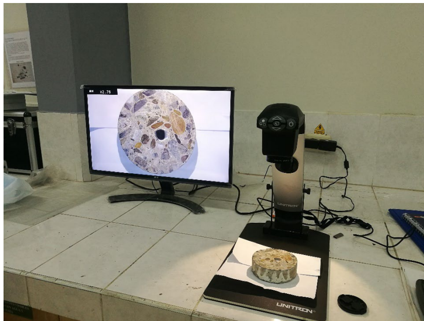
Fotografía 17. Concreto con acero ASTM A615, corte transversal con aumento x2.76
