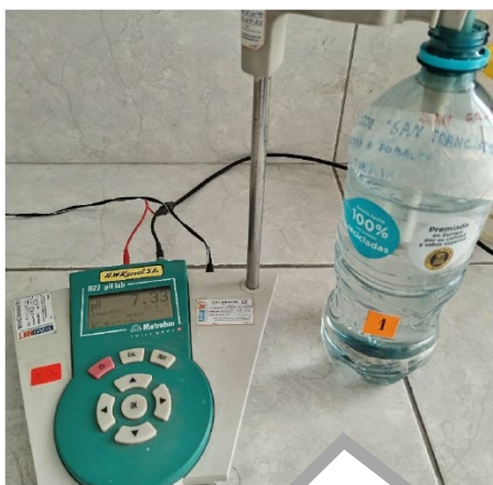
Medición del pH de la muestra Sector San Francisco-Carretera a Pomalca en el equipo Metrohm 827
