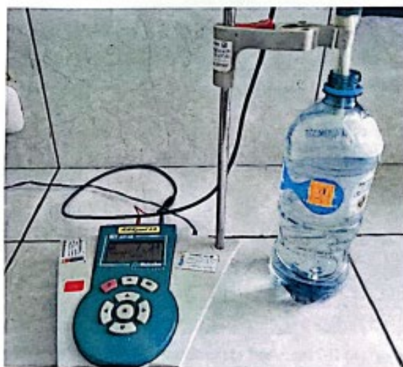
Figura 2. Medición del pH de la muestra Terminal Gacelo Pozo (2), en el equipo Metrohm 827 pH lab.
