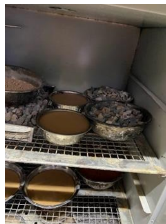
Ilustración 16: Secado de muestra al horno
