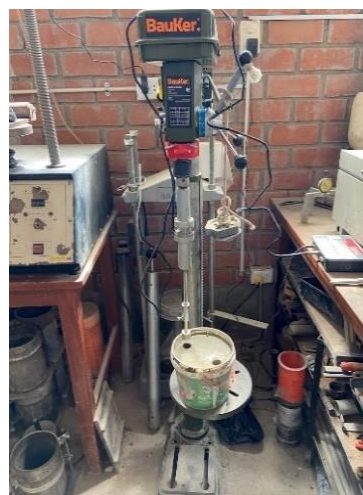
Ilustración 28: Concreto en el penetrómetro
