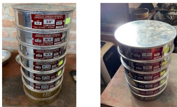
Ilustración 8: Tamices para granulometría de agregado fino (arena) y grueso (piedra chancada)
