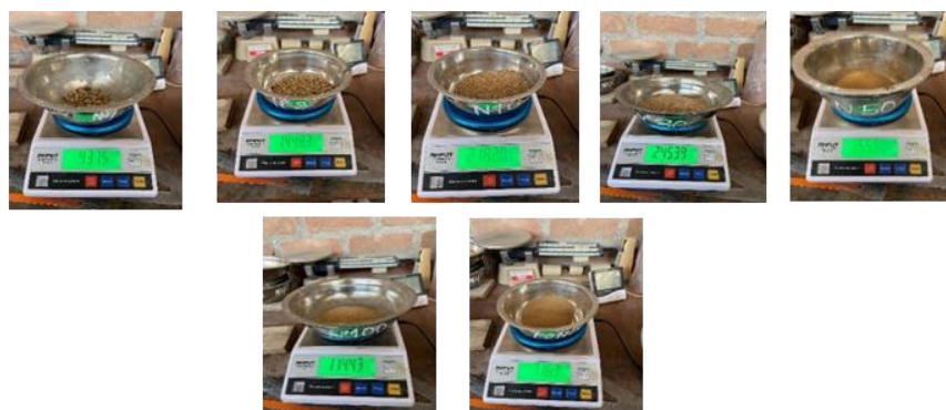
Ilustración 10: Pesos retenidos de agregado fino en cada tamiz
