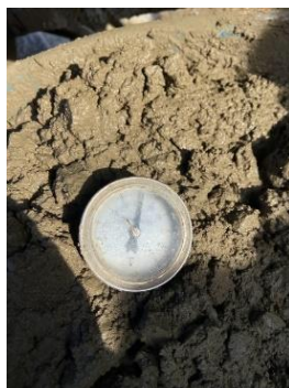
Ilustración 24: Medición de la temperatura de la mezcla del concreto en estado fresco
