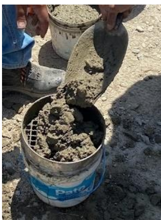
Ilustración 25: Tamizado del concreto fresco con malla N°4
