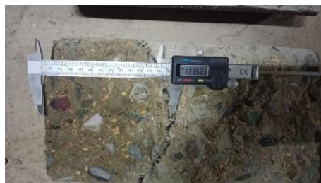
Ilustración 42: Medición de la penetración del agua
