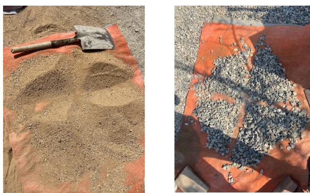
Ilustración 6: Procedimiento de cuarteo de agregados
