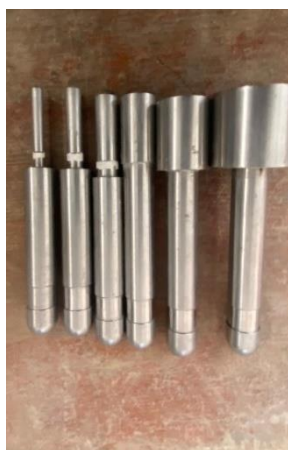
Ilustración 27: Agujas de penetración normalizadas
