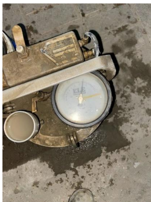
Ilustración 21: Determinación del contenido de aire mediante el empleo de la olla de Washington
