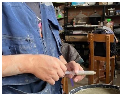
Ilustración 23: Adsorción de agua de exudación
