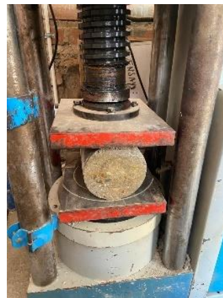
Ilustración 41: Ensayo diametral de probeta
