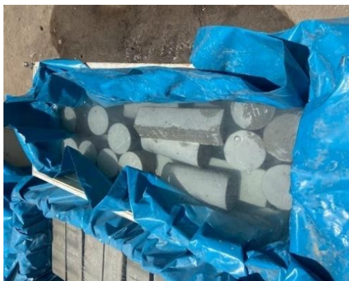
Ilustración 31: Fase de curado del concreto patrón
