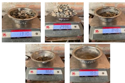
Ilustración 9: Tamices para granulometría de agregado fino (arena) y grueso (piedra chancada)
