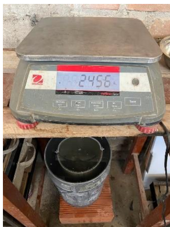
Ilustración 15: Pesaje del agregado estando sumergido
