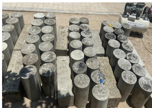
Ilustración 30: Desmolde de probetas y vigas
