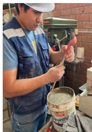
Ilustración 26: Absorción del agua de exudación
