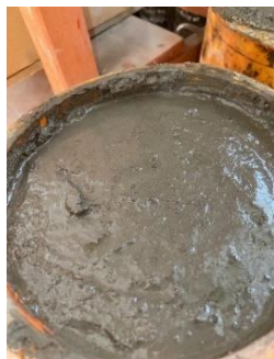
Ilustración 22: Agua de exudación del concreto fresco
