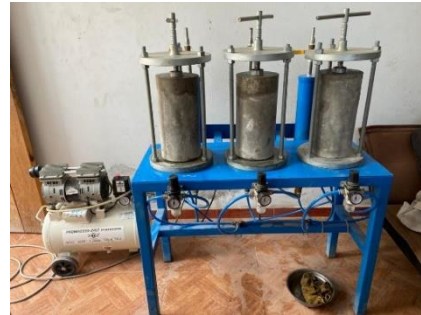
Ilustración 39: Emplazamiento de probetas en la máquina de ensayo
