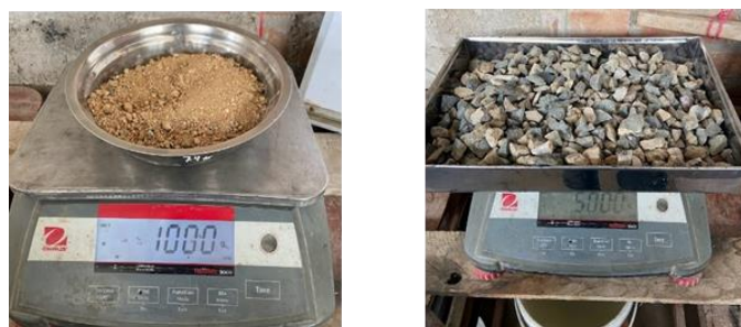
Ilustración 7: Muestra de agregado fino y grueso
