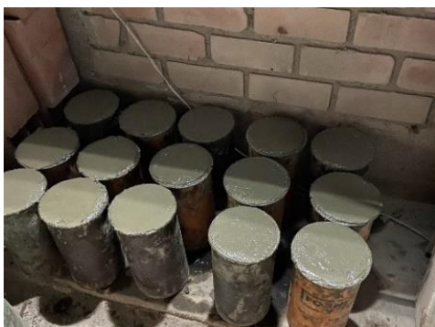
Ilustración 31: Fase de curado del concreto patrón
