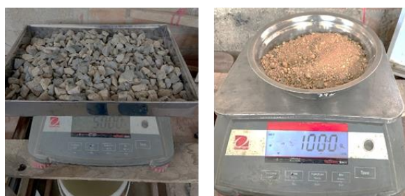
Ilustración 11: Muestras de agregados pesadas para ingresar al horno
