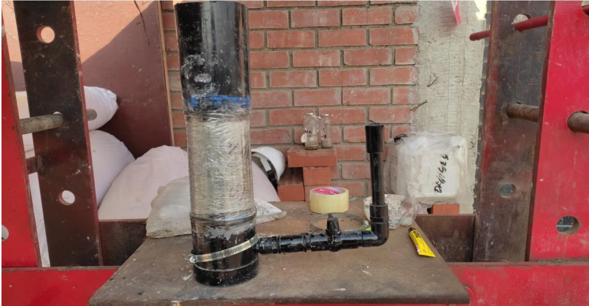
Figura 35: Muestra de concreto en ensayo de permeabilidad
