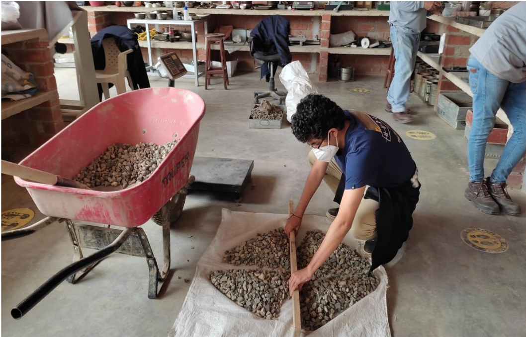
Figura 11: Selección de muestra para granulometría
