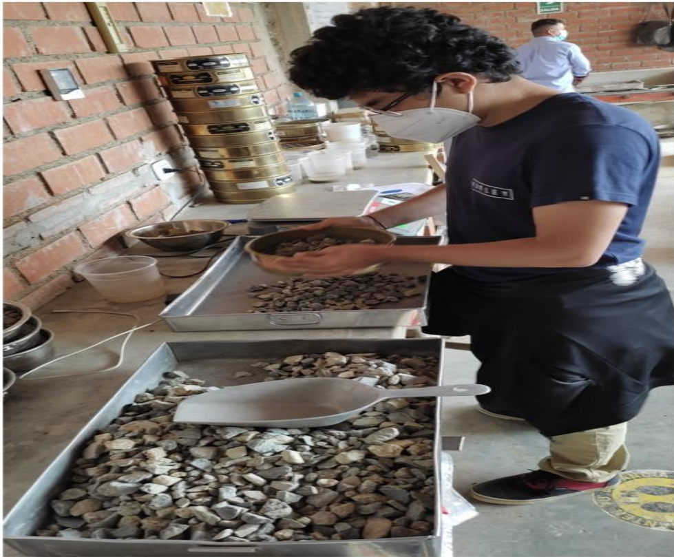
Figura 12: Proceso de zarandeo o tamizado
