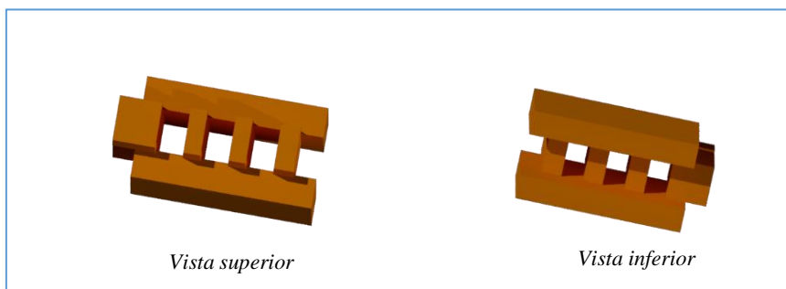
Figura 9-A: Perspectivas del ladrillo en 3D (vista superior y vista inferior)
