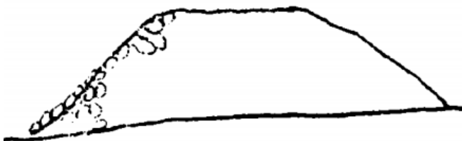
Figura 2. Sitio de disposición final en terraplén
