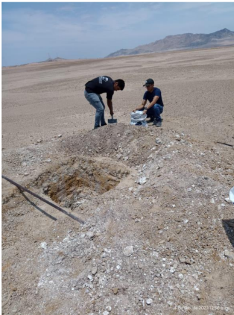
Anexo 1.15. Toma de muestra alterada para ensayos en laboratorio.
