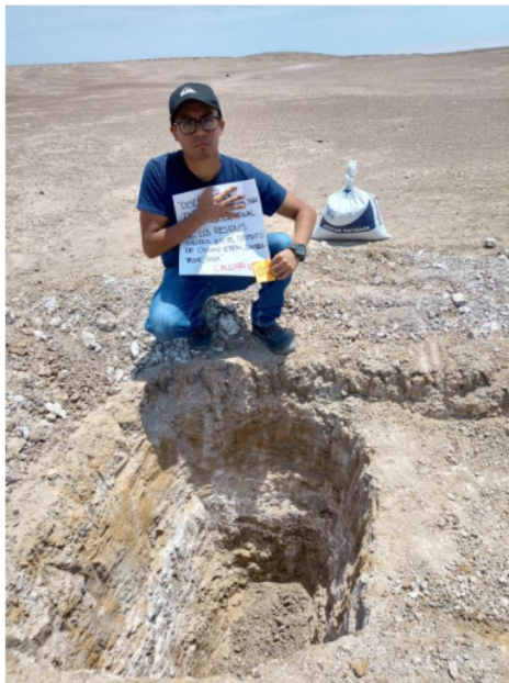
Anexo 1.15. Toma de muestra alterada para ensayos en laboratorio.
