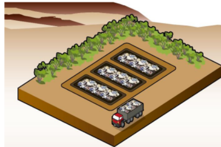
1 Ilustración 4. Método de trinchera o zanja.
